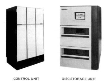
UNIVAC 8424/8440 Disc Subsystem
