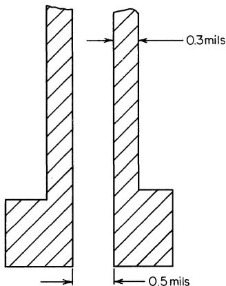
Fig. 3.9. p-diffusion width and spacing of p diffusions.
