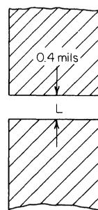
Fig. 3.6. Source-to-drain spacing (channel length  $L$ ).
