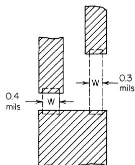
Fig. 3.7. Gate width (channel width  $W$ ).
