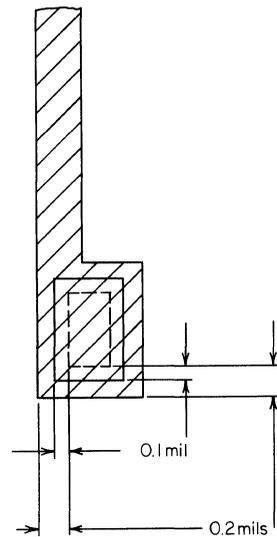
**Fig. 3.11.** p<sup>+</sup> margin around contact.
