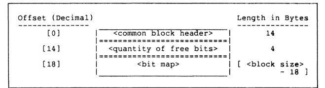
Figure B-7. Header for DP2 Bit-Map Block
