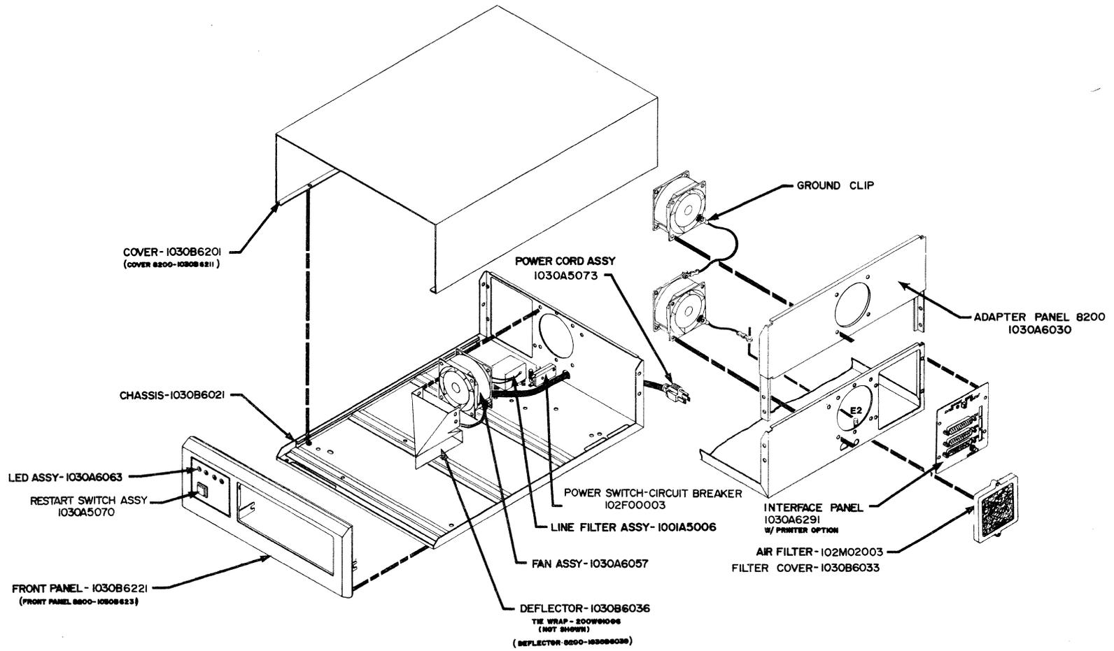
FIGURE #3-1 ENCLOSURE COMPONENTS
