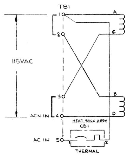
PRIMARY WINDING WIRED FOR 115VAC OPERATION. FOR 230VAC OPERATION REMOVE JUMPERS FROM TBI-1,2,3,4 AND ADD JUMPER FROM TBI-2 TO TBI-3
