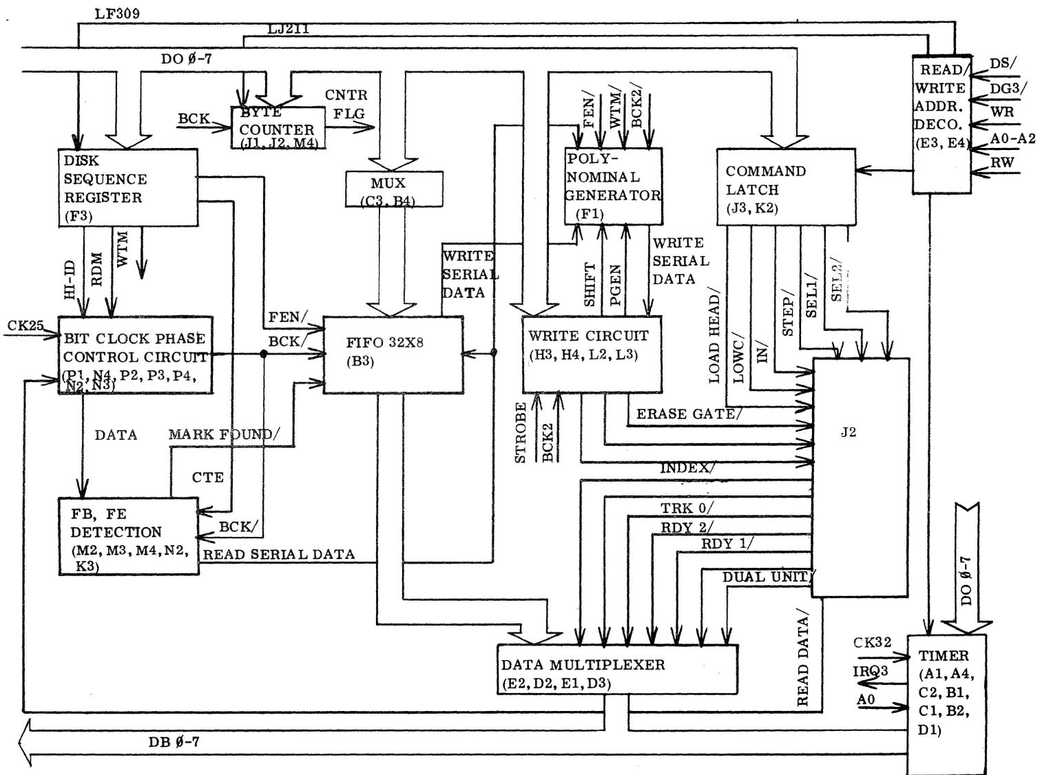
BLOCK DIAGRAM OF THE DISK CONTROLLER BOARD
