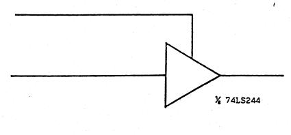
FIGURE 12 : TRI-STATE OUTPUT DRIVER
