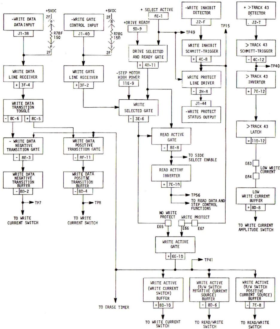
FIGURE 6-6. WRITE DATA CONTROL FUNCTION
