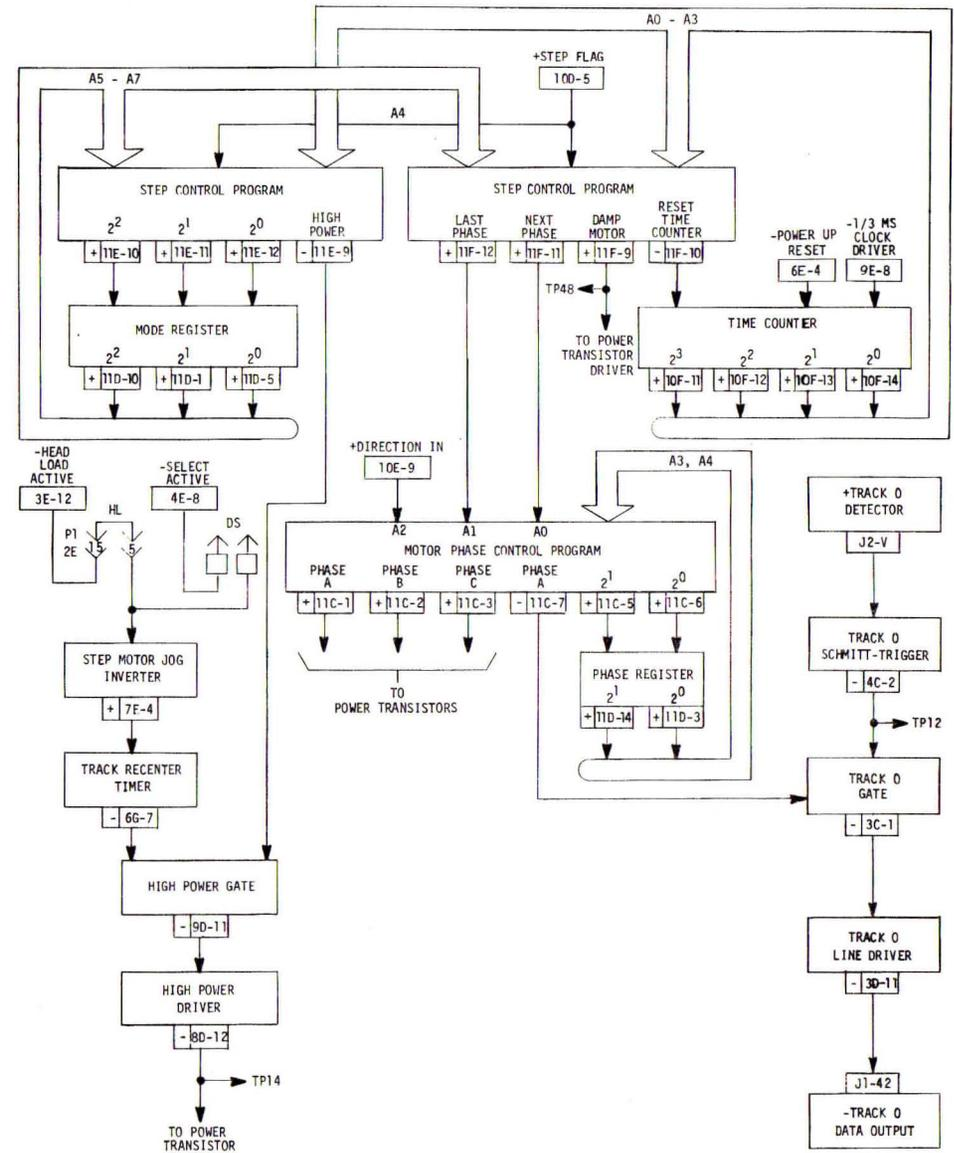
FIGURE 6-5. STEP MOTOR CONTROLLER
