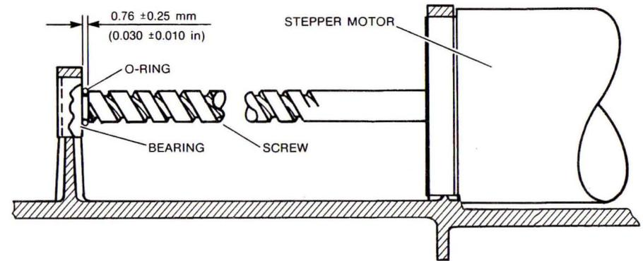
FIGURE 4-14. BEARING/SHOULDER CLEARANCE
