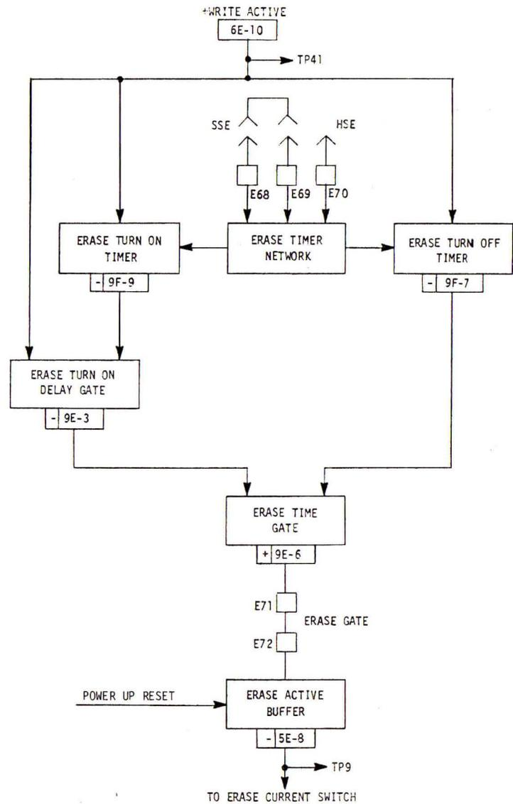
FIGURE 6-7. ERASE DELAY FUNCTION
