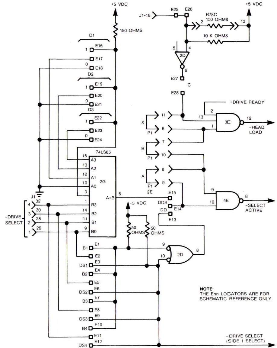
FIGURE 3-10. DRIVE SELECTION (ENCODED) CIRCUITRY
