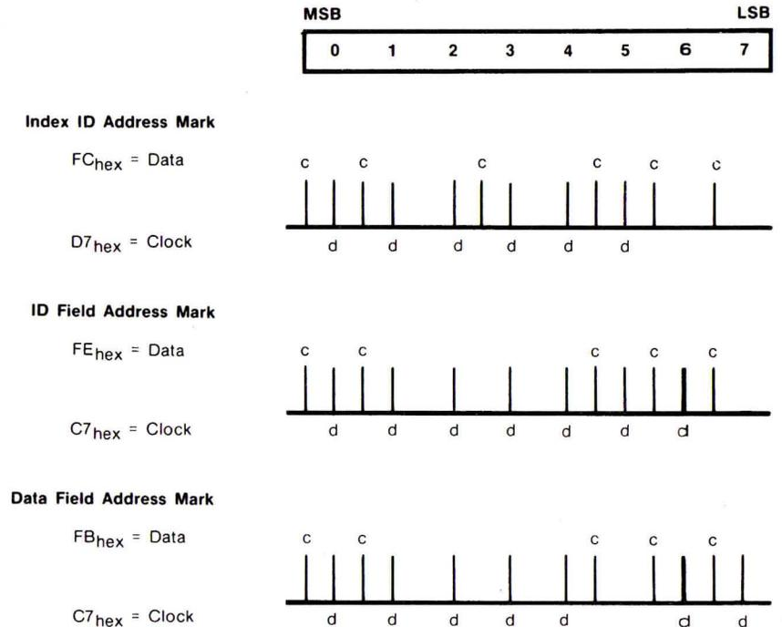
**FIGURE 5-6. SINGLE-HEAD UNIQUE ADDRESS MARKS**
