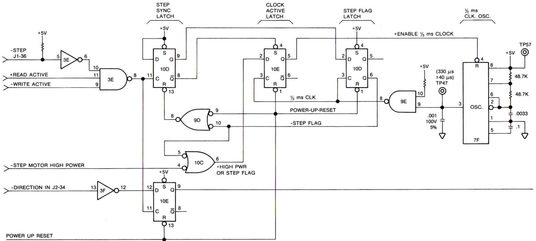
FIGURE 2-4. STEPPER MOTOR CIRCUITRY
