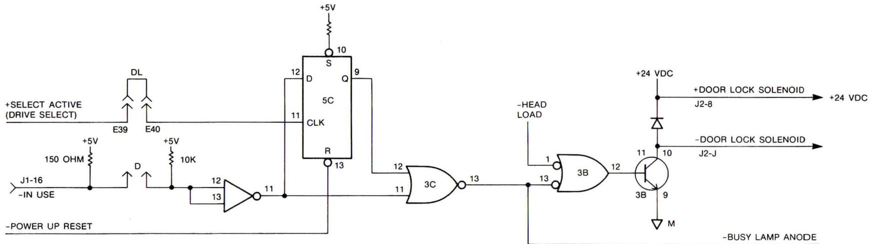
FIGURE 3-15. DOOR LOCK CIRCUIT
