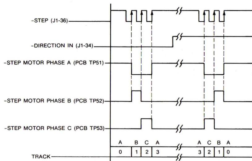
**FIGURE 2-3. STEPPER MOTOR PHASE SEQUENCE**
