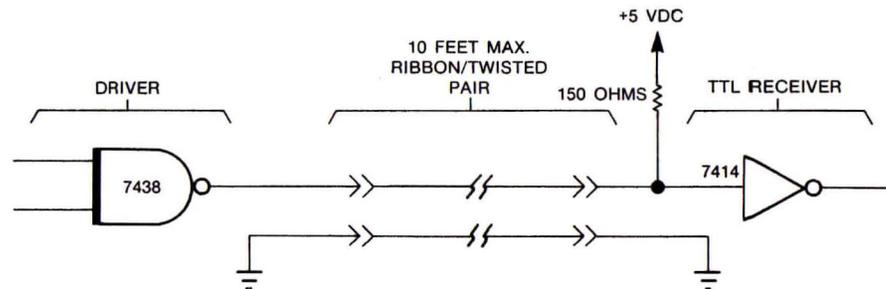
FIGURE 3-2. I/O LINE DRIVER/RECEIVER
