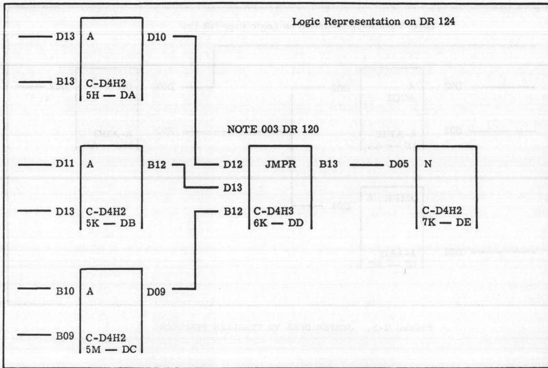
FIGURE 2-7. SELECTING A CIRCUIT WITH JUMPER
