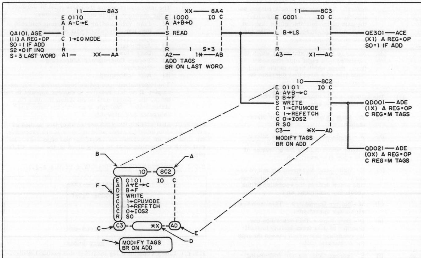
FIGURE 5-1. CAS LOGIC DIAGRAM
