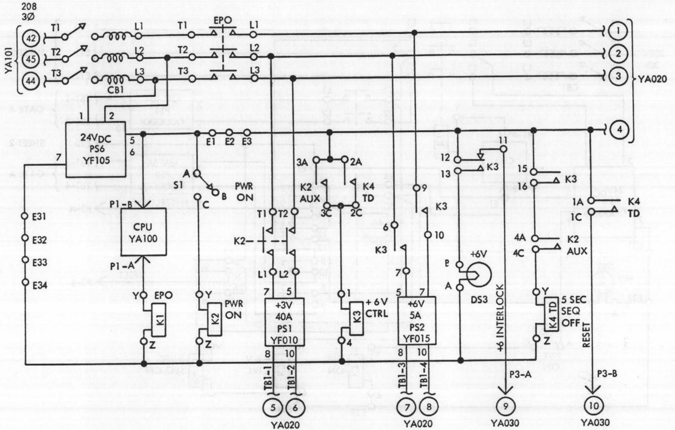
FIGURE 4-1. LOGIC SCHEMATIC, POWER SYSTEM
