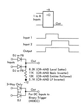
Figure 27. Diode Circuits
