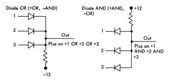
Figure 10. DDTL Diode Circuits
