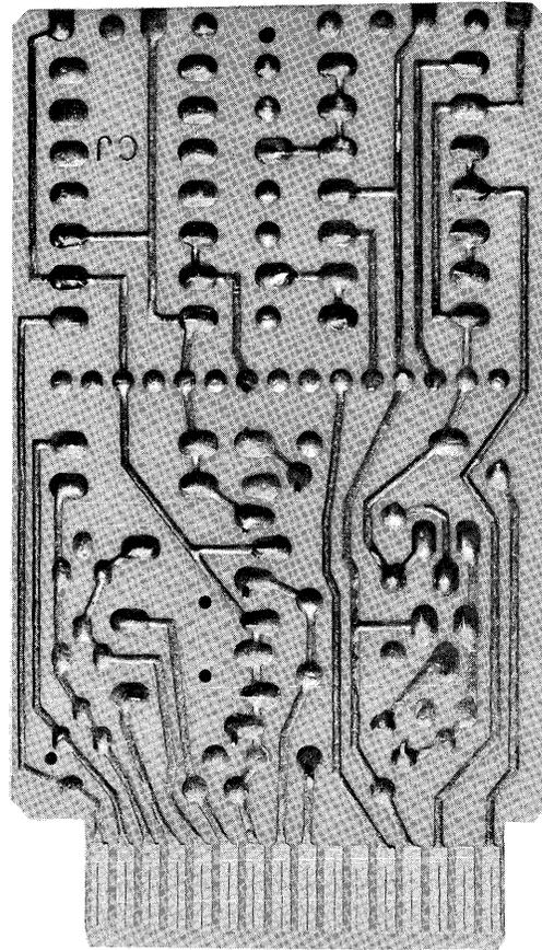
FIGURE 3. SMS CARD, REVERSE SIDE, ACTUAL SIZE
