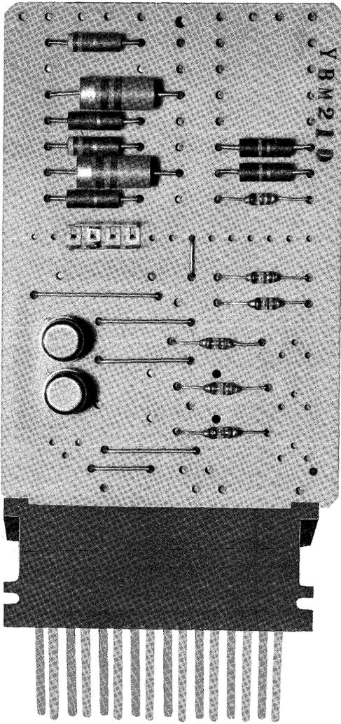
FIGURE 2. SMS CARD, FRONT SIDE, ACTUAL SIZE
