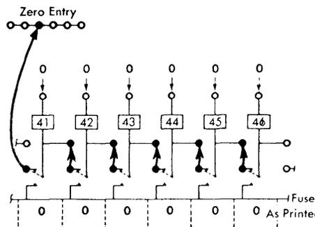
FIGURE 220. ZERO PRINT CONTROL—ZERO REGARDLESS OF SIGNIFICANT DIGIT
