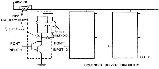
FIG. 3 SOLENOID DRIVER CIRCUITRY
