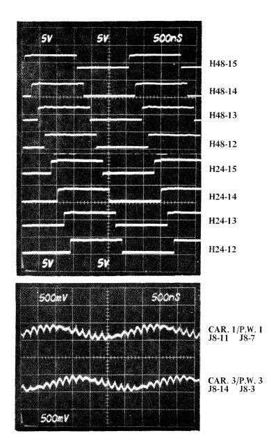
Figure 4-19 SINE-WAVE DRIVE GENERATOR WAVEFORMS
