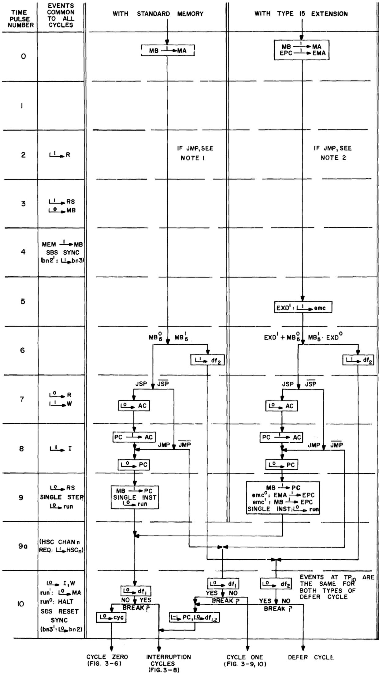
1. 1 CHANNEL SBS, IF sbm<sup>1</sup> [C(MB<sub>6-17</sub>)=1]: L<sup>0</sup> → b3, b4
