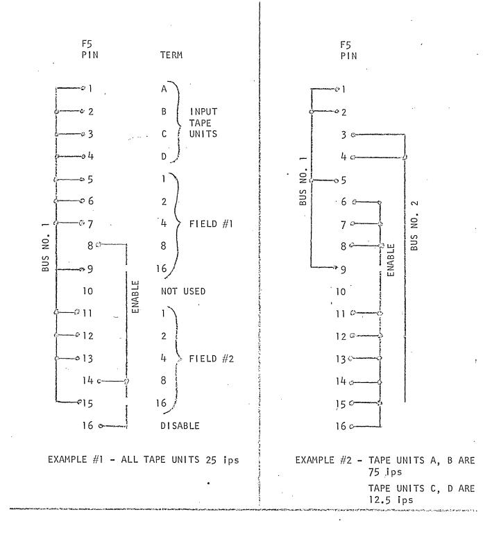
FIG. 3-8 EXAMPLE TAPE SPEED SELECTION
