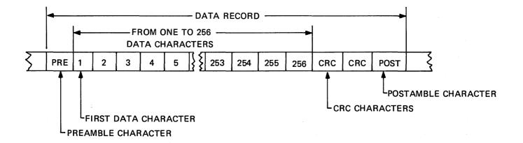
**CRC – CYCLICAL REDUNDANCY CHECK**
