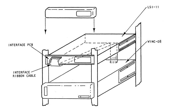
Figure 2-7. LSI-11 Installation
