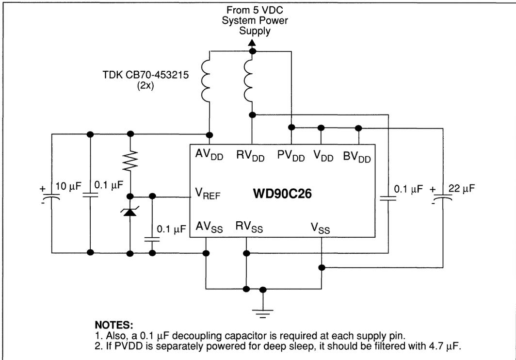
**FIGURE 6-4 RECOMMENDED POWER SUPPLY ISOLATION AND DECOUPLING**
