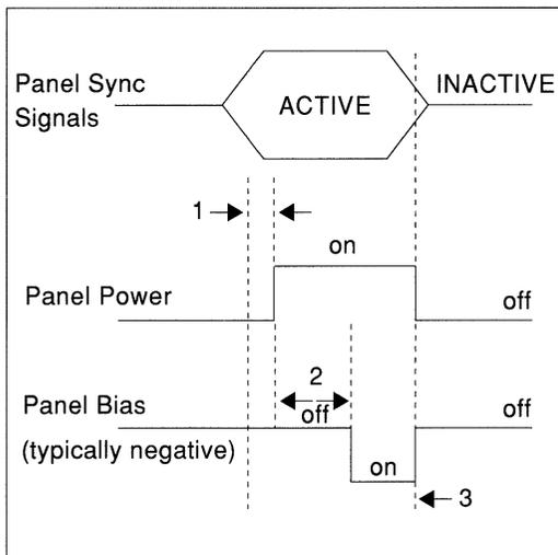
**FIGURE 6-11 TYPICAL PANEL SEQUENCING REQUIREMENTS**
