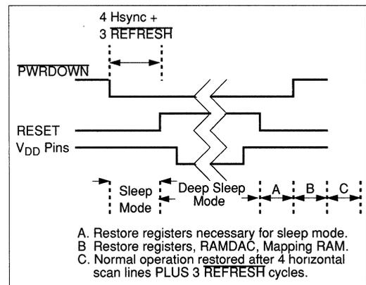
**FIGURE 6-10 PIN SEQUENCING FOR DEEP SLEEP OPERATION**
