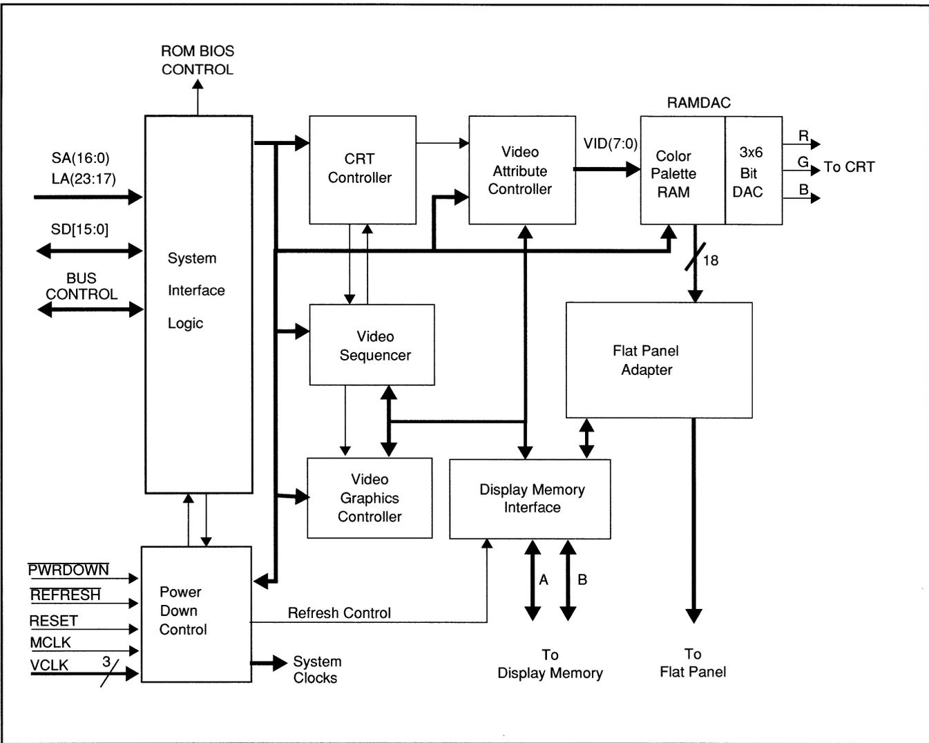
FIGURE 2-1 WD90C26 BLOCK DIAGRAM
