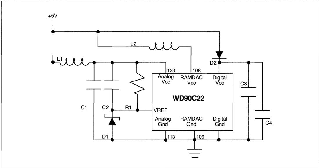
FIGURE 4-2. POWER DISTRIBUTION FOR WD90C22
