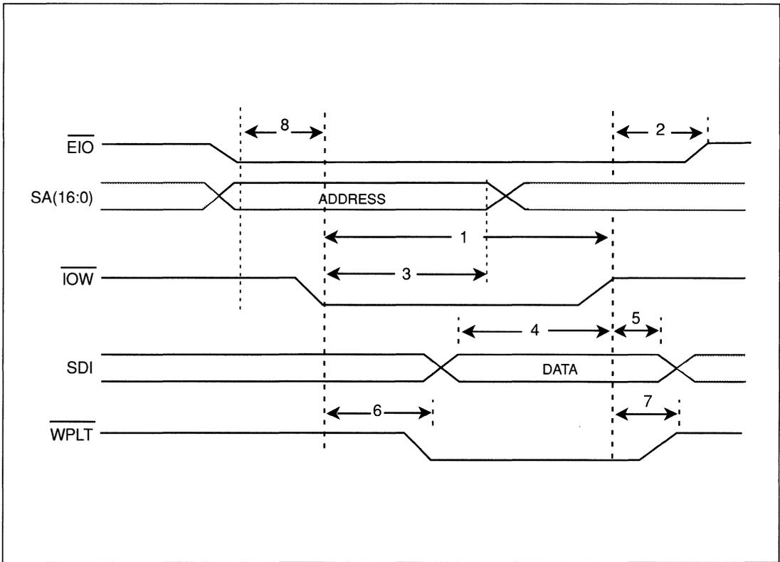
FIGURE C-1. I/O WRITE-AT MODE
