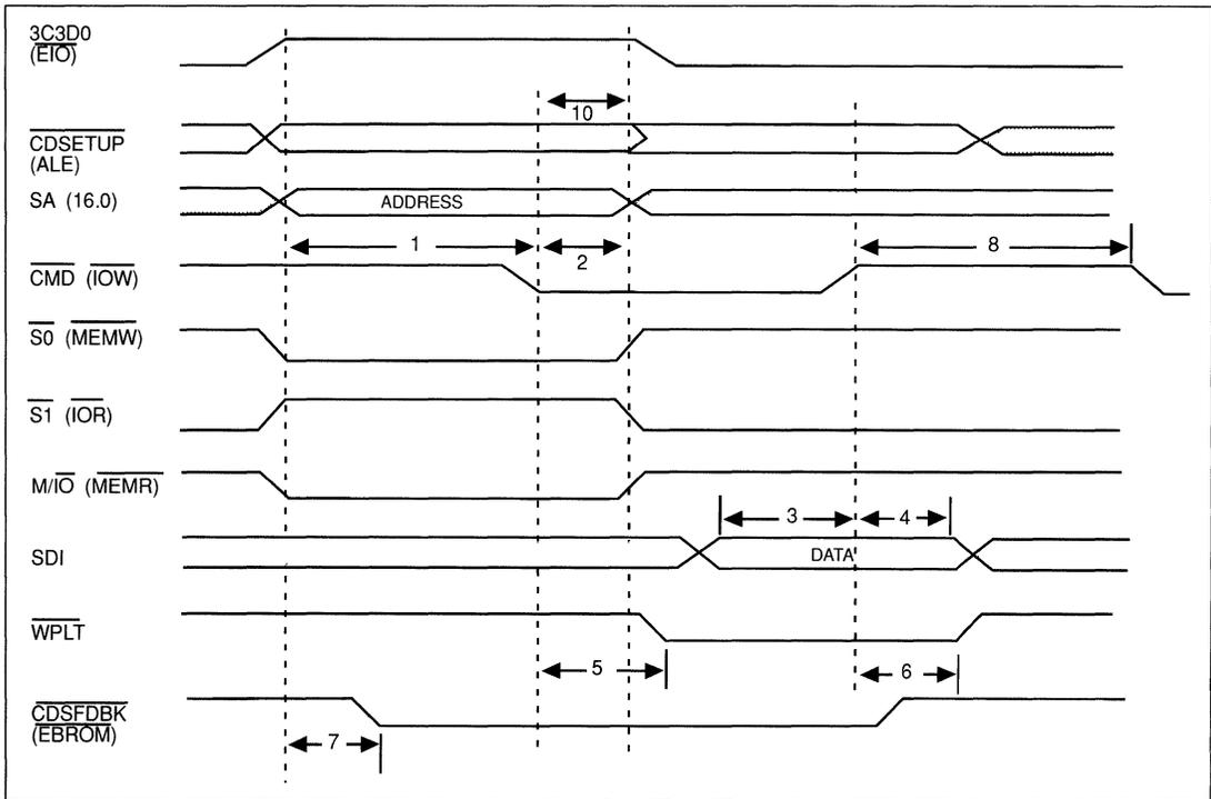
FIGURE C-5. I/O WRITE-MICRO CHANNEL MODE
