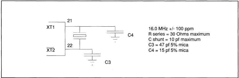
**FIGURE 2. XTAL OSCILLATOR CIRCUITS FOR THE 44-PIN PLCC**
