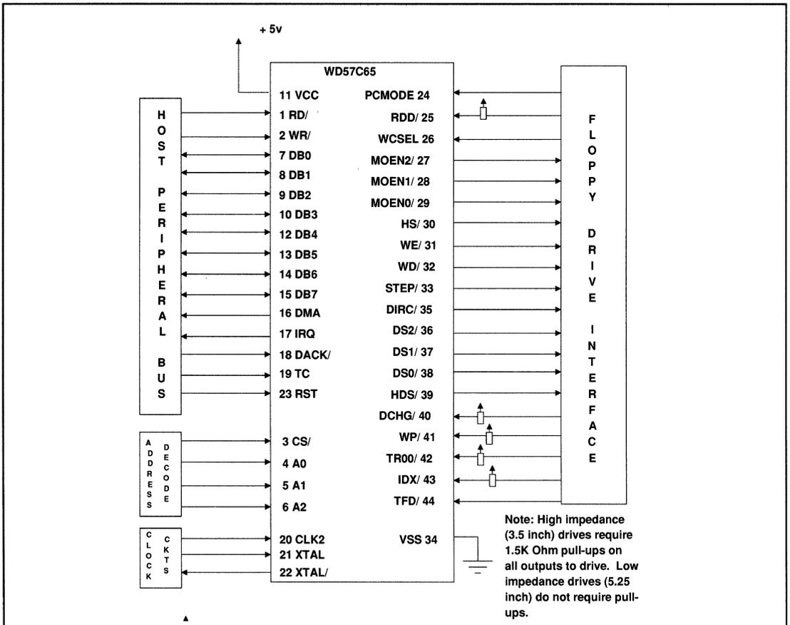
FIGURE 3-3. TYPICAL WD57C65 SYSTEM
