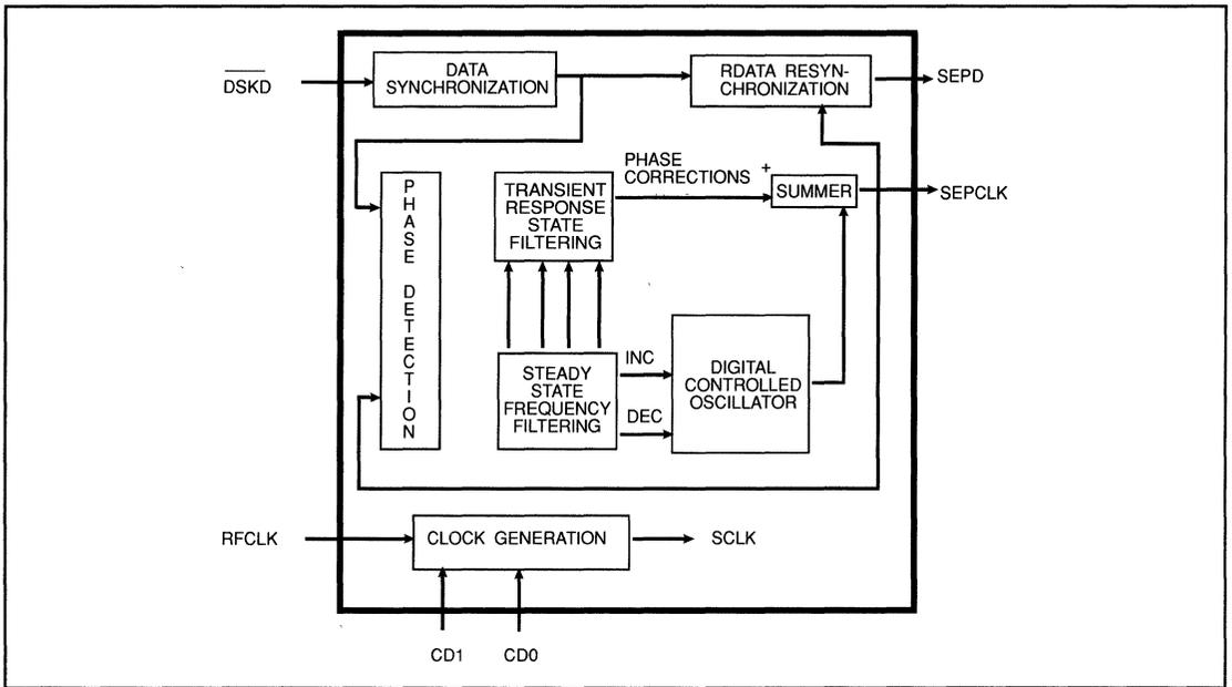
FIGURE 2-3. WD92C32 SIMPLIFIED BLOCK DIAGRAM
