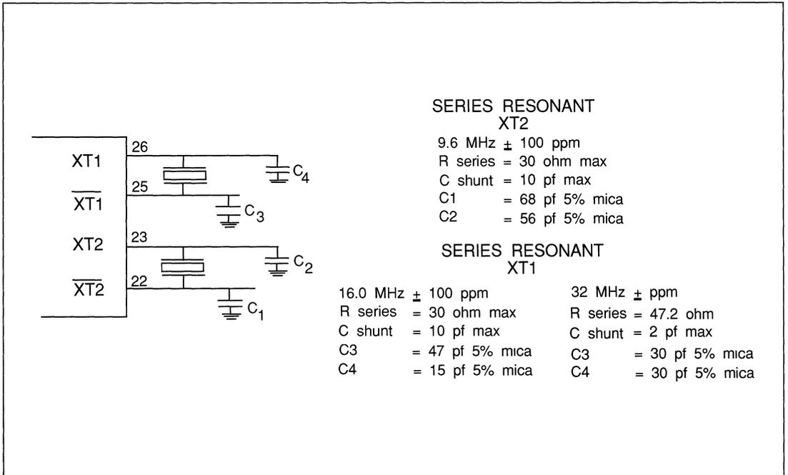
FIGURE 14-1. CRYSTAL OSCILLATOR CIRCUITS FOR 44-PIN PLCC
