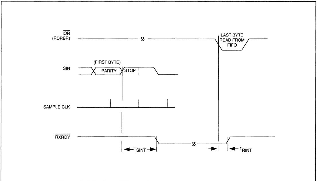
**FIGURE 7-8. RECEIVER DMA MODE 0 TIMING**
