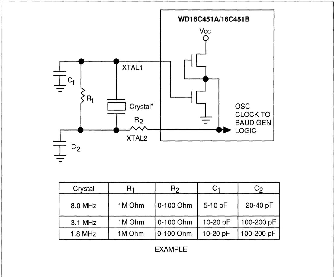
**FIGURE 6-2. TYPICAL CRYSTAL OSCILLATOR NETWORK**
