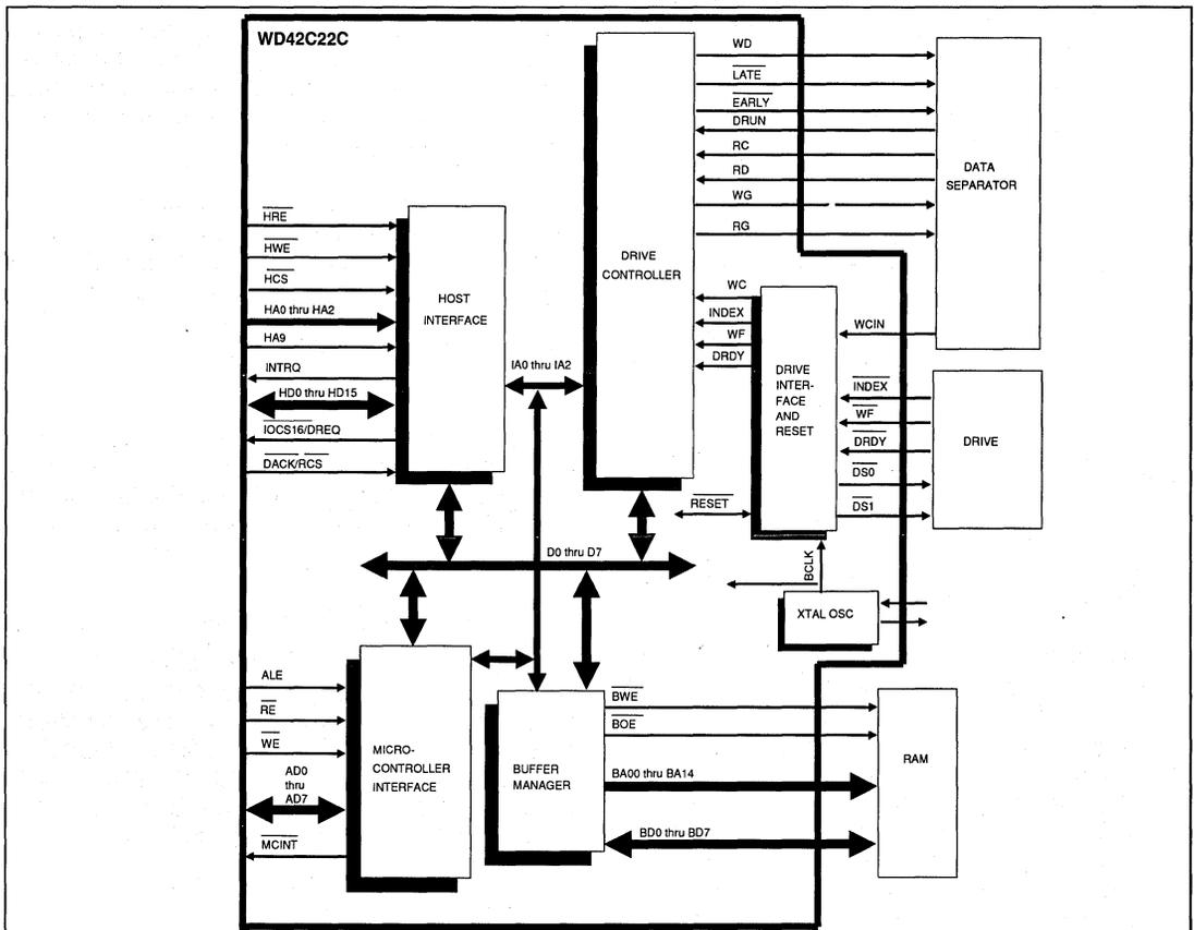
FIGURE 2. WD42C22C BLOCK DIAGRAM
