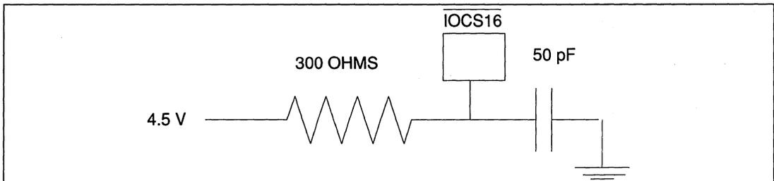
FIGURE 8. TEST CIRCUIT 1
