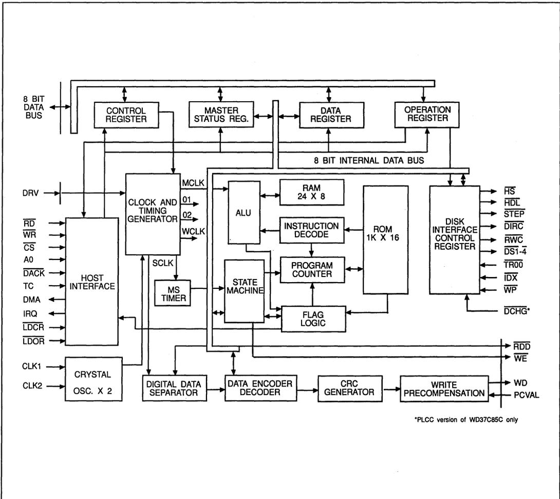
FIGURE 3-1. WD37C65C BLOCK DIAGRAM
