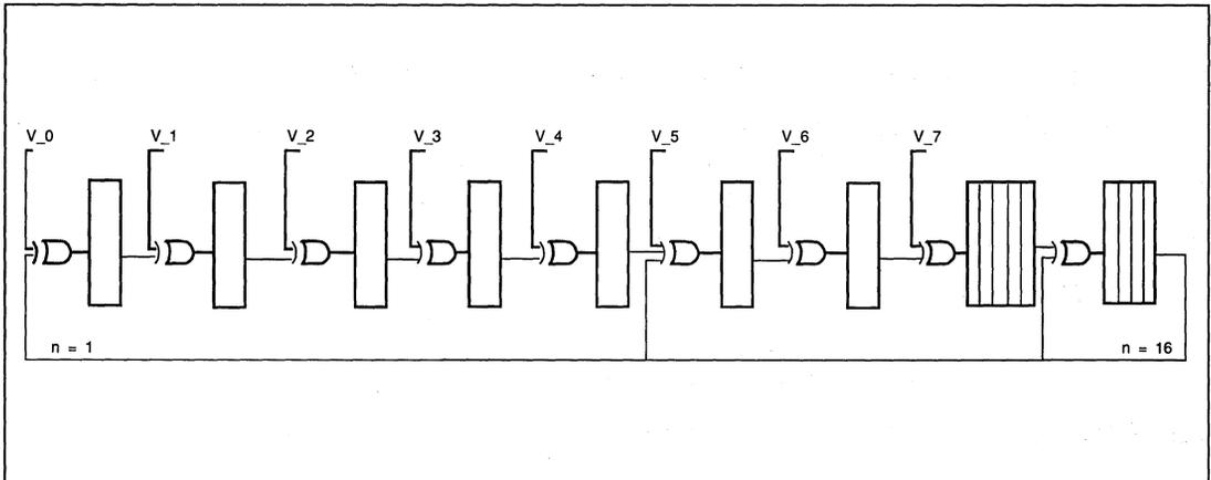
FIGURE B-1. LINEAR FEEDBACK SHIFT REGISTER
