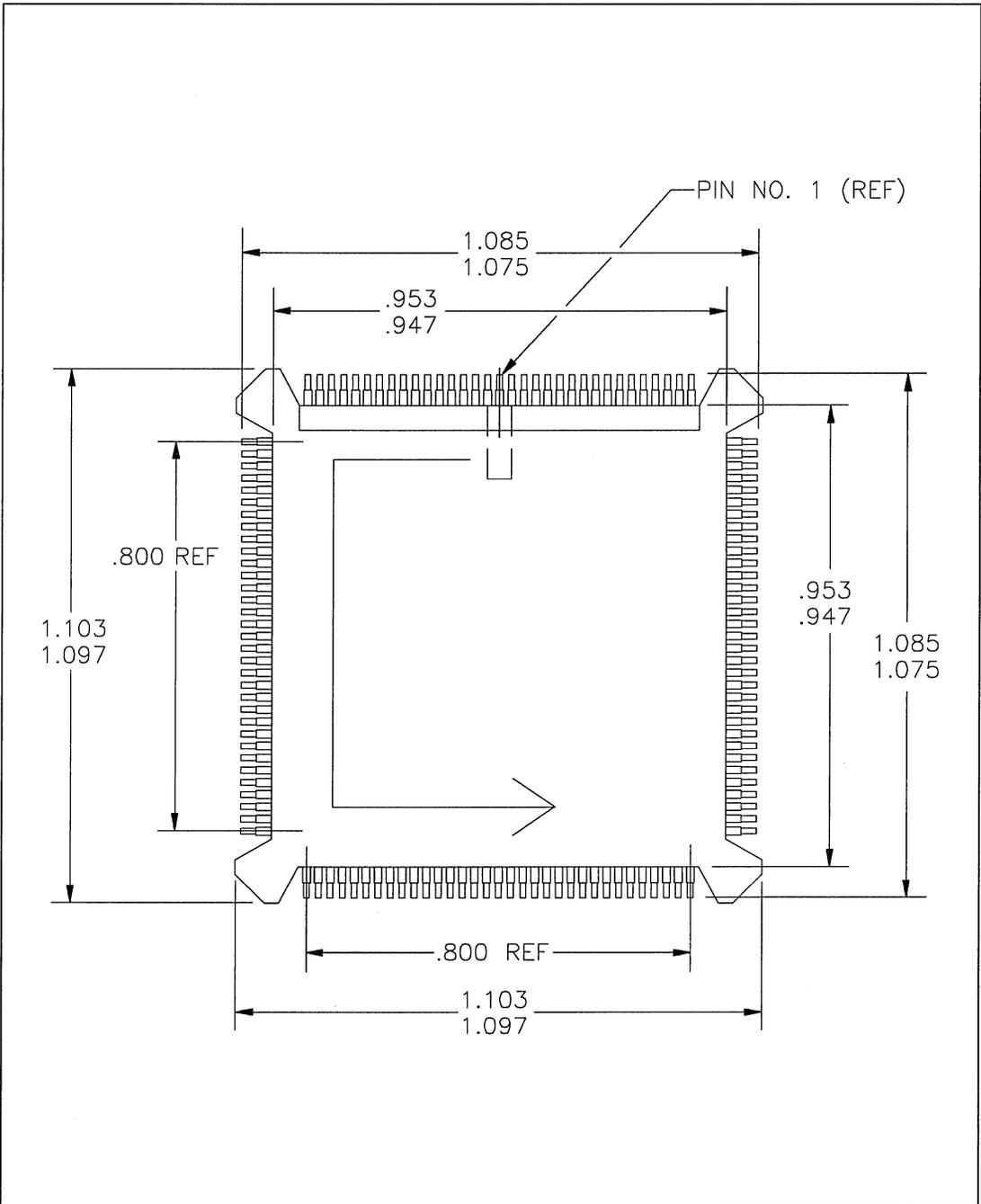
FIGURE 8-1. 132-PIN JEDEC PLASTIC FLAT PACKAGE (PFP)
