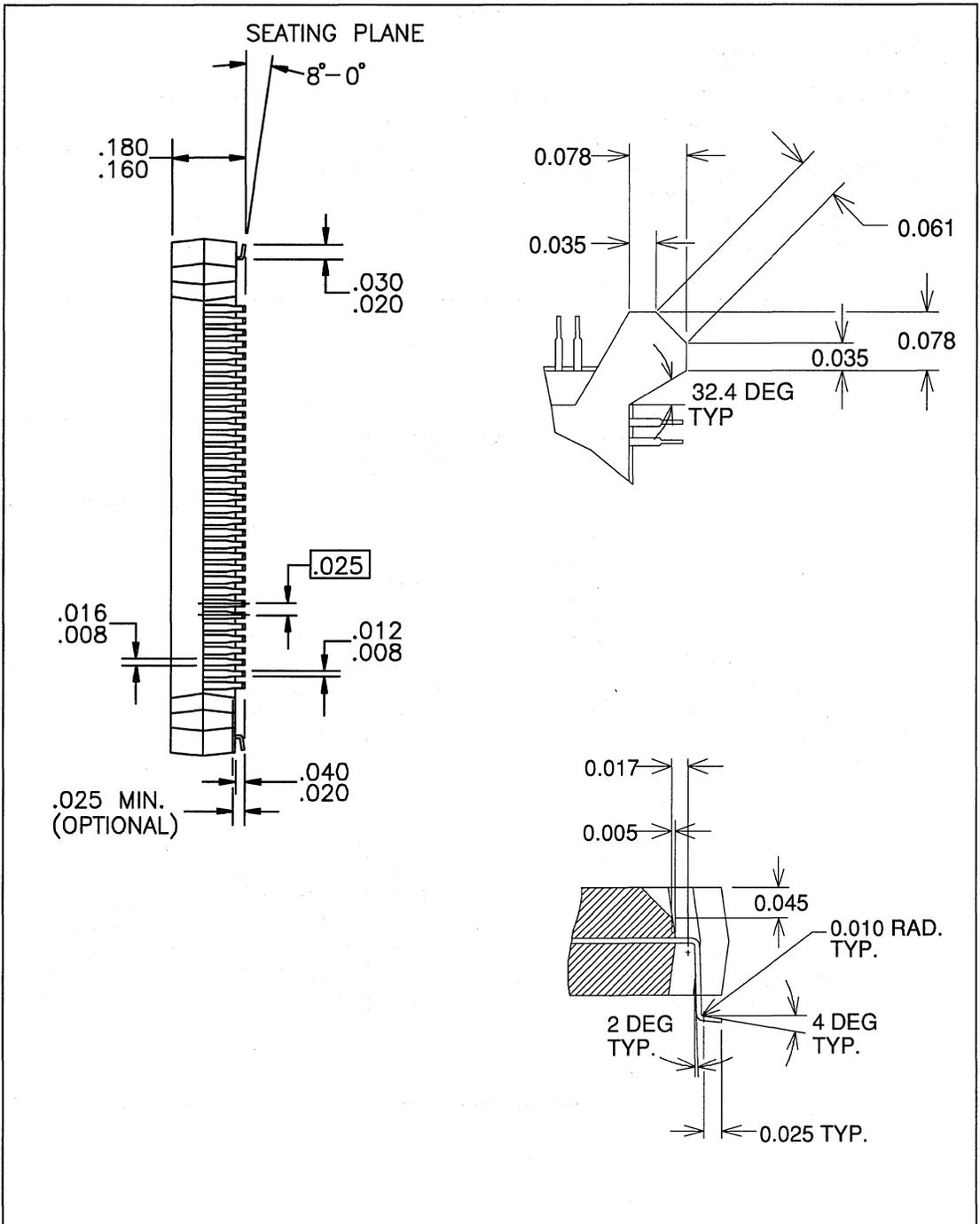
FIGURE 8-2. 132-PIN JEDEC PLASTIC FLAT PACKAGE (PFP)
