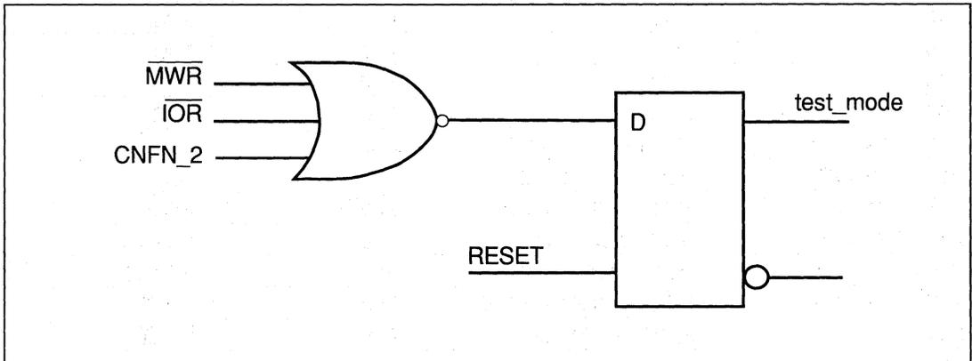
FIGURE C-1. TEST MODE CIRCUIT
