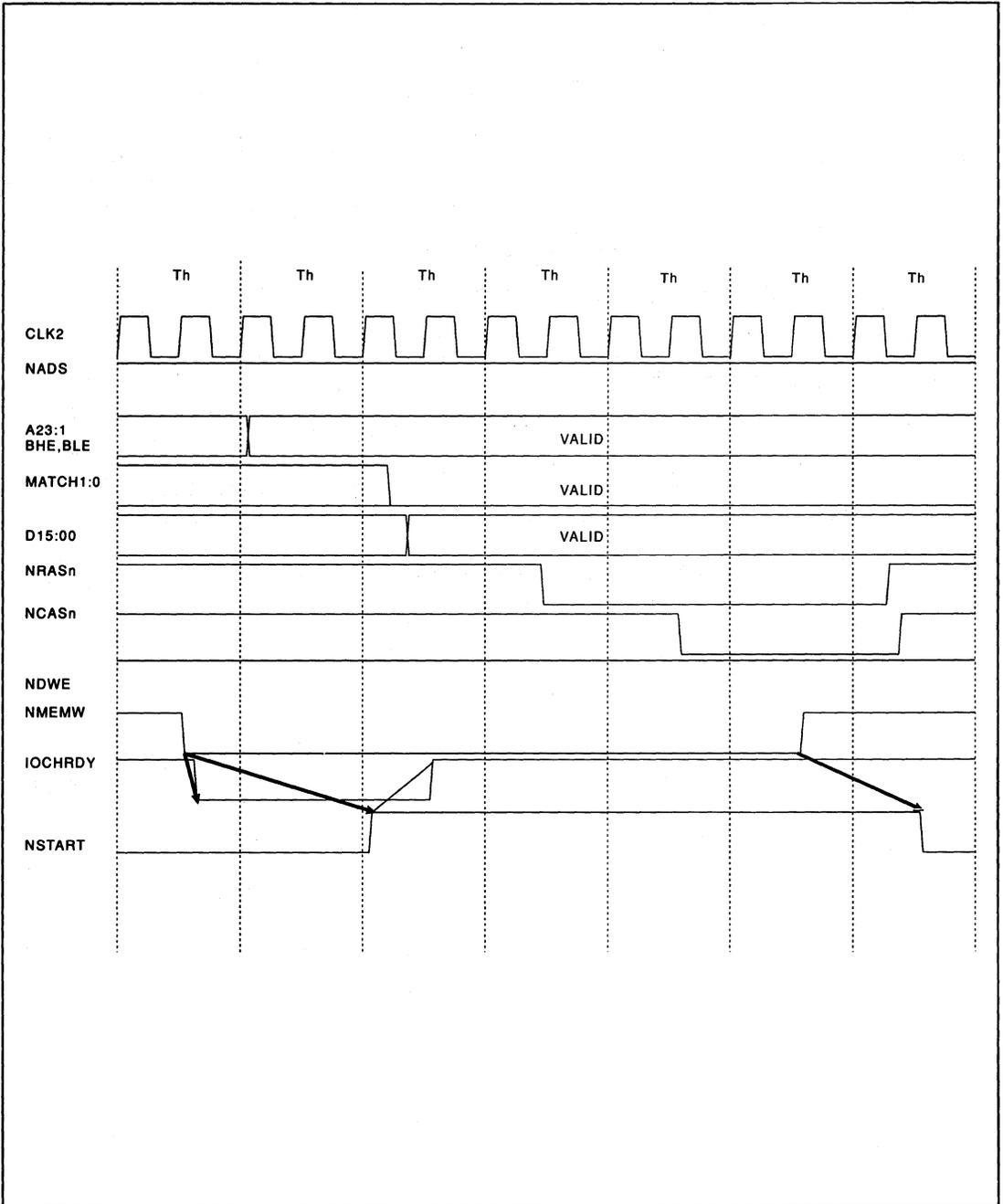
FIGURE 12-66. DMA/MASTER MEMORY WRITE MISS CYCLE
