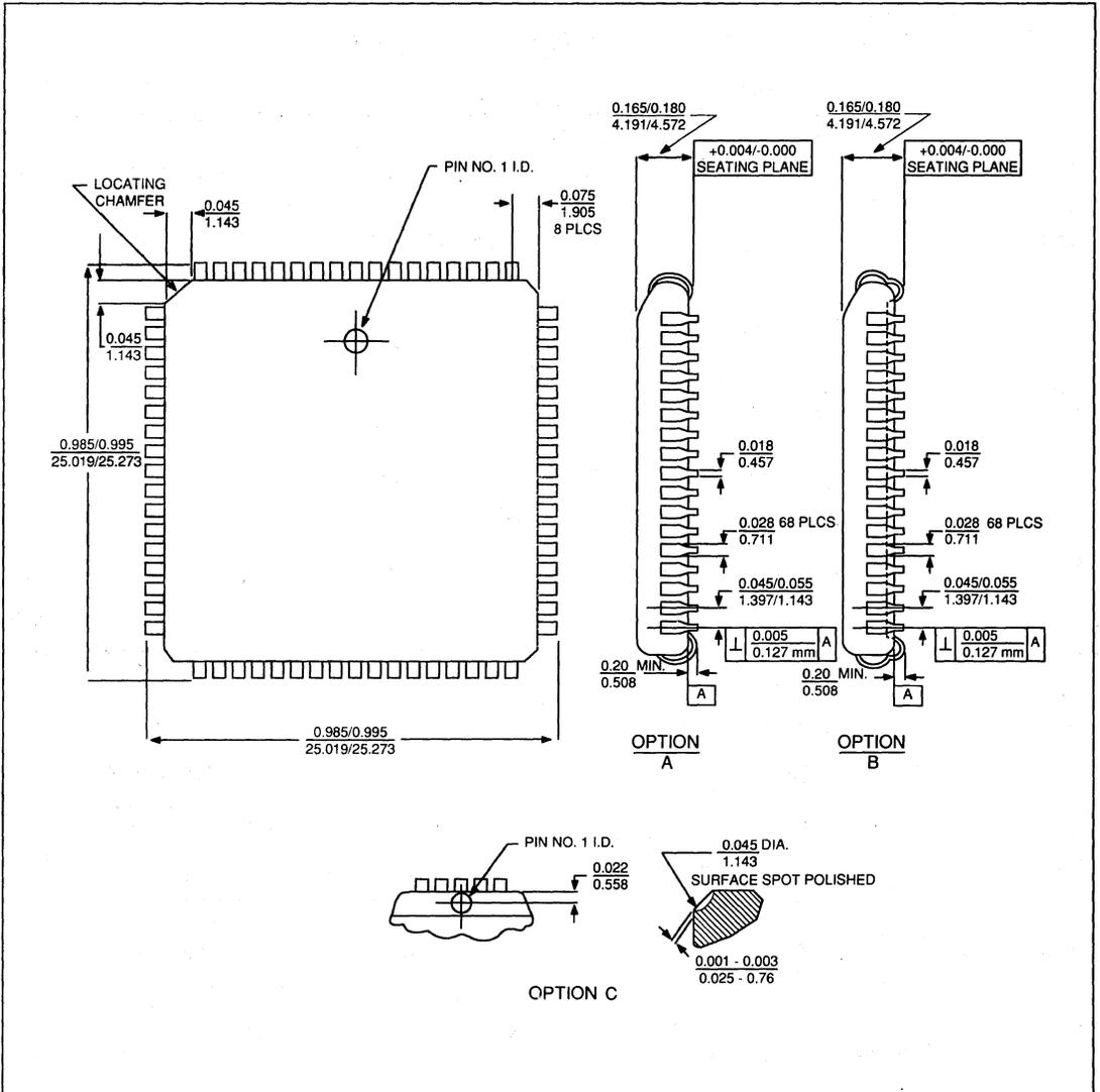
FIGURE C-1. 68-PIN QUAD PLASTIC PACKAGE
