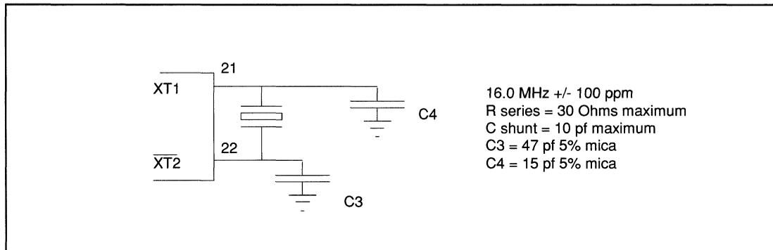
FIGURE 2. XTAL OSCILLATOR CIRCUITS FOR THE 44-PIN PLCC
