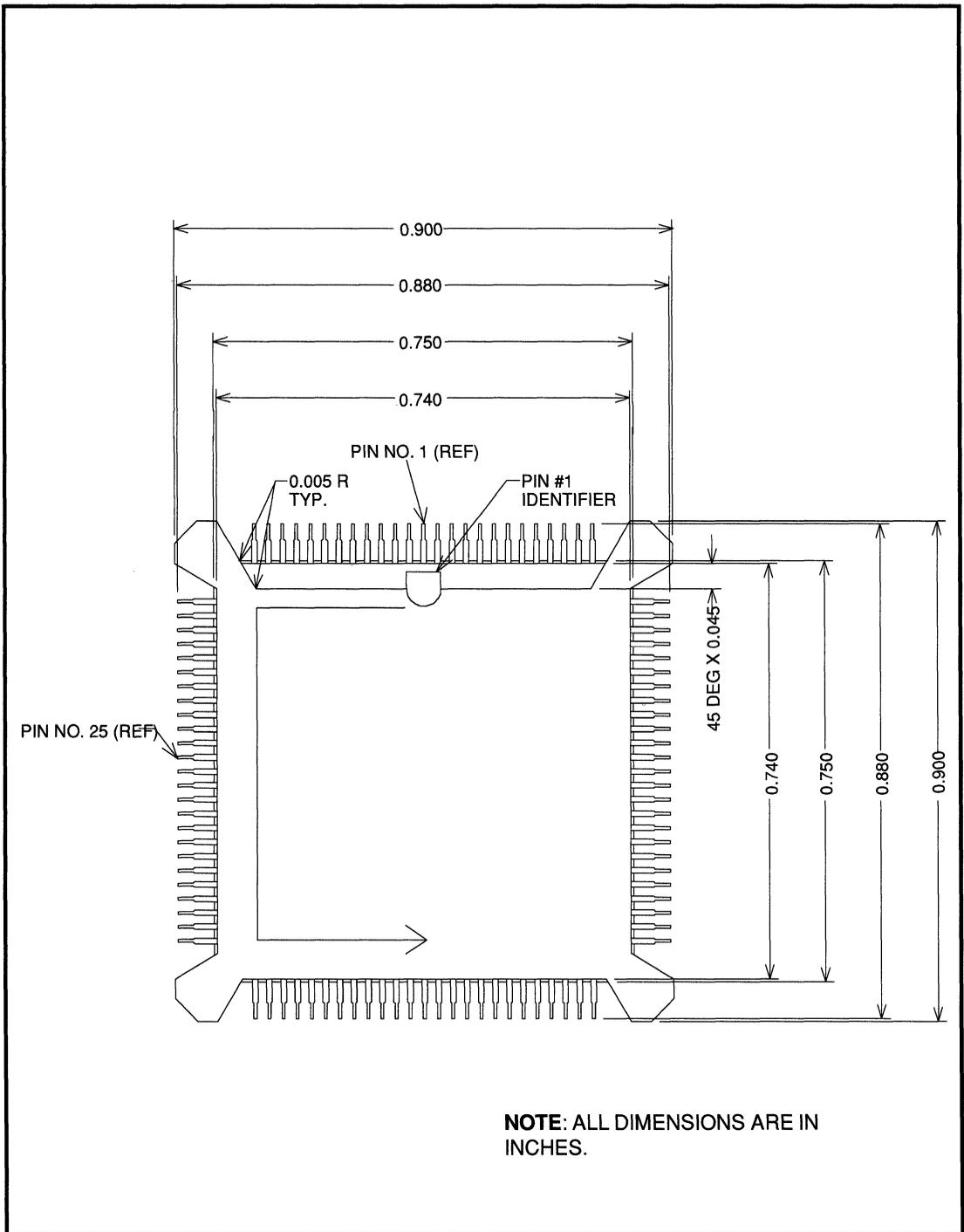
FIGURE 22. 100-PIN JEDEC PLASTIC QUAD FLAT PACKAGE (PQFP)
