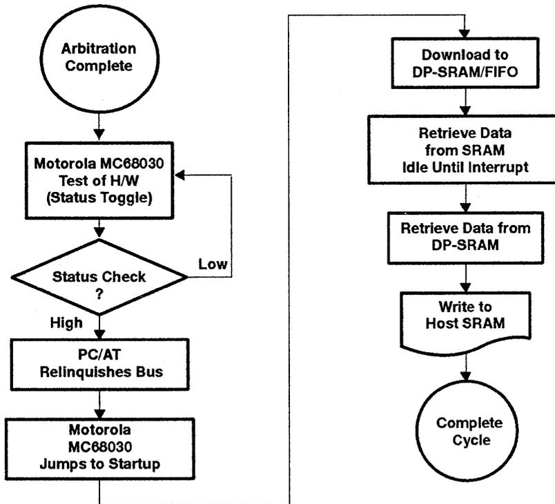
Figure 4. Block Diagram – Motorola MC68030 Code
