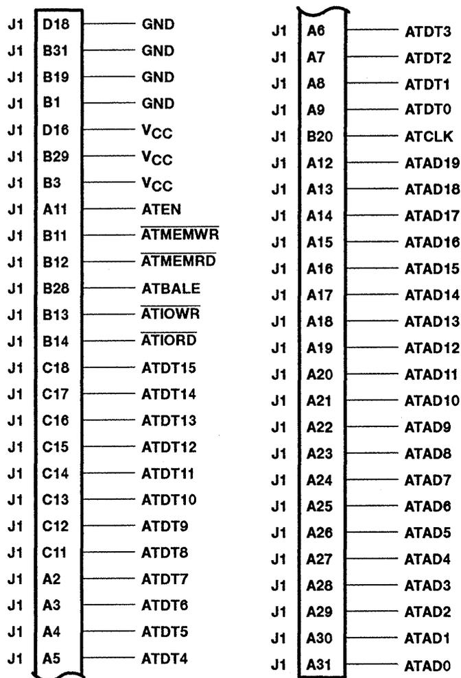
Figure 29. AT-Bus Connector
