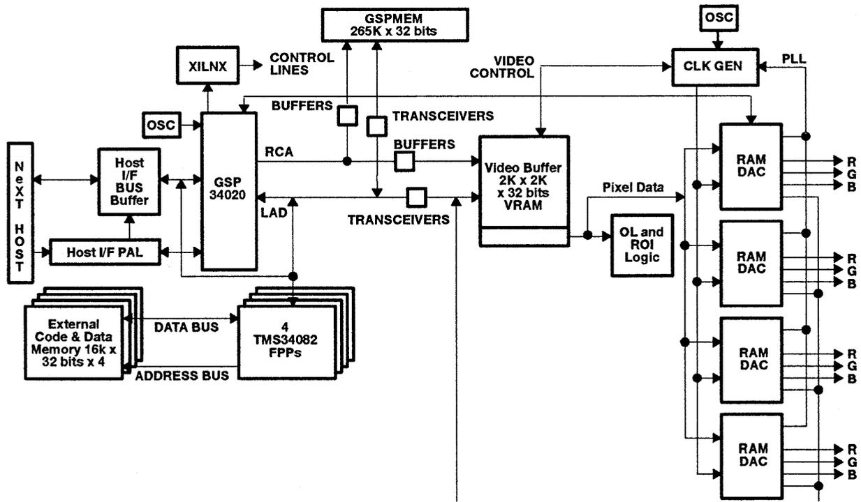
Figure 1. UWGSP Block Diagram
