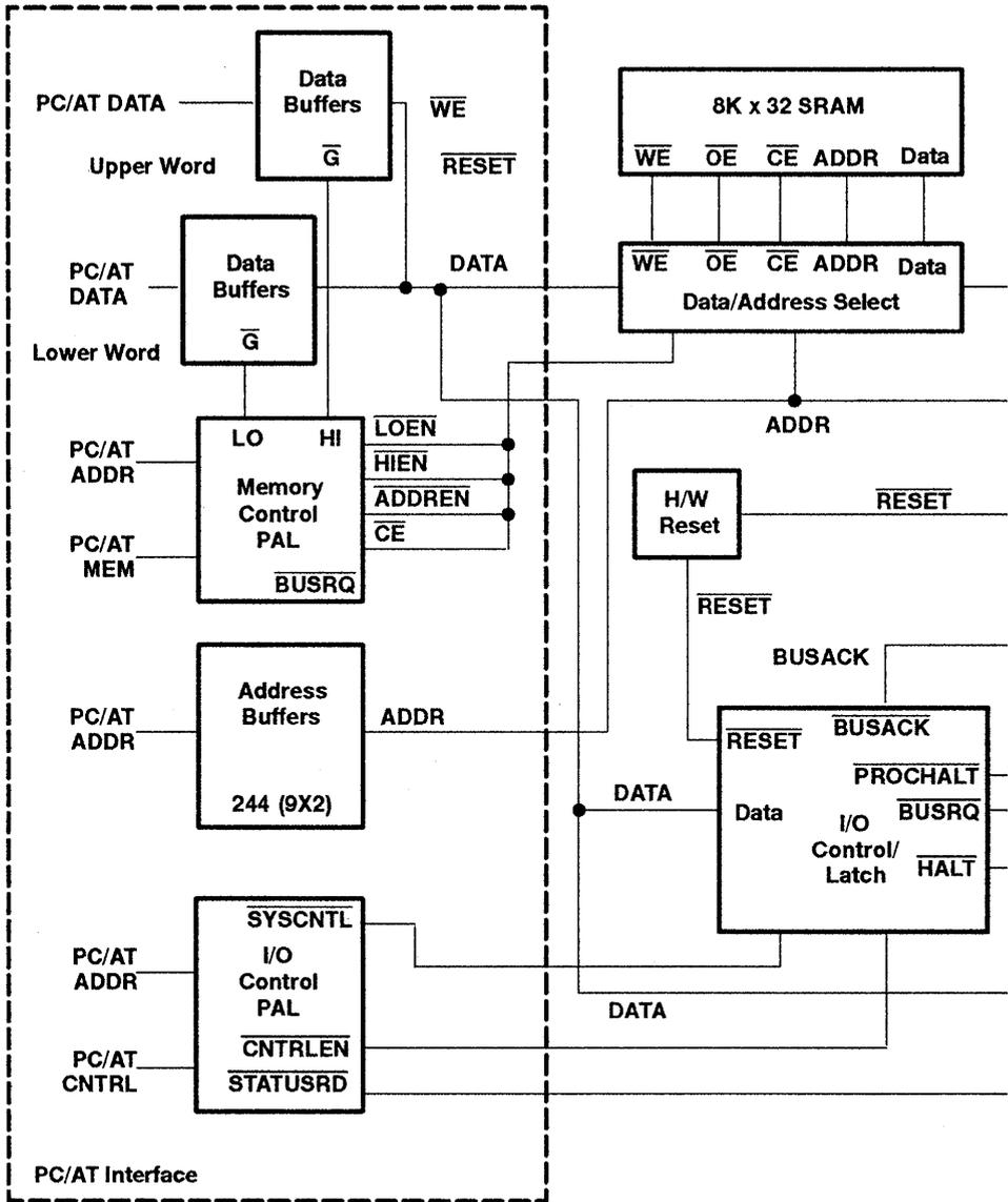
Figure 8(a). Block Diagram
