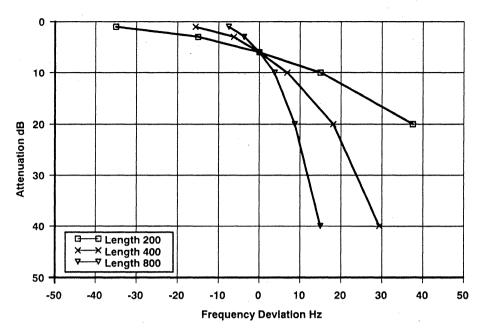
Figure 21. Filter Band Edge Shape - Wide Filter
