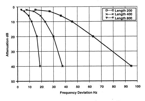
Figure 22. Filter Band Edge Shape - Narrow Filter
