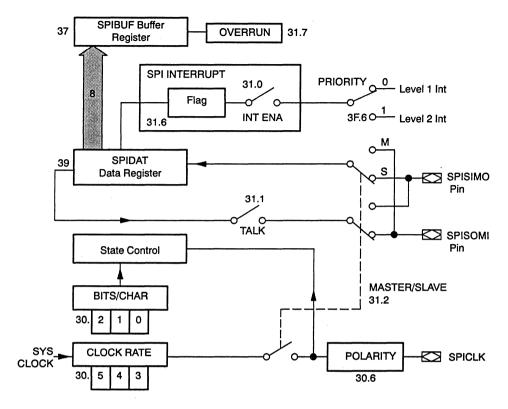
Figure 7. TMS370C010 SPI Module
