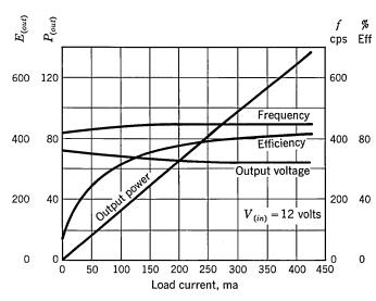
Fig. 34.13. 100-watt converter.
