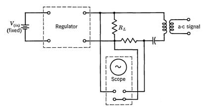
Fig. 9.23.  $Z_0$  test circuit.
