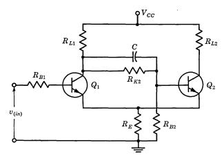
Fig. 28.10. Basic Schmitt trigger.
