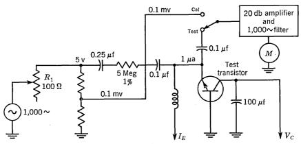
Fig. 5.18.  $h_{ib}$  test set.
