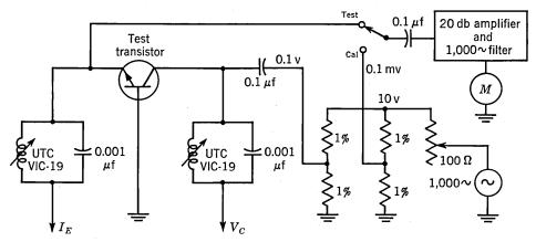
Fig. 5.20.  $h_{rb}$  test set.
