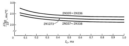
Fig. 8.11.  $\Delta V_{BE}/\Delta T$  vs.  $I_C$ .
