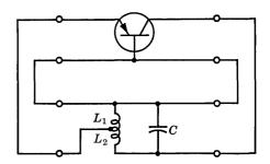
Fig. 22.4. The tapped Hartley circuit.
