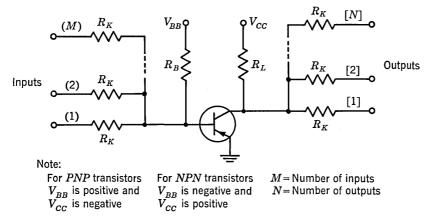
Fig. 29.10. Basic NOR TRL circuit.
