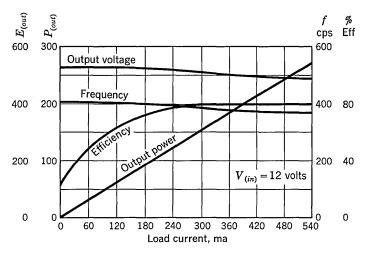
Fig. 34.16. 250-watt converter.
