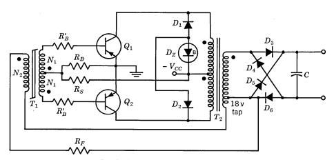
Fig. 34.9. Type C 500-watt converter.
