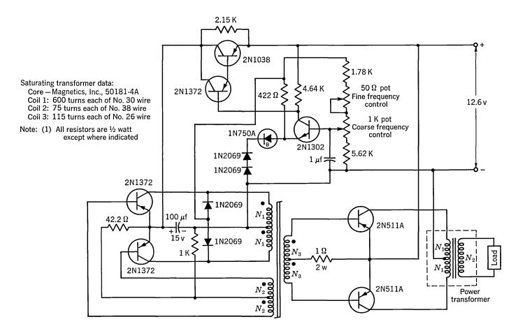
Fig. 35.11. 100-watt 60-cycle inverter.
