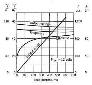
Fig. 34.12. 55-watt converter.
