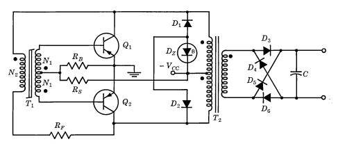
Fig. 34.8. Type B converter.
