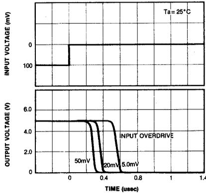
Fig. 5 RESPONSE TIME FOR VARIOUS INPUT OVERDRIVE-POSITIVE TRANSITION
