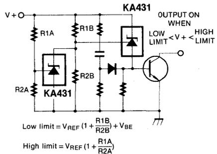
FIGURE 18—VOLTAGE MONITOR
