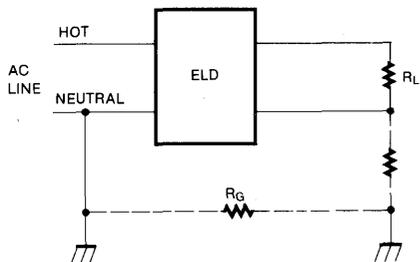
FIG. 5 GROUNDED NEUTRAL FAULT
