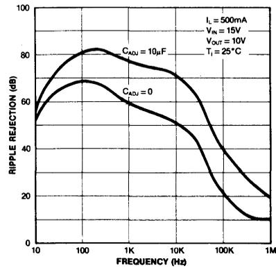
Fig. 7 RIPPLE REJECTION
