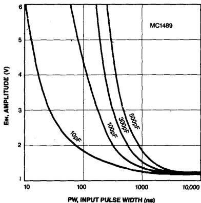
Fig. 4 — TYPICAL TURN-ON THRESHOLD  $V_s$  CAPACITANCE FROM RESPONSE CONTROL PIN TO GND
