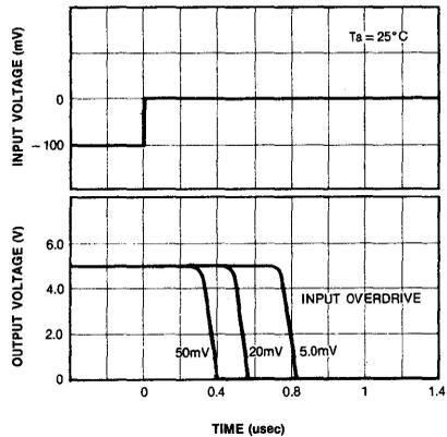
Fig. 5 RESPONSE TIME FOR VARIOUS INPUT OVERDRIVE-POSITIVE TRANSITION
