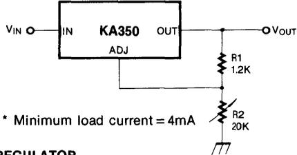
Fig. 22 5A CONSTANT VOLTAGE/CONSTANT CURRENT REGULATOR
