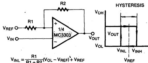
$$V_{INL} = \frac{R1}{R1 + R2} (V_{OL} - V_{REF}) + V_{REF}$$
