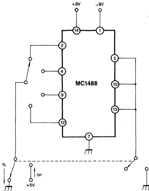
FIGURE 2 OUTPUT VOLTAGE
