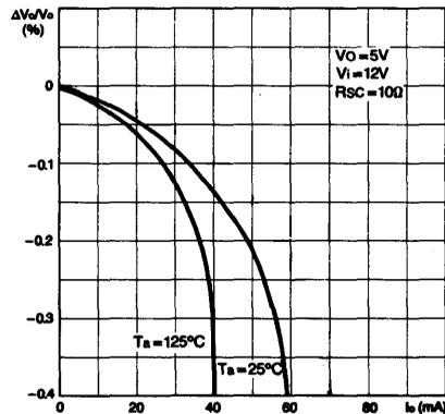
Fig. 13 LINE REGULATION—VOLTAGE DROP
