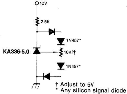
Fig. 10 TRIMMED 4V TO 6V REFERENCE WITH TEMPERATURE COEFFICIENT INDEPENDENT OF BREAKDOWN VOLTAGE
