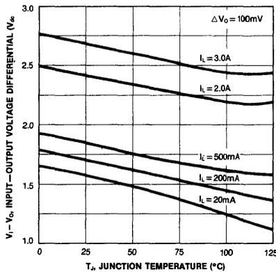
Fig. 5 TEMPERATURE STABILITY
