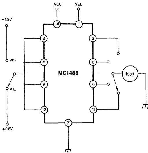
FIGURE 4 OUTPUT RESISTANCE (POWER OFF)
