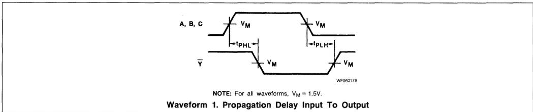
**TEST CIRCUIT AND WAVEFORMS**
