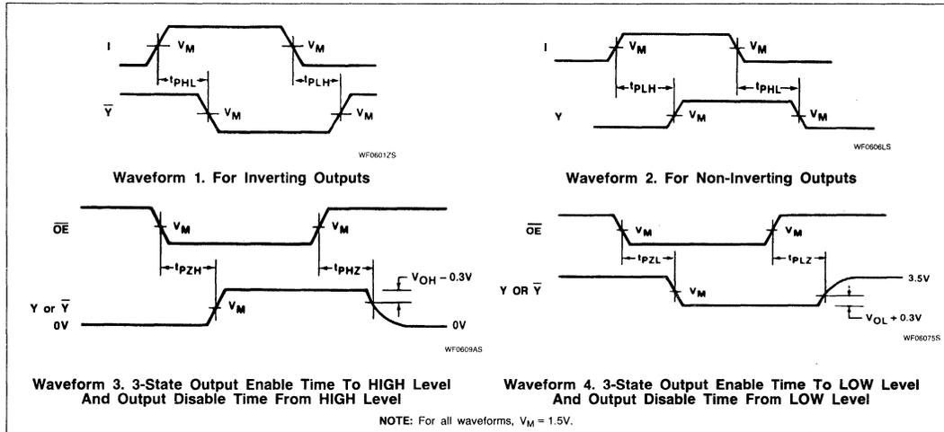
TEST CIRCUIT AND WAVEFORMS
