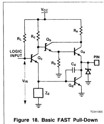
Figure 18. Basic FAST Pull-Down
