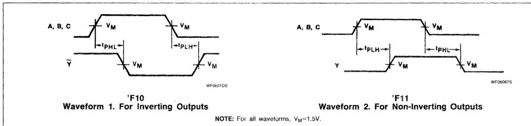
**TEST CIRCUIT AND WAVEFORMS**
