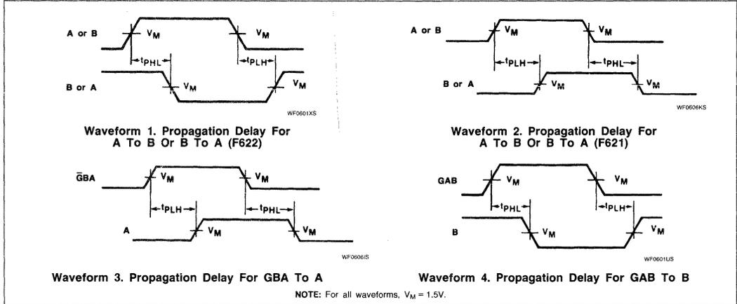
TEST CIRCUIT AND WAVEFORMS
