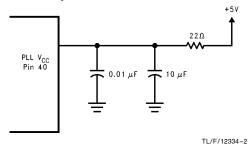
FIGURE 3. PLL V<sub>CC</sub> Noise Filter
