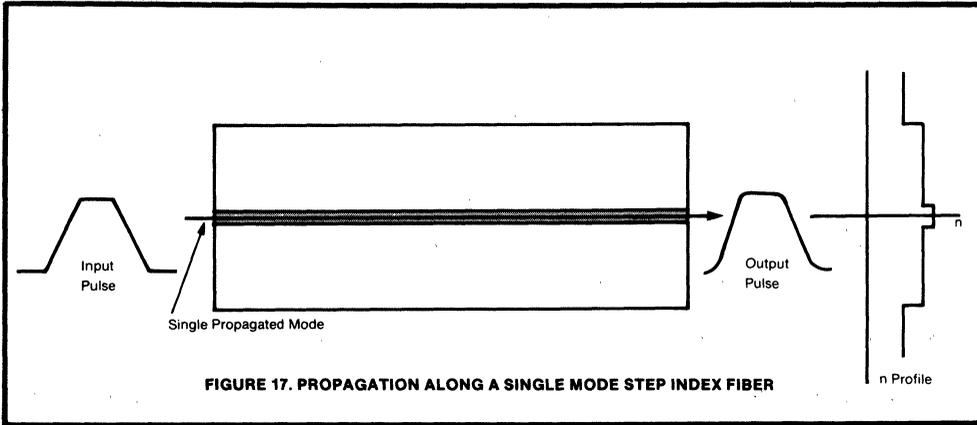
FIGURE 17. PROPAGATION ALONG A SINGLE MODE STEP INDEX FIBER
