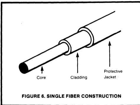
FIGURE 6. SINGLE FIBER CONSTRUCTION
