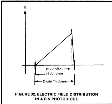
FIGURE 32. ELECTRIC FIELD DISTRIBUTION IN A PIN PHOTODIODE
