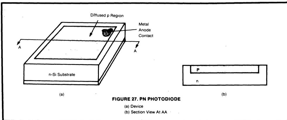
FIGURE 27. PN PHOTODIODE
