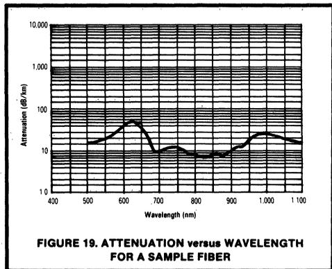
FIGURE 19. ATTENUATION VERSUS WAVELENGTH FOR A SAMPLE FIBER
