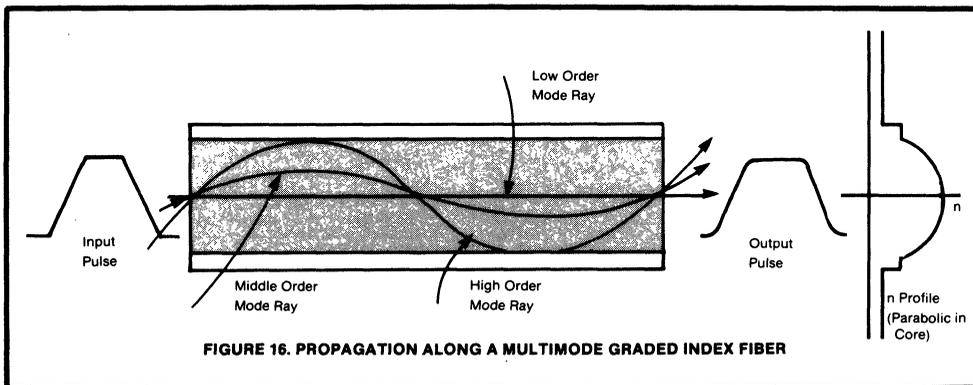
FIGURE 16. PROPAGATION ALONG A MULTIMODE GRADED INDEX FIBER
