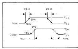
FIGURE 1 - DYNAMIC SIGNAL WAVEFORMS
