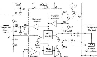
FIGURE 5 - SPEECH NETWORK BLOCK DIAGRAM
