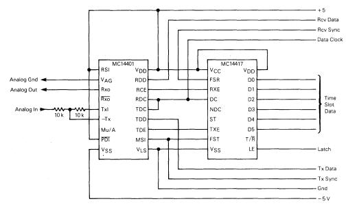
FIGURE 2 - MOTOROLA MONO-CIRCUIT/TSAC COMBINATIONS
