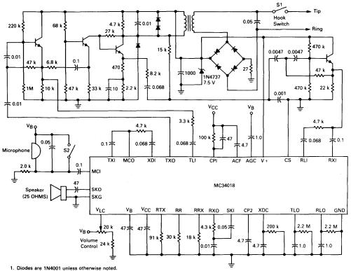
FIGURE 19 - BASIC LINE POWERED SPEAKERPHONE
