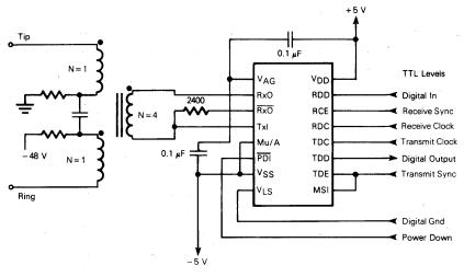
THE BASIC VOICE CHANNEL USING THE MC14400 PCM CODEC/FILTER MONO-CIRCUIT
