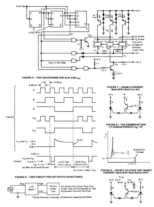
FIGURE 4 - TEST CIRCUIT FOR dv/dt AND ton
