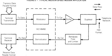
FIGURE 5 - TYPICAL MEDIUM-SPEED MODEM APPLICATION
