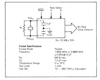
FIGURE 2 - TYPICAL CRYSTAL OSCILLATOR CIRCUIT
