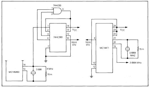
FIGURE 3 - CLOCK CIRCUITS
