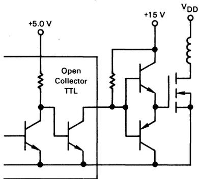
**FIGURE 5-8 — OPEN COLLECTOR TTL DRIVING COMPLEMENTARY EMITTER FOLLOWER**
