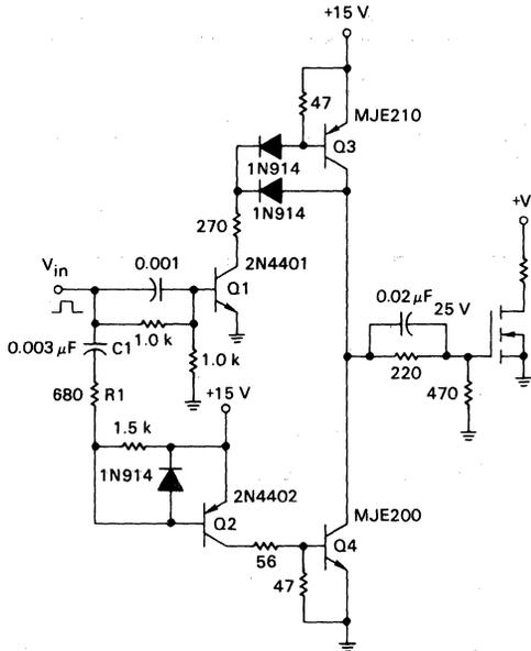
FIGURE 5-11 — PUSH-PULL BASE DRIVE FOR CIRCUITS 7 AND 8
