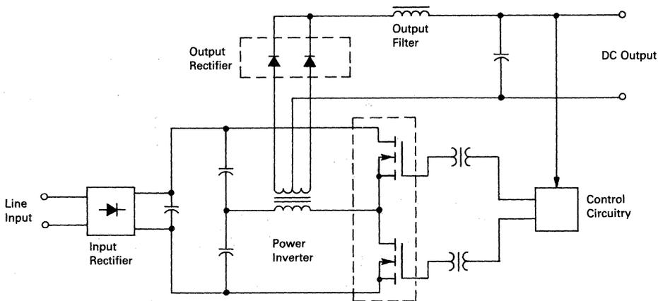
FIGURE 7-14 — BASIC HALF-BRIDGE CONFIGURATION
