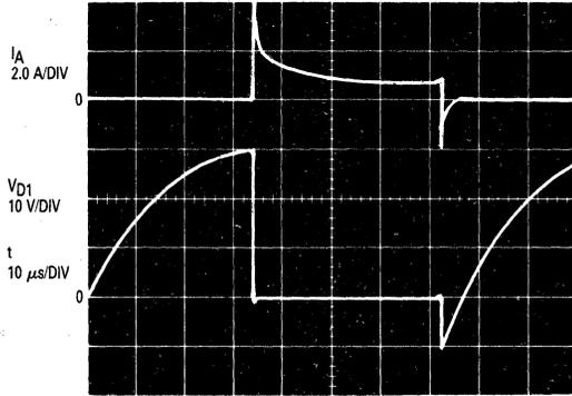
FIGURE 8-27 — OUTPUT WAVEFORMS OF POWER FLIP-FLOP
