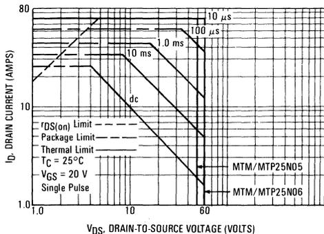
FIGURE 13 — MAXIMUM SWITCHING SAFE OPERATING AREA
