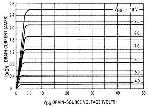
FIGURE 7 — SATURATION CHARACTERISTIC
