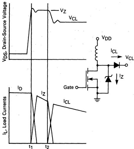
FIGURE 10-4 — IDEALIZED WAVEFORMS OF A DUAL CLAMPING SCHEME PROVIDING DRAIN-SOURCE OVERVOLTAGE PROTECTION
