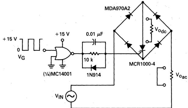
FIGURE 8-28 — AC POWER SWITCH USING THE MOS SCR
