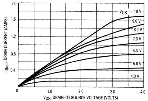
**FIGURE 3 — OUTPUT CHARACTERISTICS**
