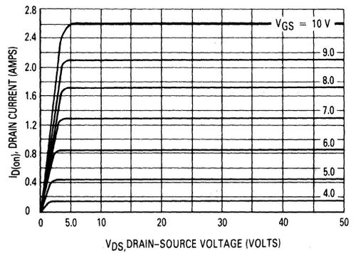
FIGURE 7 — SATURATION CHARACTERISTIC
