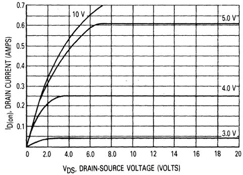
FIGURE 7 — SATURATION CHARACTERISTIC
