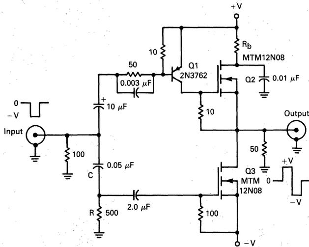
FIGURE 7-37 — MOSFET DRIVER CIRCUIT
