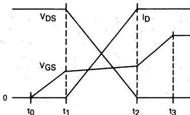
FIGURE 5-3 — IDEALIZED RESISTIVE TURN-ON WAVEFORMS
