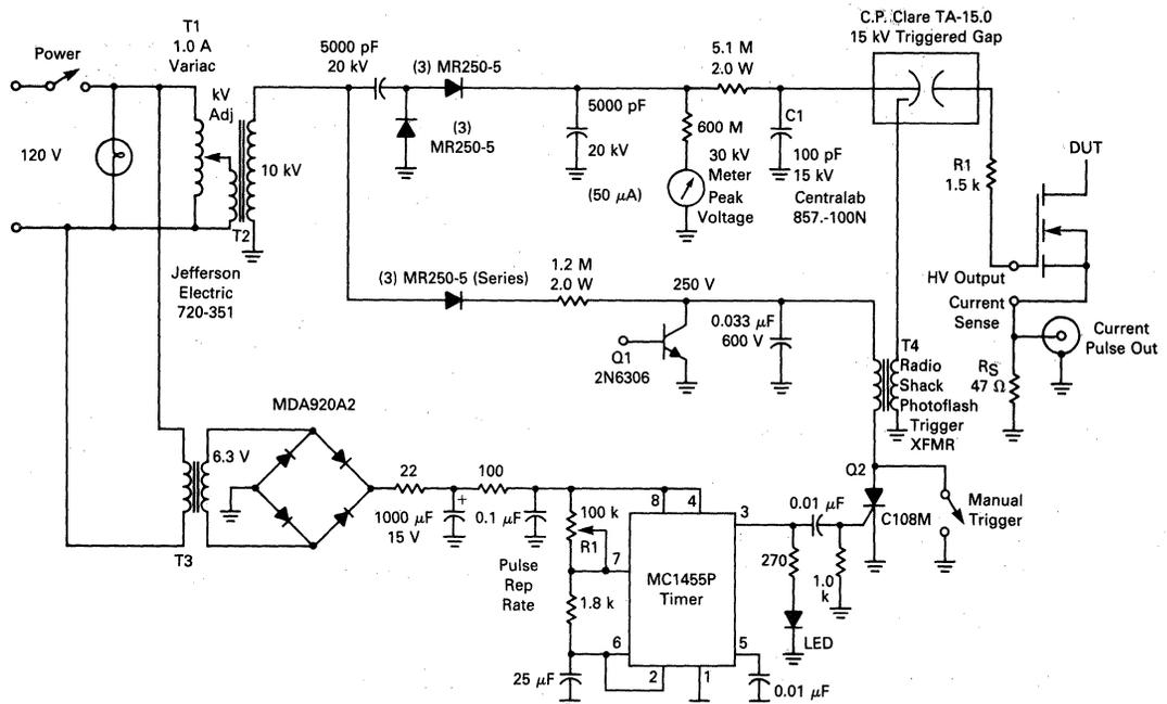
FIGURE 3-4 — ESD (ELECTRO STATIC DISCHARGE) PULSER
