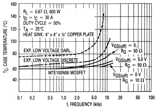
FIGURE 9-16 — CASE TEMPERATURE OF THE EMS PACKAGE FOR A RESISTIVE LOAD AS A FUNCTION OF OPERATING FREQUENCY
