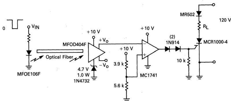
FIGURE 8-33 — OP-AMP GATE DRIVER IN A FIBER OPTIC SYSTEM
