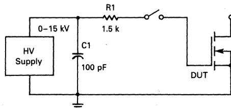
**FIGURE 3-3 — THE HUMAN-BODY EQUIVALENT NETWORK**
