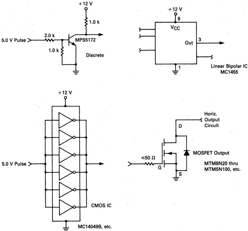
FIGURE 7-33 — MOSFET DRIVE CIRCUITS
