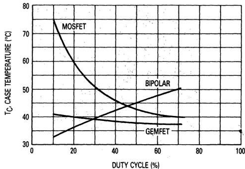
**FIGURE 8-8 — ON-STATE EFFICIENCY COMPARISON — PULSE WIDTH MODULATION OF DC MOTOR**
