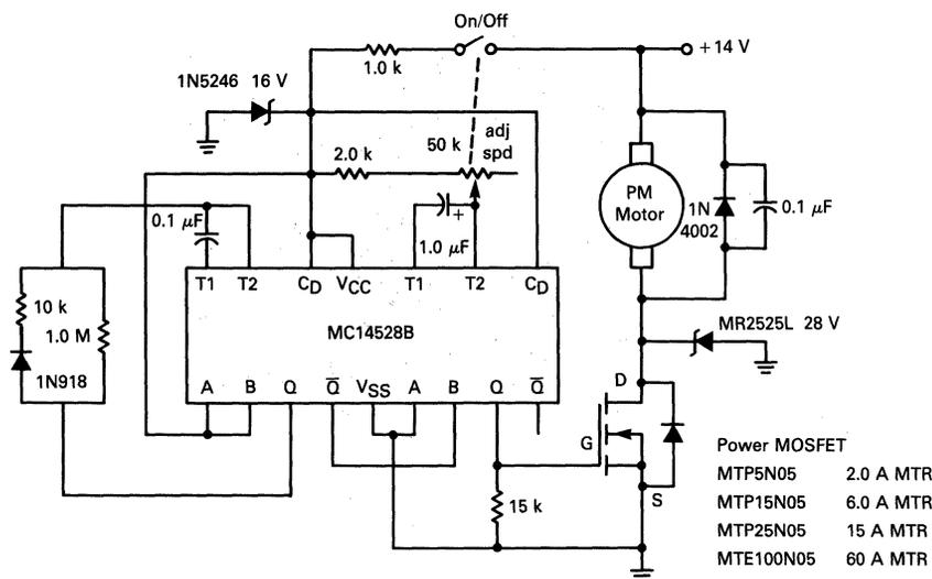
FIGURE 7-31 — POWER MOSFET MOTOR SPEED CONTROL CIRCUIT
