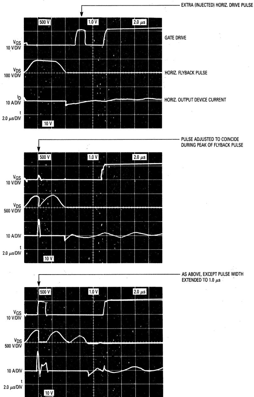
FIGURE 7-35 — HORIZONTAL DEFLECTION RETRACE PULSE TEST WAVEFORMS
