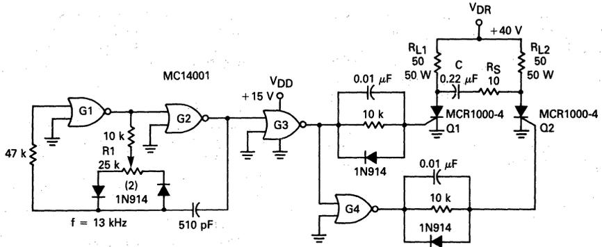
FIGURE 8-26 — POWER FLIP-FLOP USING MOS SCRs
