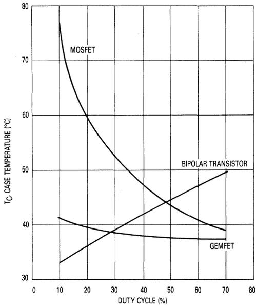
FIGURE 9-13 — ON-STATE EFFICIENCY COMPARISON — PWM OF DC MOTOR
