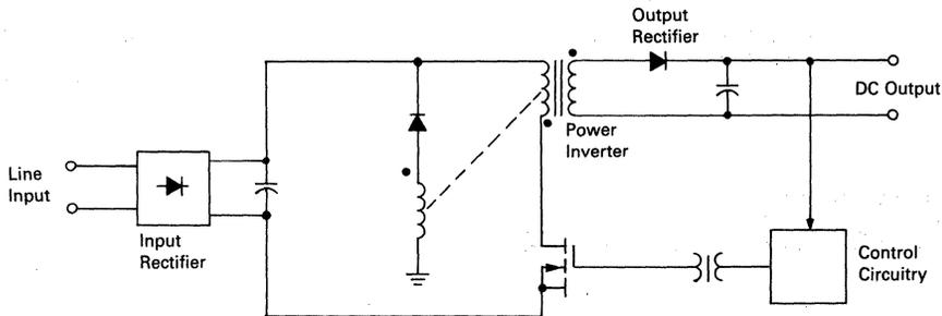
FIGURE 7-12 — BASIC FLYBACK CONFIGURATION
