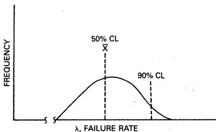
FIGURE 12-2 — CONFIDENCE LIMITS AND THE DISTRIBUTION OF SAMPLE FAILURE RATES
