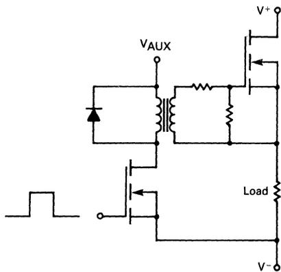
FIGURE 5-21 — PULSE TRANSFORMER DRIVER
