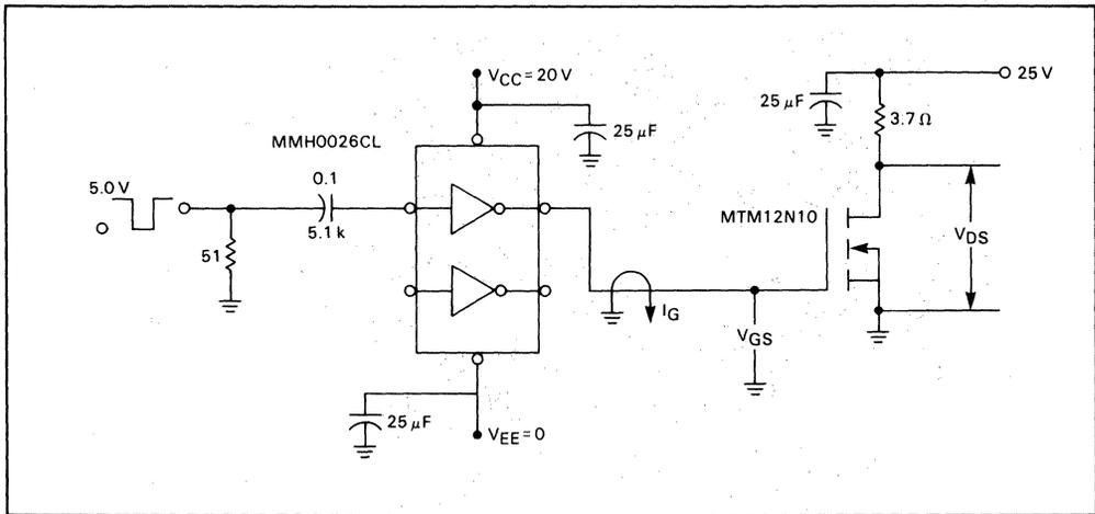
FIGURE 5-15 — MMH0026 CLOCK DRIVER AS A DRIVER FOR POWER MOSFET
