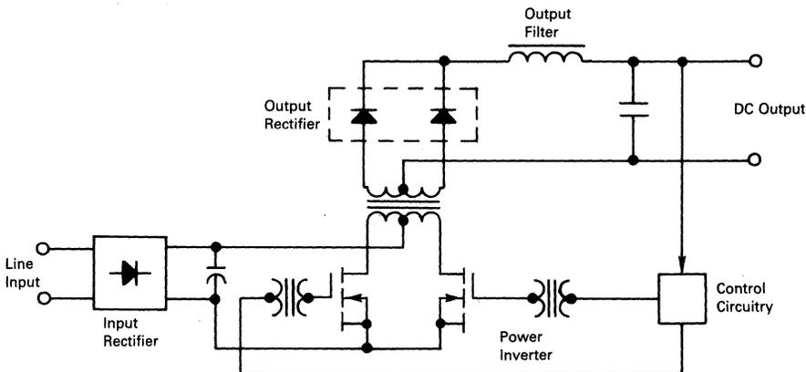
FIGURE 7-13 — BASIC PUSH-PULL CONFIGURATION
