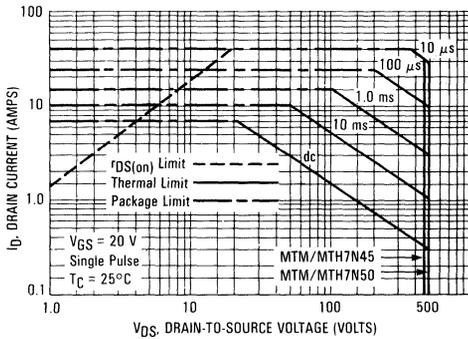
FIGURE 13 — MAXIMUM RATED FORWARD BIAS SAFE OPERATING AREA
