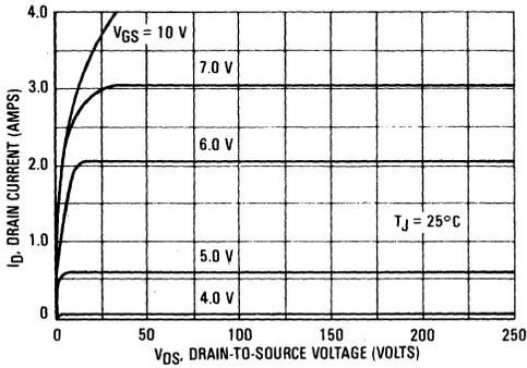
FIGURE 4 — ON-CHARACTERISTICS
