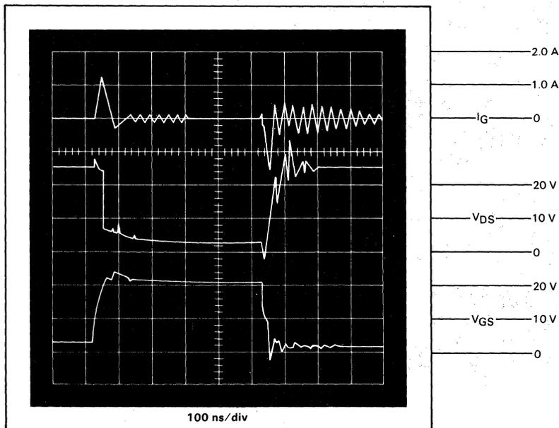
FIGURE 5-16 — POWER MOSFET SWITCHING WAVEFORMS WITH MMH0026 CLOCK DRIVER
