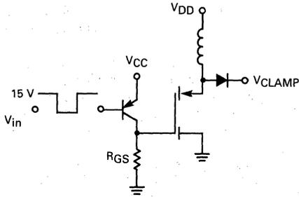
FIGURE 8-15 — GEMFET RBSOA GATE DRIVE CIRCUIT
