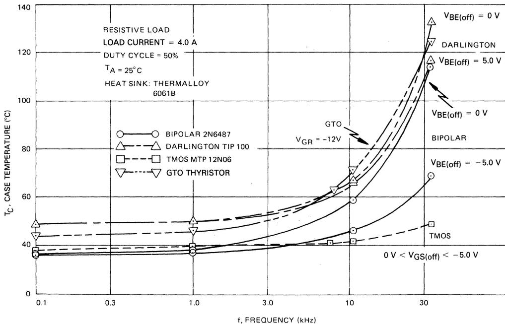
FIGURE 9-11 — TEMPERATURE RISE OF POWER SEMICONDUCTOR AS A FUNCTION OF FREQUENCY
