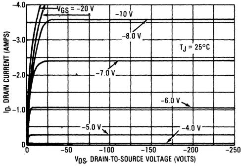
FIGURE 4 — ON-CHARACTERISTICS
