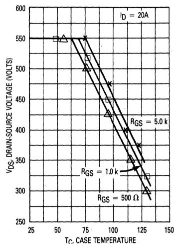
FIGURE 8-14 — EFFECT OF GATE DRIVE IMPEDANCE AND CASE TEMPERATURE ON GEMFET RBSOA
