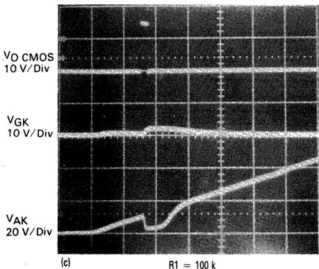
FIGURE 8-21 — MOS SCR TURN-ON WAVEFORMS
