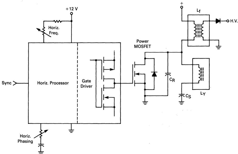
FIGURE 7-32 — POWER MOSFET HORIZONTAL OUTPUT SYSTEM
