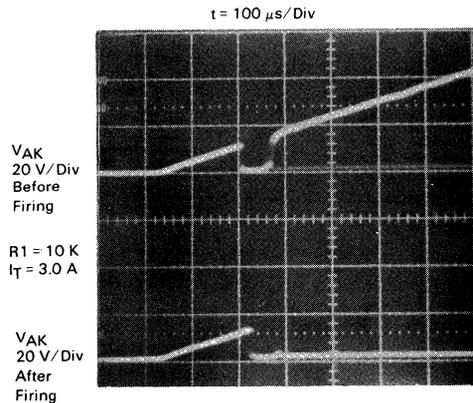
FIGURE 8-22 — ANODE-CATHODE VOLTAGE WAVEFORMS OF THE MOS SCR
