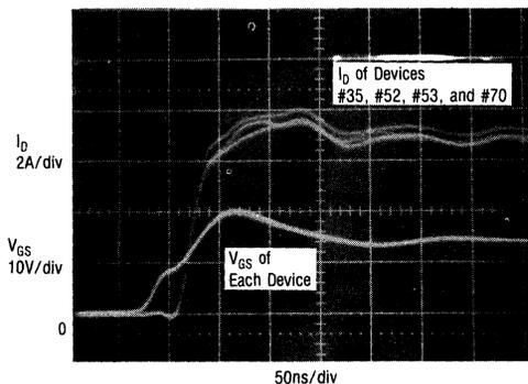
FIGURE 6-2a — PARALLELED TURN-ON
