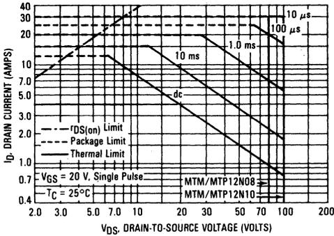
FIGURE 12 — MAXIMUM RATED FORWARD BIAS SAFE OPERATING AREA
