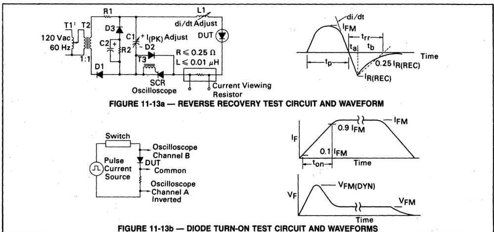
FIGURE 11-13a — REVERSE RECOVERY TEST CIRCUIT AND WAVEFORM
