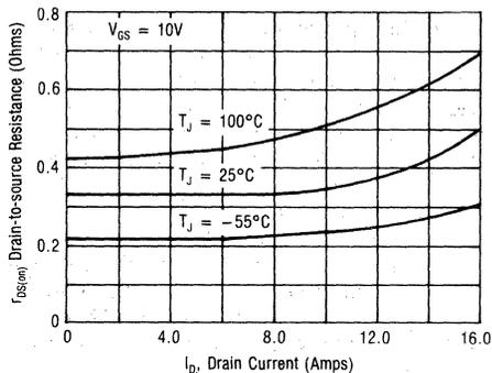
FIGURE 6-1 — ON-RESISTANCE versus DRAIN CURRENT — MTP8N18
