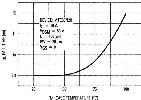
FIGURE 10-11 — FALL TIME versus CASE TEMPERATURE
