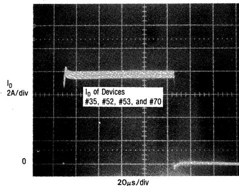
FIGURE 6-2c — COMPOSITE  $I_D$  WAVEFORM FOR TURN-ON AND TURN-OFF
