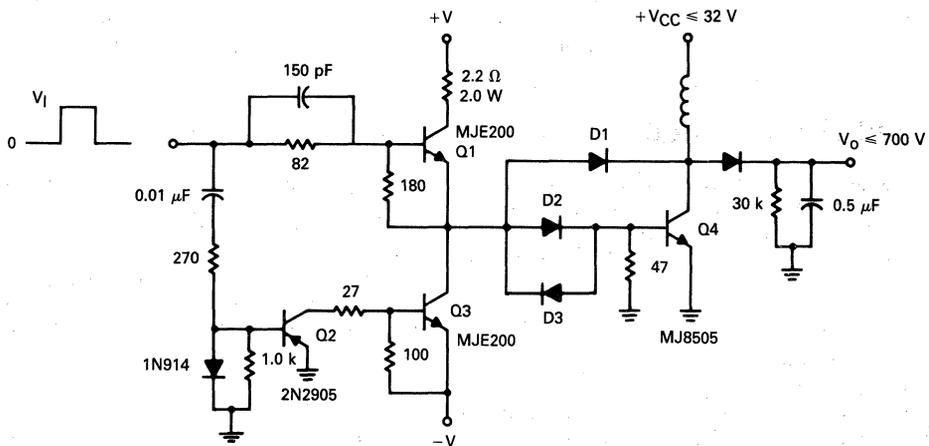
FIGURE 1-11 — BIPOLAR DRIVER AND OUTPUT STAGE
