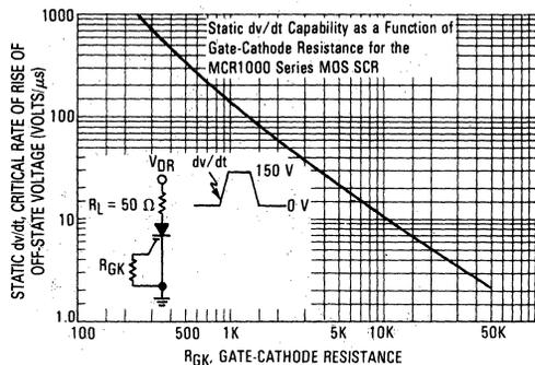
FIGURE 8-23 — TYPICAL  $dv/dt$  CAPABILITY OF THE MCR1000 MOS SCR
