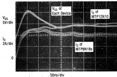
FIGURE 6-12a — PARALLELED TURN-ON
