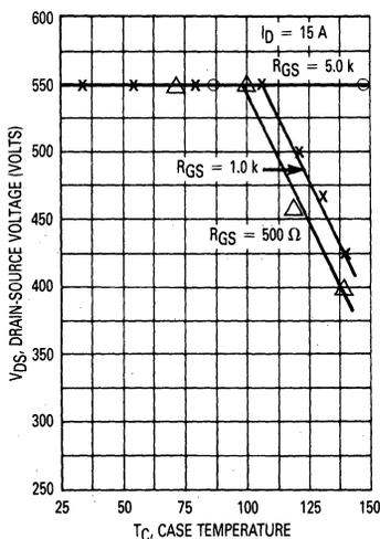
FIGURE 8-13 — EFFECT OF GATE DRIVE IMPEDANCE AND CASE TEMPERATURE ON GEMFET RBSOA
