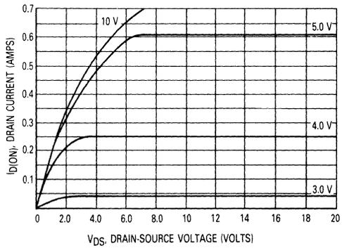
FIGURE 7 — SATURATION CHARACTERISTIC
