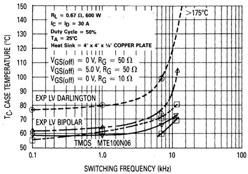
FIGURE 10-18 — CASE TEMPERATURE OF THE EMS PACKAGE FOR A RESISTIVE LOAD AS A FUNCTION OF FREQUENCY
