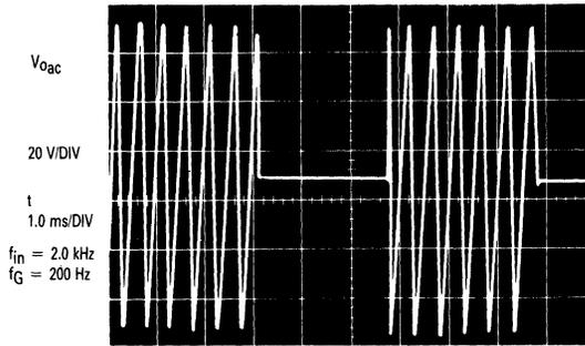
FIGURE 8-29 — OUTPUT WAVEFORM OF AC POWER SWITCH
