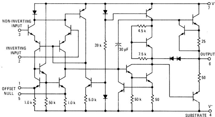
FIGURE 2 - OFFSET ADJUST CIRCUIT
