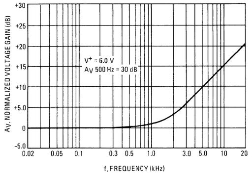
**FIGURE 8 – PLAYBACK VOLTAGE GAIN versus FREQUENCY**
