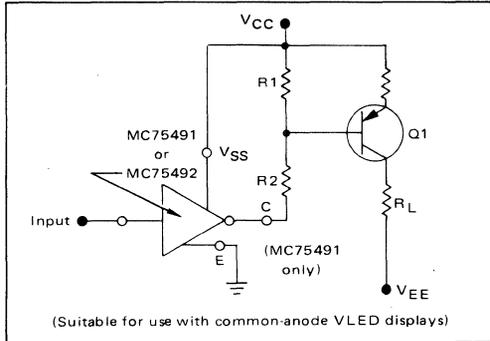
FIGURE 16 – BASE-EMITTER SELECT TRANSISTOR DRIVER
