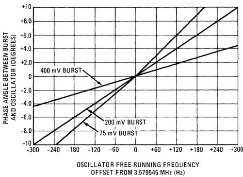
FIGURE 7 – PULL-IN FREQUENCY RANGE versus BURST INPUT VOLTAGE LEVEL
