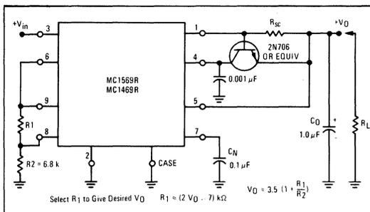
FIGURE 2 - TYPICAL NPN CURRENT BOOST CONNECTION
