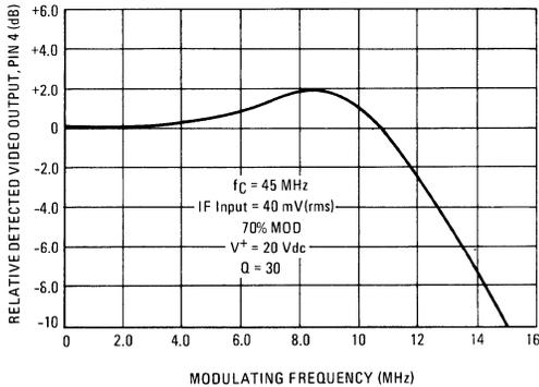
FIGURE 9 – CARRIER FREQUENCY PERFORMANCE
