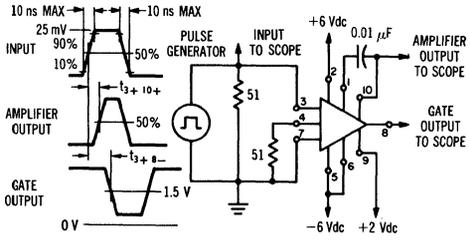
FIGURE 6 — PROPAGATION DELAY (STROBE INPUT)
