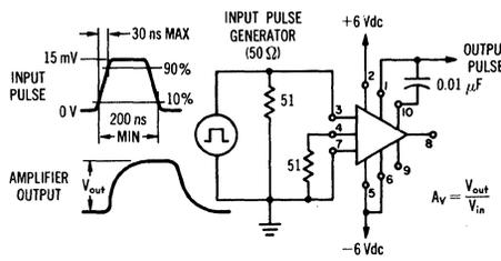
FIGURE 5 — PROPAGATION DELAY (STROBE HIGH)
