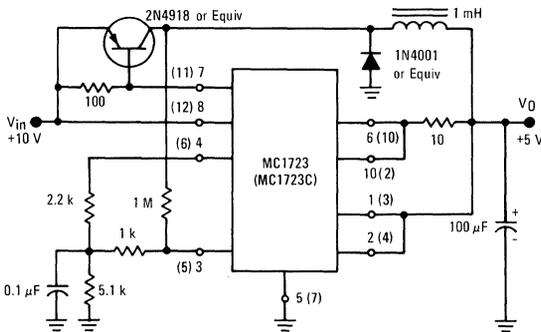
FIGURE 19 – +5 V, 1-AMPERE HIGH EFFICIENCY REGULATOR
