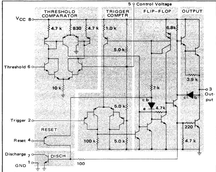
FIGURE 13 – CIRCUIT SCHEMATIC CONTROL VOLTAGE
