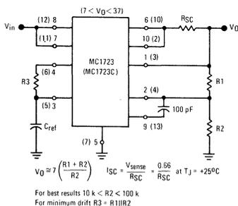
FIGURE 3 - TYPICAL NPN CURRENT BOOST CONNECTION
