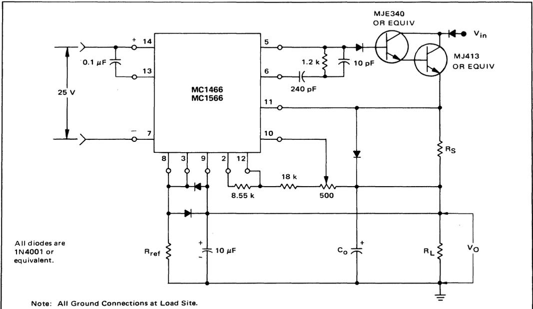
FIGURE 17 - A 0-TO-250 VOLT, 0.1-AMPERE REGULATOR
