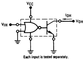
FIGURE 2 –  $V_{IL}$ ,  $V_{OL}$
