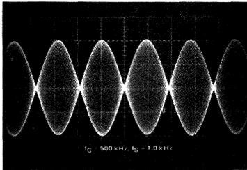
FIGURE 3 - SUPPRESSED-CARRIER SPECTRUM
