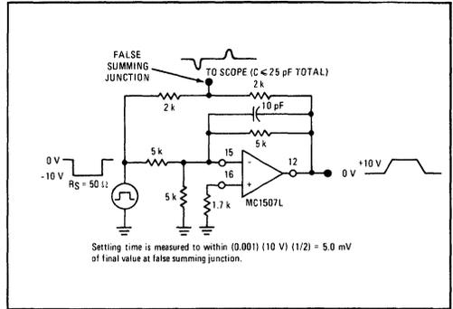
FIGURE 10 – PROPAGATION DELAY TIME TEST CIRCUIT
