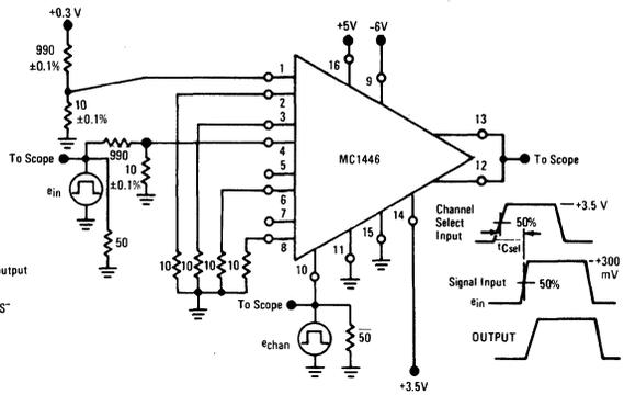
TYPICAL RECOVERY TIME WAVEFORMS
