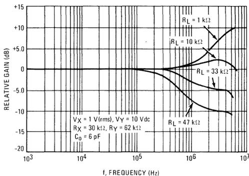
FIGURE 11 – LARGE SIGNAL VOLTAGE versus FREQUENCY
