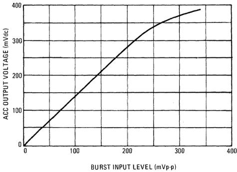
FIGURE 9 – OSCILLATOR SENSITIVITY
