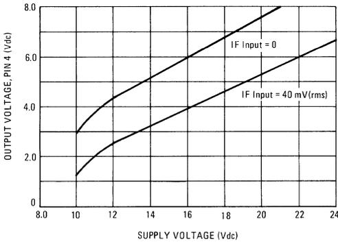
FIGURE 7 – DETECTOR LINEARITY
