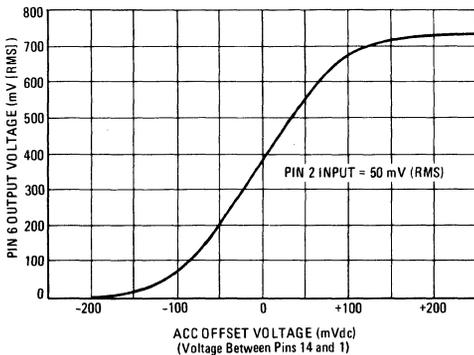
FIGURE 5 – AMPLIFIER LINEARITY
