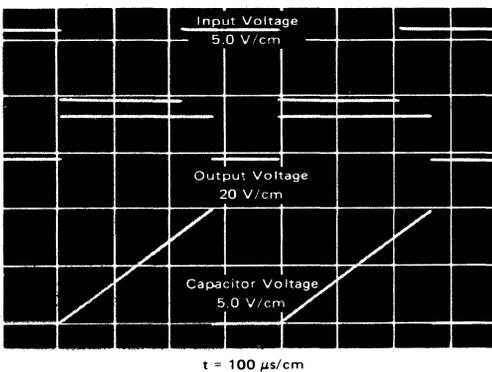
FIGURE 23 – MISSING PULSE DETECTOR WAVEFORMS
