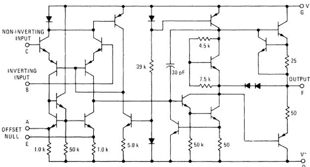
FIGURE 2 - OFFSET ADJUST CIRCUIT
