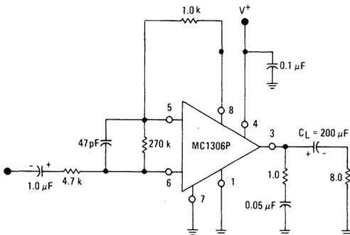
FIGURE 4 – ZERO SIGNAL BIAS CURRENT
