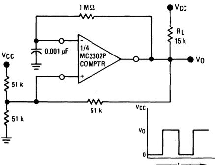
**FIGURE 7 – TIME DELAY GENERATOR**
