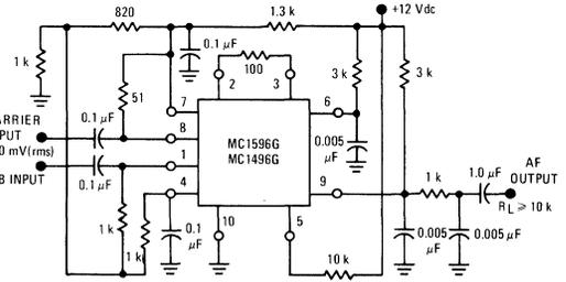
**FIGURE 30 – DOUBLY BALANCED MIXER (BROADBAND INPUTS, 9.0 MHz TUNED OUTPUT)**
