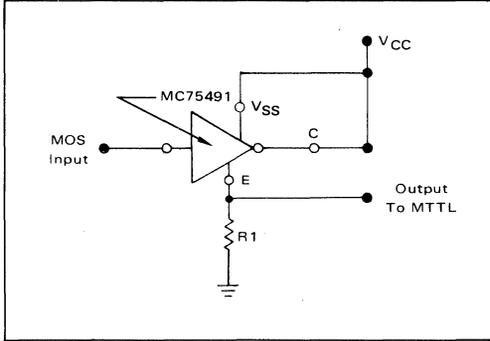
FIGURE 14 – QUAD HIGH-CURRENT NPN TRANSISTOR DRIVER
