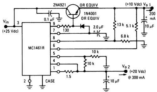
FIGURE 18 - NPN CURRENT BOOST CIRCUITS
