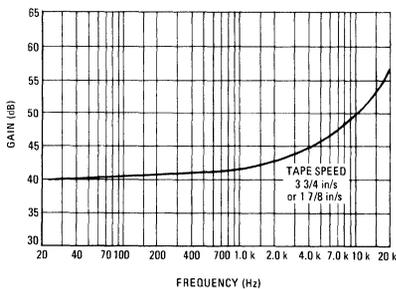
FIGURE 10 – TAPE RECORD PREAMPLIFIER
