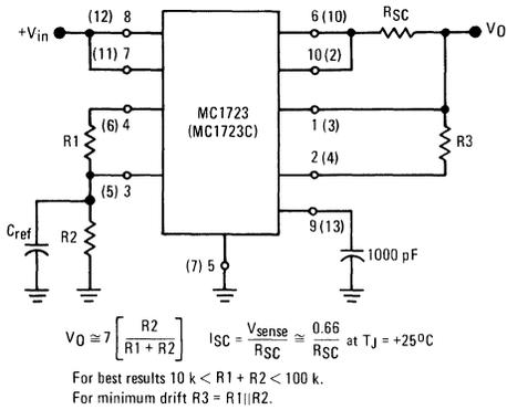
FIGURE 17 – MC1723,C FOLDBACK CONNECTION
