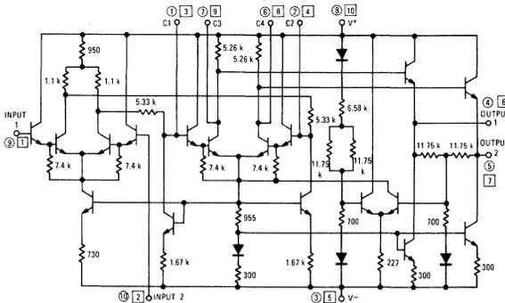
**FIGURE 2 - EQUIVALENT CIRCUIT**
