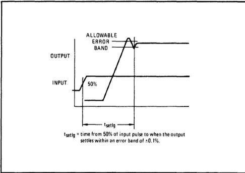
FIGURE 9 – AMPLIFIER PROPAGATION DELAY WAVEFORMS
