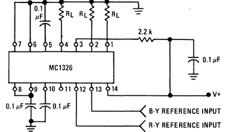
FIGURE 4 — DYNAMIC TEST CIRCUIT
