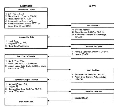
Figure 4-9. Read-Modify-Write Cycle Flowchart
