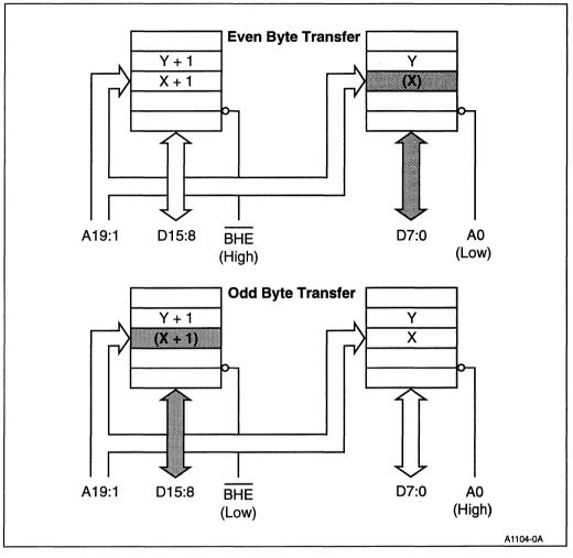
Figure 3-2. 16-Bit Data Bus Byte Transfers
