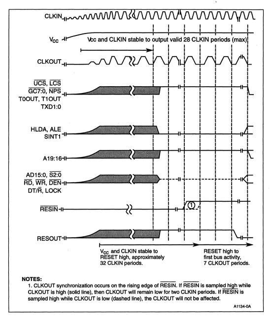
Figure 5-6. Cold Reset Waveform
