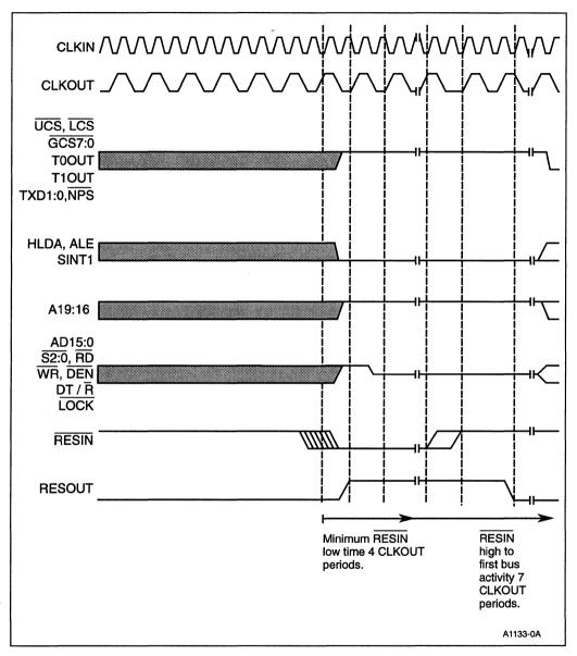
Figure 5-7. Warm Reset Waveform
