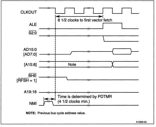
Figure 3-28. Exiting HALT (Powerdown Mode)
