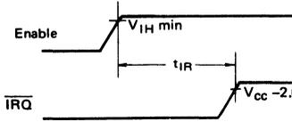
Figure 9  $\overline{\text{IRQ}}$  Release Time
