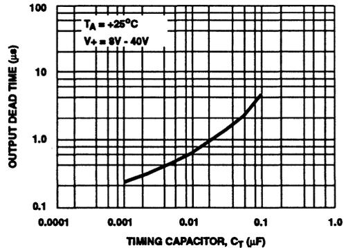
FIGURE 8. TYPICAL OUTPUT STAGE DEAD TIME AS A FUNCTION OF TIMING CAPACITOR VALUE
