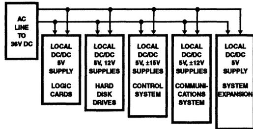
FIGURE 1. AN EXAMPLE OF A DISTRIBUTED POWER SYSTEM
