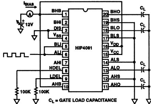
FIGURE 7. LOW VOLTAGE POWER DISSIPATION TEST CIRCUIT
