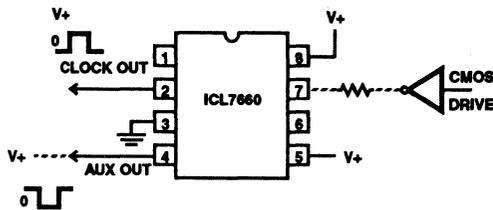
FIGURE 23. HIGH POWER CLOCK DRIVE
