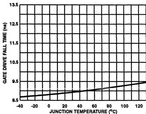
FIGURE 20. GATE DRIVE FALL TIME  $T_F$  vs TEMPERATURE
