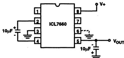
FIGURE 6. SIMPLE NEGATIVE CONVERTER
