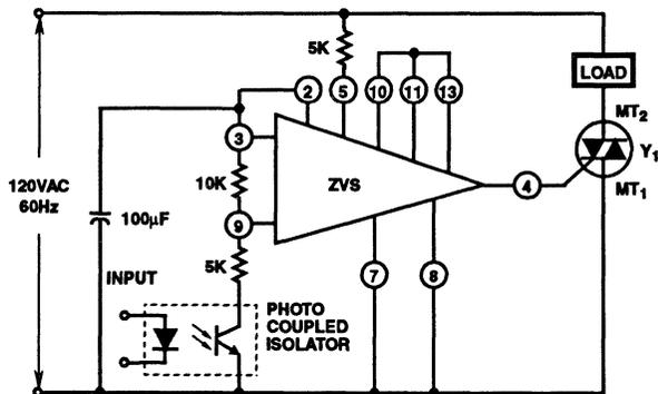
**FIGURE 28. ZERO-VOLTAGE SWITCH, ON/OFF CONTROLLER WITH PHOTOCOUPLER**
