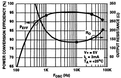
FIGURE 4. POWER CONVERSION EFFICIENCY AND OUTPUT SOURCE RESISTANCE AS A FUNCTION OF OSCILLATOR FREQUENCY
