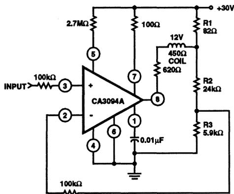
FIGURE 20. PRECISION SCHMITT POWER TRIGGER CIRCUIT
