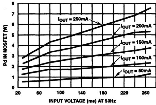
FIGURE 10. MOSFET POWER DISSIPATION 5V
