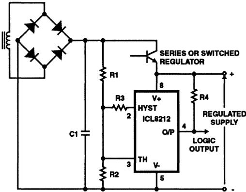
FIGURE 21. SIMPLE POWER FAIL SYSTEM
