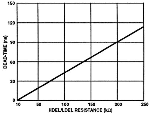
FIGURE 31. MINIMUM DEAD-TIME vs DEL RESISTANCE
