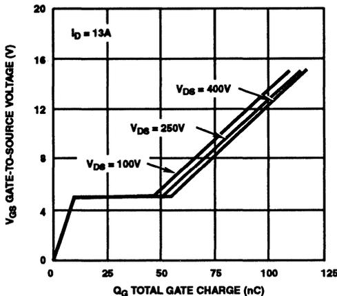
FIGURE 7. GATE CHARGE vs VOLTAGE
