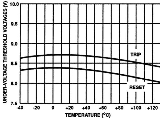
FIGURE 14. LOW-SIDE UNDERVOLTAGE THRESHOLD VOLTAGE (TRIP/RESET) vs TEMPERATURE
