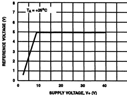
FIGURE 7. TYPICAL REFERENCE VOLTAGE AS A FUNCTION OF SUPPLY VOLTAGE
