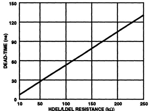
FIGURE 4. MINIMUM DEAD-TIME vs DEL RESISTANCE
