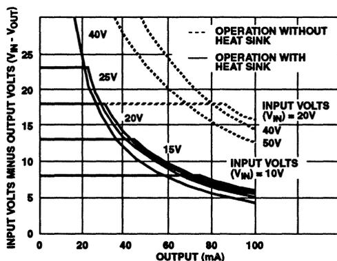
FIGURE 5. DISSIPATION LIMITATION (V<sub>I</sub> - V<sub>O</sub> vs I<sub>O</sub>) FOR CA3085 SERIES CIRCUITS
