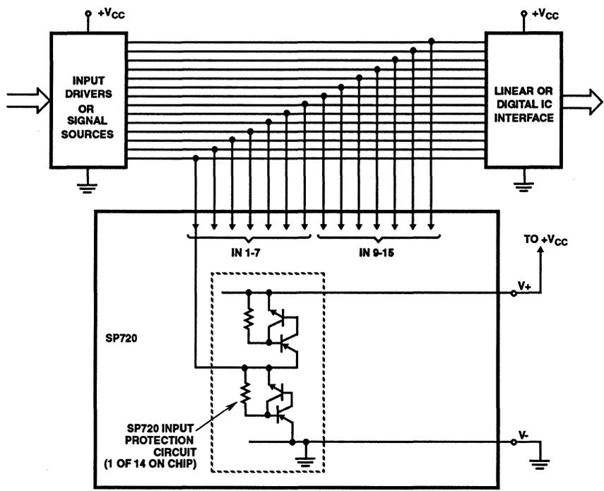
FIGURE 4. TYPICAL APPLICATION OF THE SP720 AS AN INPUT CLAMP FOR OVER-VOLTAGE, GREATER THAN  $1V_{BE}$  ABOVE  $V_+$  OR LESS THAN  $-1V_{BE}$  BELOW  $V_-$ . PINOUT SHOWN IS FOR THE SP720MD PDIP PACKAGE.
