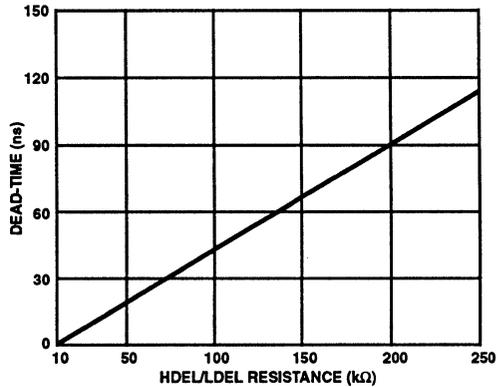
FIGURE 29. MINIMUM DEAD-TIME vs DEL RESISTANCE
