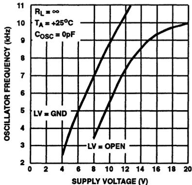
FIGURE 5. OSCILLATOR FREQUENCY vs SUPPLY VOLTAGE
