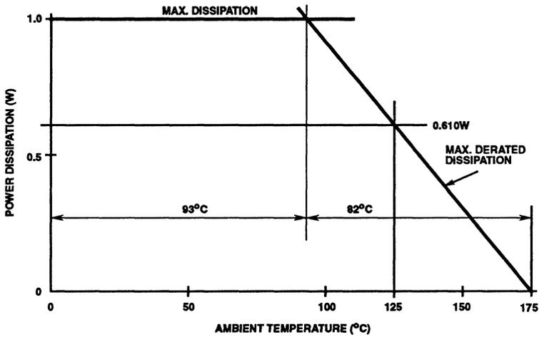
FIGURE 5. SP720MD DERATING CURVE FOR THE 82°C/W THERMAL RESISTANCE OF THE SIDEBRAZE 16 PIN CERAMIC PACKAGE, DERATED 12.2mW/°C FROM A MAXIMUM P<sub>D</sub> OF 1.0W AT 93°C
