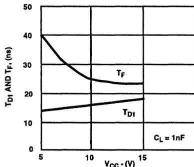
FIGURE 7. DELAY AND FALL TIMES vs V<sub>CC</sub>
