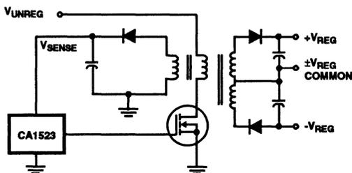
FIGURE 2A. LINE ISOLATED FLYBACK CONVERTER
