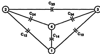
FIGURE 8. CAPACITOR NETWORK REPRESENTATION OF THE POWER MOSFET
