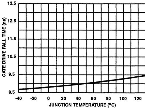
FIGURE 22. GATE DRIVE FALL TIME  $T_F$  vs TEMPERATURE
