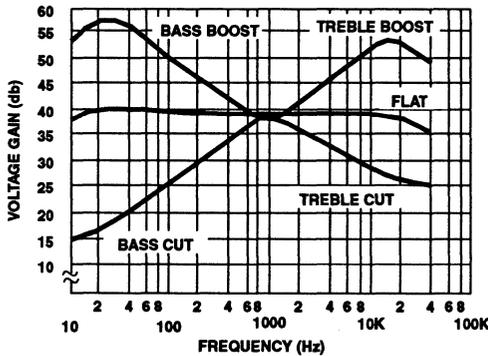
FIGURE 9. VOLTAGE GAIN vs FREQUENCY
