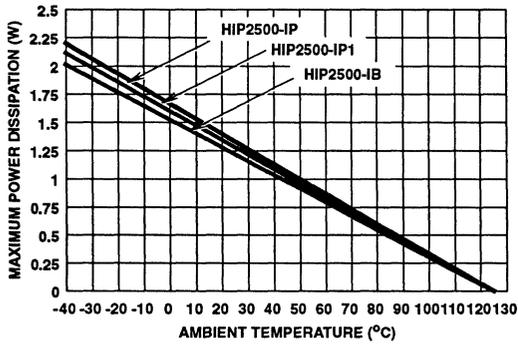
FIGURE 1. MAXIMUM POWER DISSIPATION vs TEMPERATURE
