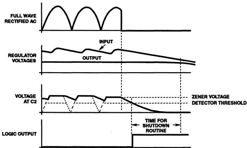
FIGURE 24. IMPROVED POWER FAIL SYSTEM WAVEFORMS
