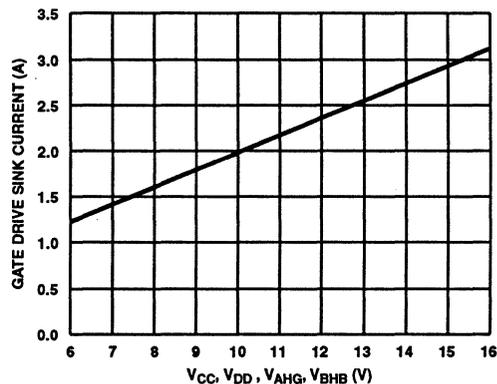
FIGURE 27. PEAK PULLDOWN CURRENT  $I_O$ , BIAS SUPPLY VOLTAGE
