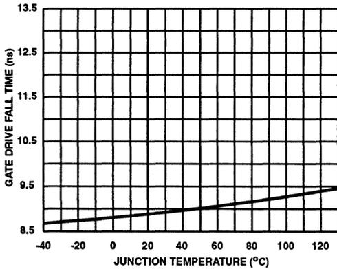
FIGURE 22. GATE DRIVE FALL TIME  $T_F$  vs TEMPERATURE
