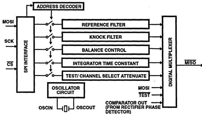
**FIGURE 5. DIGITAL BLOCK DIAGRAM**
