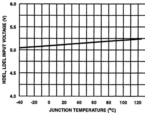
FIGURE 24.  $V_{LDEL}$ ,  $V_{HDEL}$  VOLTAGE vs TEMPERATURE
