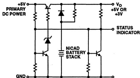
FIGURE 6. DISCRETE BATTERY BACKUP CIRCUIT
