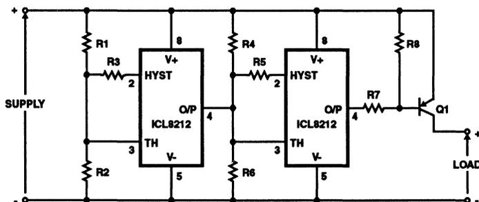
**FIGURE 20. POWER SUPPLY WINDOW DETECTOR**
