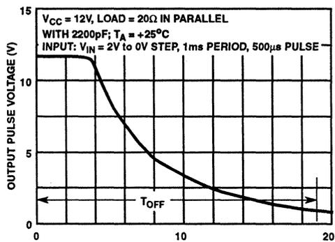
FIGURE 3B. OUTPUT TURN-OFF TIME ( $\mu s$ )
