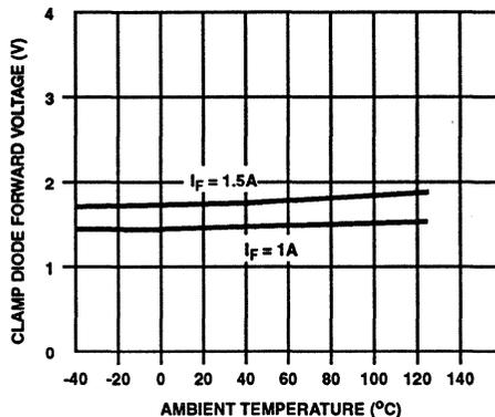
FIGURE 5D. TYPICAL CLAMP-DIODE FORWARD VOLTAGE CHARACTERISTICS
