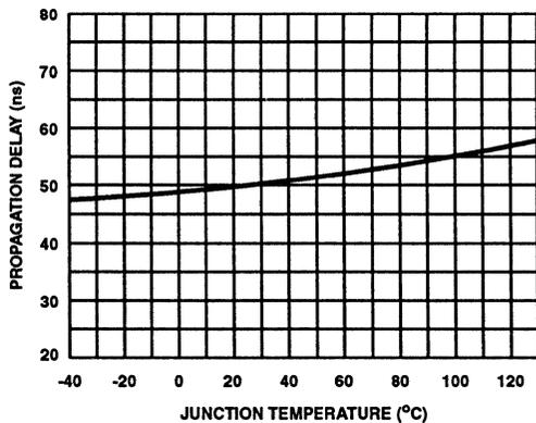
FIGURE 19. LOWER TURN-ON PROPAGATION DELAY  $T_{LPLH}$  vs TEMPERATURE
