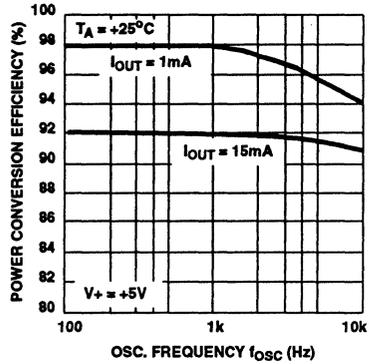
FIGURE 4. POWER CONVERSION EFFICIENCY AS A FUNCTION OF OSC. FREQUENCY
