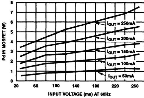
FIGURE 9. MOSFET POWER DISSIPATION 5V
