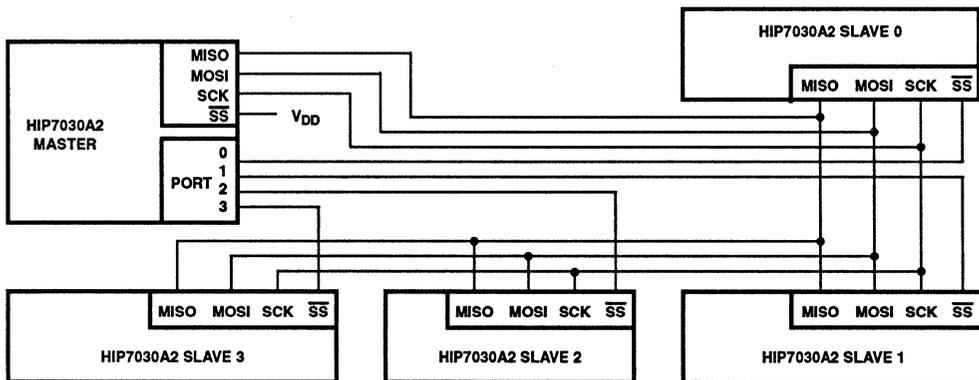
FIGURE 20. MASTER-SLAVE SYSTEM CONFIGURATION (SINGLE MASTER, FOUR SLAVES)
