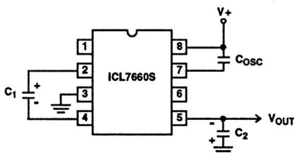
FIGURE 19. LOWERING OSCILLATOR FREQUENCY
