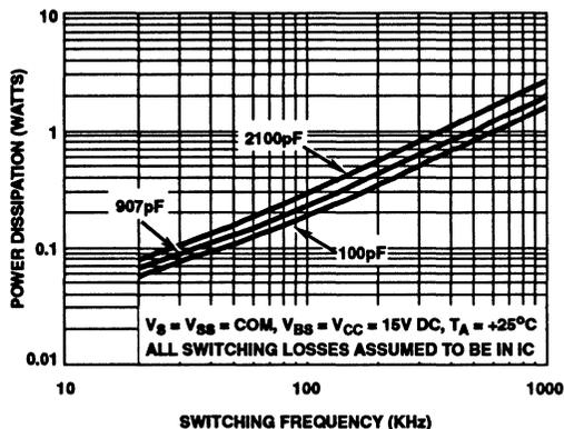
FIGURE 9. LOW VOLTAGE POWER DISSIPATION vs FREQUENCY
