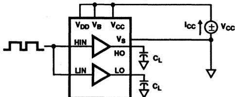
FIGURE 8. LOW VOLTAGE POWER DISSIPATION TEST CIRCUIT
