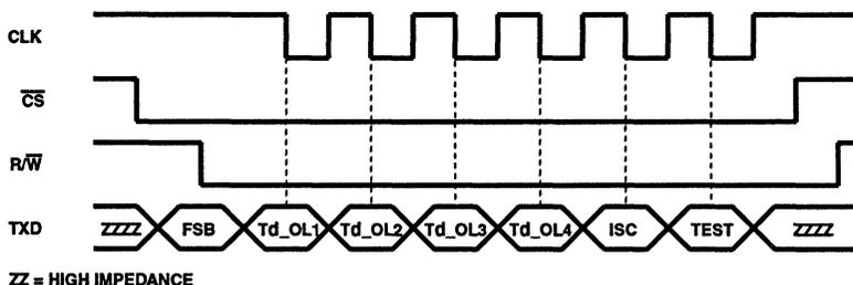
FIGURE 3. SERIAL INTERFACE WRITE OPERATION
