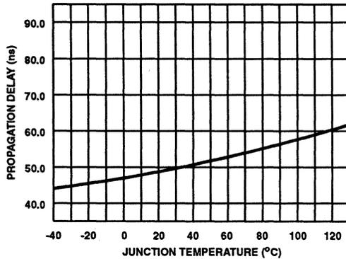
FIGURE 18. UPPER TURN-OFF PROPAGATION DELAY  $T_{HPL}$  vs TEMPERATURE
