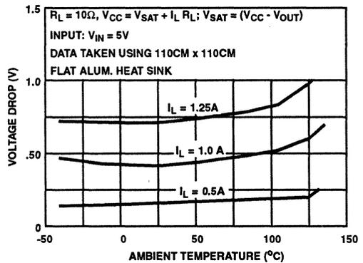
FIGURE 2. TYPICAL FORWARD VOLTAGE DROP,  $V_{SAT}$  CHARACTERISTICS vs AMBIENT OPERATING TEMPERATURE
