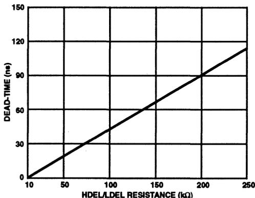
FIGURE 5. MINIMUM DEAD-TIME vs DEL RESISTANCE
