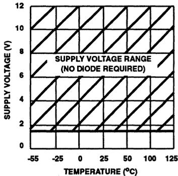
FIGURE 1. OPERATING VOLTAGE AS A FUNCTION OF TEMPERATURE
