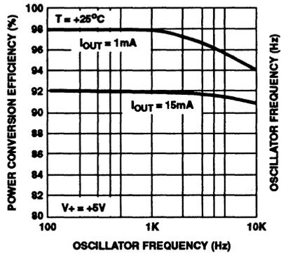
FIGURE 10. EFFICIENCY CHANGE WITH OSCILLATOR FREQUENCY
