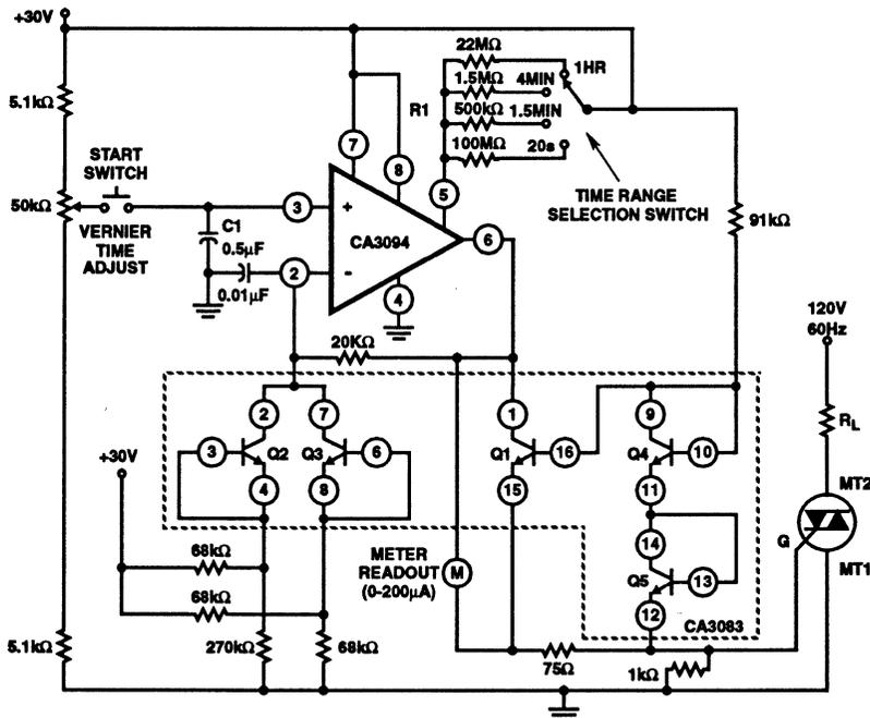
FIGURE 24. PRESETTABLE TIMER WITH LINEAR READOUT
