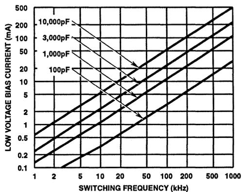
FIGURE 27. LOW VOLTAGE BIAS CURRENT  $I_{DD}$  (LESS QUIESCIENT COMPONENT) vs FREQUENCY AND GATE LOAD CAPACITANCE
