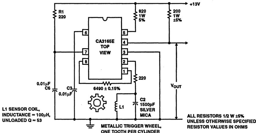
FIGURE 6. TYPICAL IGNITION SYSTEM USING THE CA3165E
