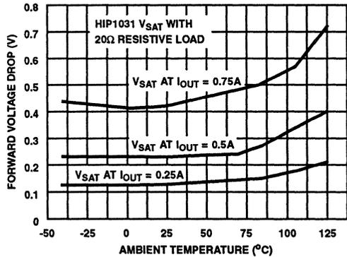
FIGURE 2. TYPICAL V<sub>SAT</sub> CHARACTERISTIC vs TEMPERATURE
