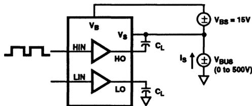
FIGURE 10. HIGH VOLTAGE POWER DISSIPATION TEST CIRCUIT
