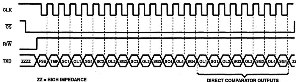
FIGURE 2. SERIAL INTERFACE READ OPERATION
