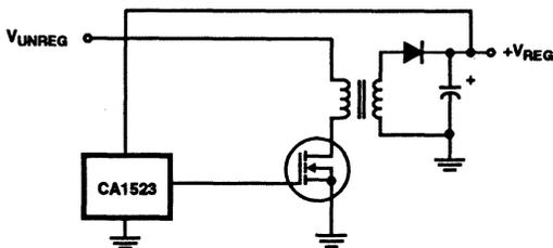
FIGURE 2B. NON-ISOLATED FLYBACK CONVERTER
