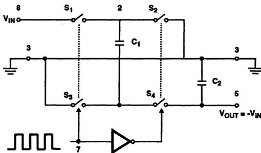
FIGURE 12. IDEALIZED NEGATIVE VOLTAGE CONVERTER
