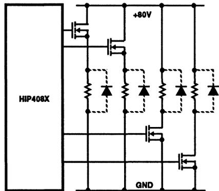
FIGURE 2. HIP4080A AS LAMP SWITCH DRIVER, DUAL HIGH/LOW SWITCHES FOR AUTOMOTIVE AND INDUS-
