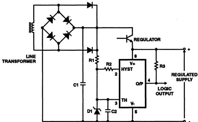
FIGURE 23. IMPROVED POWER FAIL SYSTEM
