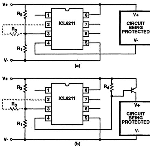
FIGURE 35. HIGH VOLTAGE DUMP CIRCUITS
