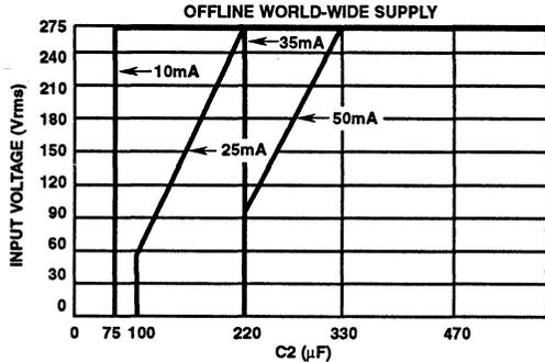
FIGURE 4. MINIMUM C2 VALUE vs INPUT VOLTAGE
