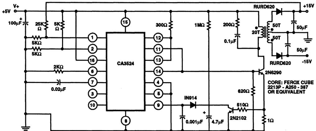
FIGURE 36. FLYBACK CONVERTER CIRCUIT
