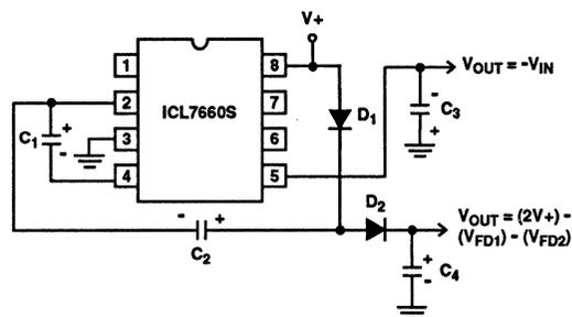
FIGURE 21. COMBINED NEGATIVE VOLTAGE CONVERTER AND POSITIVE DOUBLER
