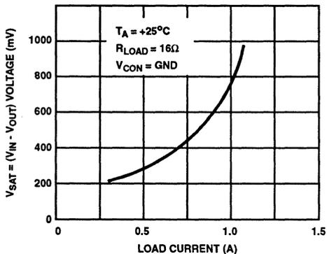
FIGURE 7. SATURATION (V<sub>IN</sub> - V<sub>OUT</sub>) CHARACTERISTIC
