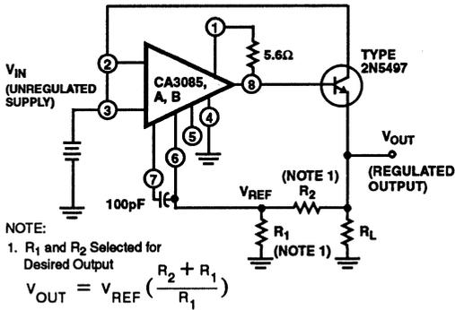
FIGURE 17. TYPICAL HIGH CURRENT VOLTAGE REGULATOR CIRCUIT
