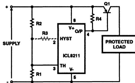
FIGURE 16. HIGH VOLTAGE DUMP CIRCUIT
