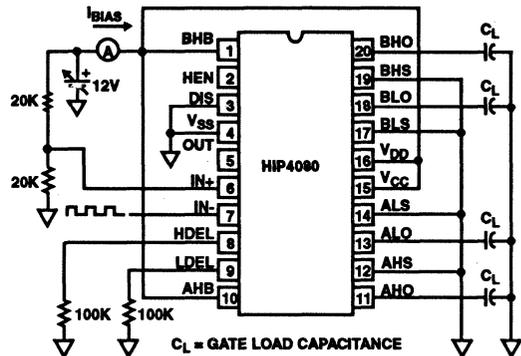
FIGURE 8. LOW VOLTAGE POWER DISSIPATION TEST CIRCUIT
