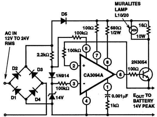
FIGURE 31. BATTERY CHARGER REGULATOR CIRCUIT
