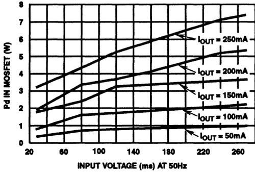
FIGURE 12. MOSFET POWER DISSIPATION 24V
