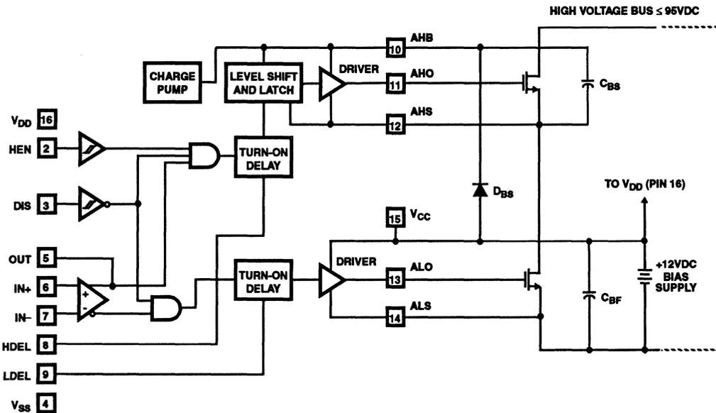
FIGURE 4. HIP4080 BLOCK DIAGRAM (A SIDE ONLY)
