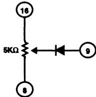
FIGURE 9. CIRCUIT FOR EXPANSION OF DEAD TIME
