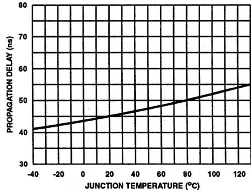
FIGURE 13. LOWER DISABLE TURN-OFF PROPAGATION DELAY  $T_{DISLO}$  vs TEMPERATURE
