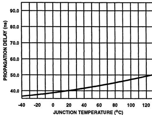
FIGURE 20. LOWER TURN-OFF PROPAGATION DELAY  $T_{LPL}$  vs TEMPERATURE
