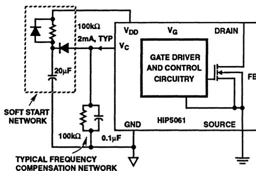
FIGURE 35. SOFT START CIRCUIT FOR THE HIP5061
