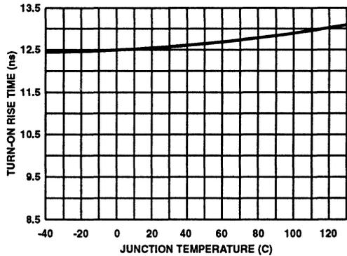
FIGURE 23. GATE DRIVE RISE TIME  $T_R$  vs TEMPERATURE
