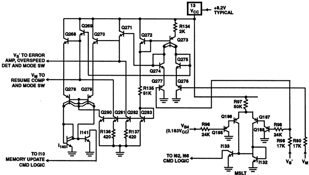
FIGURE 11. V<sub>S'</sub> AND V<sub>M</sub> BUFFERS WITH MEMORY UPDATE COMPARATOR AND MINIMUM SPEED LOCKOUT COMPARATOR (MSLT)
