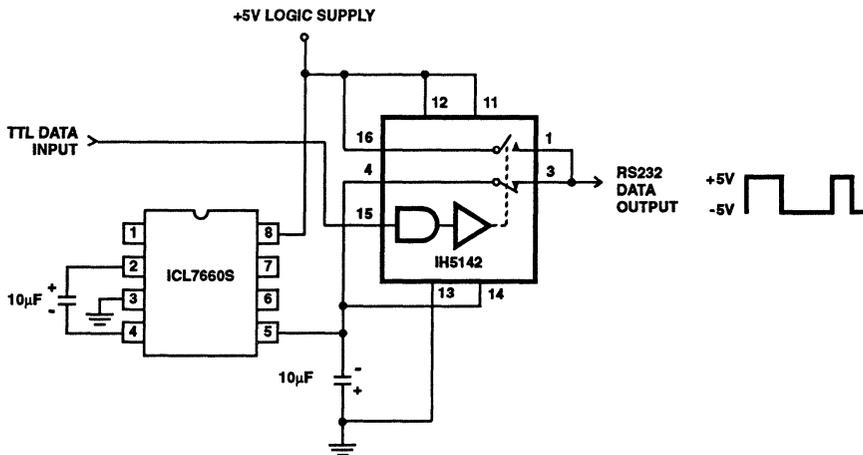
FIGURE 24. RS232 LEVELS FROM A SINGLE 5V SUPPLY
