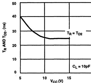
FIGURE 8. RISE TIME vs V<sub>CC</sub>
