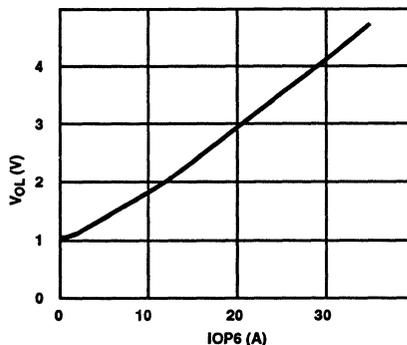
FIGURE 6.  $V_{OL}$  vs  $I_{OP6}$  (5 $\mu\text{s}$  PULSES)
