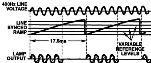
FIGURE 47. WAVEFORMS FOR 400Hz ZERO-VOLTAGE SWITCHED LAMP DIMMER
