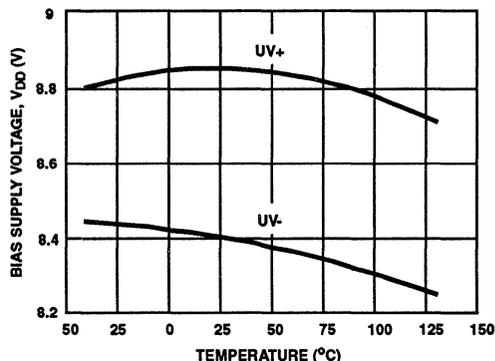
FIGURE 31. UNDERVOLTAGE LOCKOUT vs TEMPERATURE
