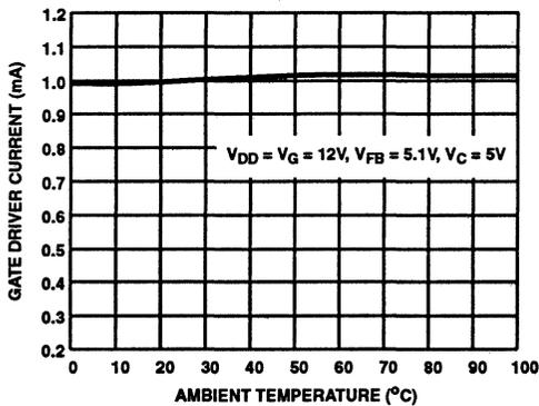
FIGURE 5. TYPICAL GATE DRIVER OPERATING CURRENT vs TEMPERATURE
