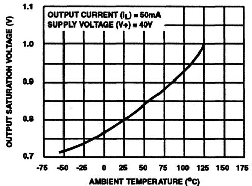
FIGURE 15. TYPICAL OUTPUT SATURATION VOLTAGE AS FUNCTION OF AMBIENT TEMPERATURE
