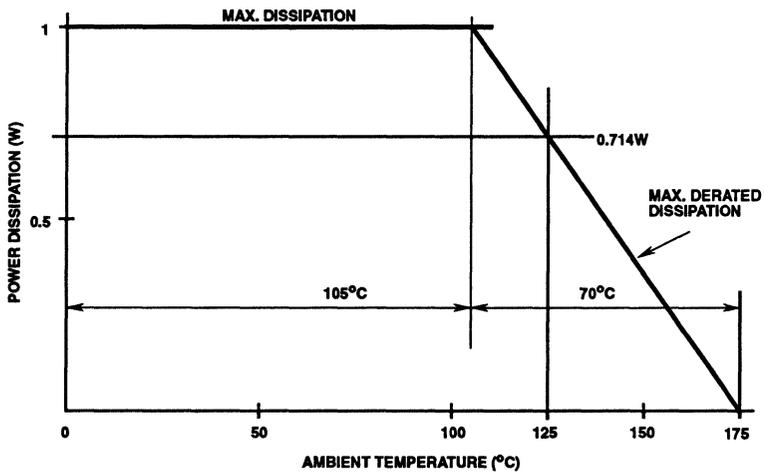
FIGURE 6. SP720MM DERATING CURVE FOR THE 70°C/W THERMAL RESISTANCE OF THE 20 PAD CERAMIC LCC PACKAGE, DERATED 14.3mW/°C FROM A MAXIMUM P<sub>D</sub> OF 1.0W AT 105°C
