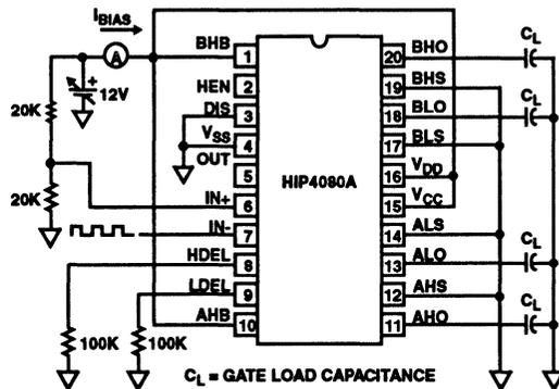
FIGURE 8. LOW VOLTAGE POWER DISSIPATION TEST CIRCUIT
