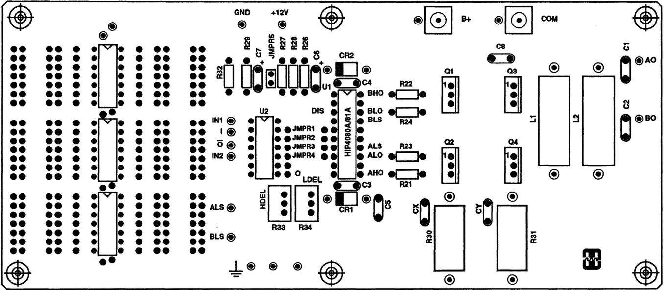
FIGURE 13. HIP4080A EVALUATION BOARD SILKSCREEN
