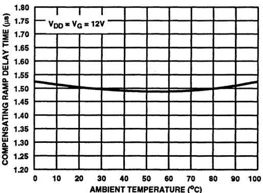
FIGURE 31. TYPICAL COMPENSATION RAMP DELAY TIME vs TEMPERATURE
