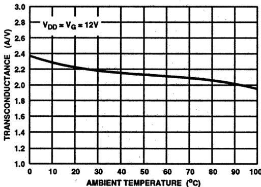
FIGURE 25. TYPICAL TRANSCONDUCTANCE FROM V<sub>C</sub> PIN TO DMOS TRANSISTOR DRAIN (PEAK CURRENT) vs TEMPERATURE
