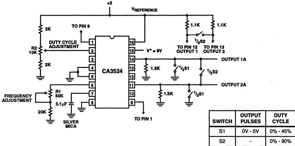
**FIGURE 22. LOW-FREQUENCY PULSE GENERATOR**
