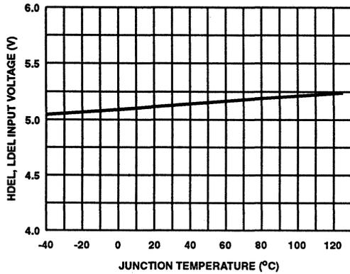
FIGURE 22.  $V_{LDEL}$ ,  $V_{HDEL}$  VOLTAGE vs TEMPERATURE
