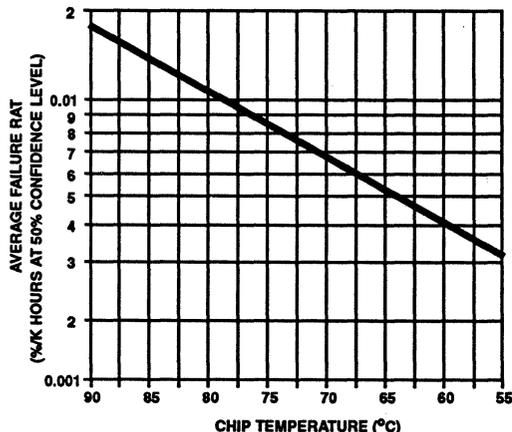
FIGURE 8. RELIABILITY OF POWER ASIC CHIP AT 60,000 OPERATING HOURS
