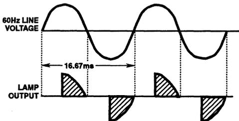
FIGURE 46. WAVEFORMS FOR 60Hz PHASE CONTROLLED LAMP DIMMER
