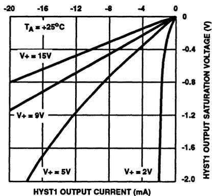
FIGURE 3. HYST1 OUTPUT SATURATION VOLTAGE vs HYST1 OUTPUT CURRENT
