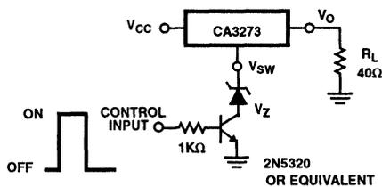
FIGURE 3. OPTIONAL RANGE SHIFTING OF THE  $V_{CC}$  INPUT VOLTAGE USING A ZENER DIODE TO OFFSET THE  $V_{sw}$  CONTROL PIN. (I.E.,THE OVER-VOLTAGE SHUTDOWN THRESHOLD WILL BE INCREASED TO  $V_{CC(THD)} + V_z$  AND THE MINIMUM  $V_{CC}$  OPERATING VOLTAGE IS  $V_z + 4V$ ).
