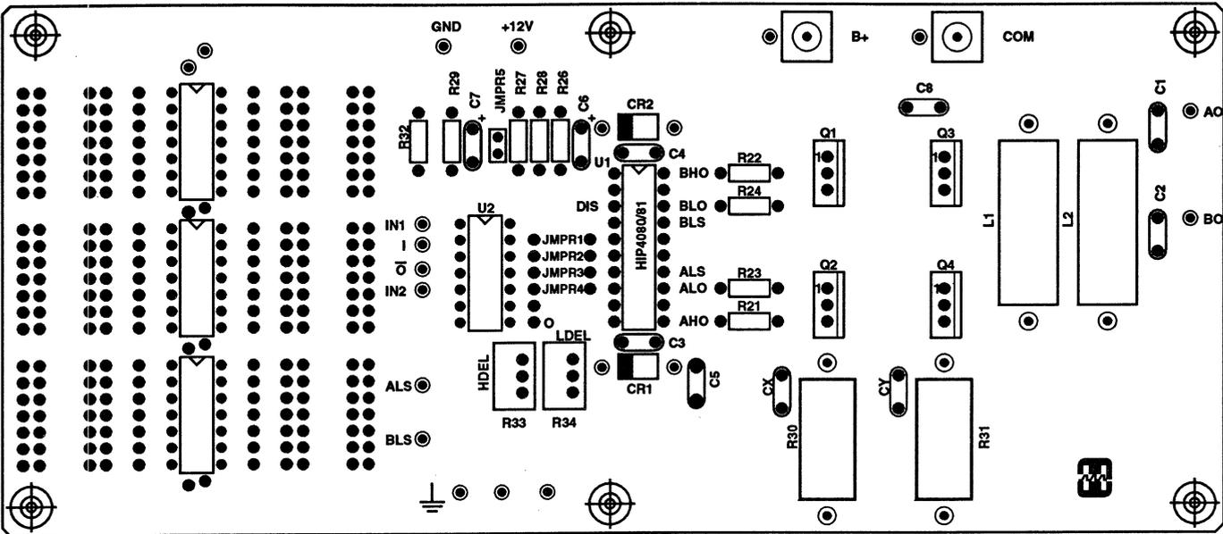
FIGURE 34. HIP4080A EVALUATION BOARD SILKSCREEN
