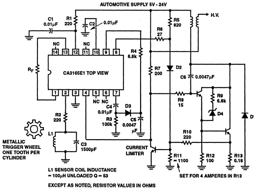
FIGURE 5. TYPICAL IGNITION SYSTEMS USING THE CA3165E1
