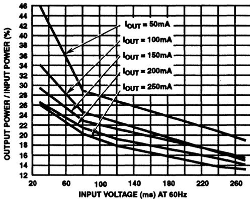
FIGURE 13. EFFICIENCY OF HV-2405E HIGH CURRENT CIRCUIT 5V
