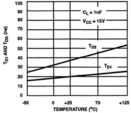
FIGURE 2.  $T_{D1}$ ,  $T_{D2}$  vs TEMPERATURE
