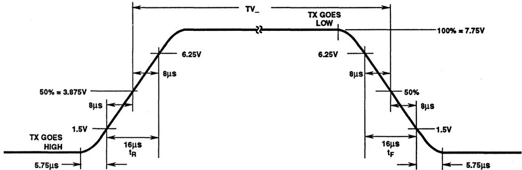
FIGURE 1. J1850 BUS WAVEFORM
