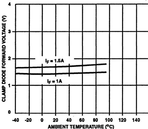
FIGURE 4D. TYPICAL CLAMP-DIODE FORWARD VOLTAGE CHARACTERISTICS
