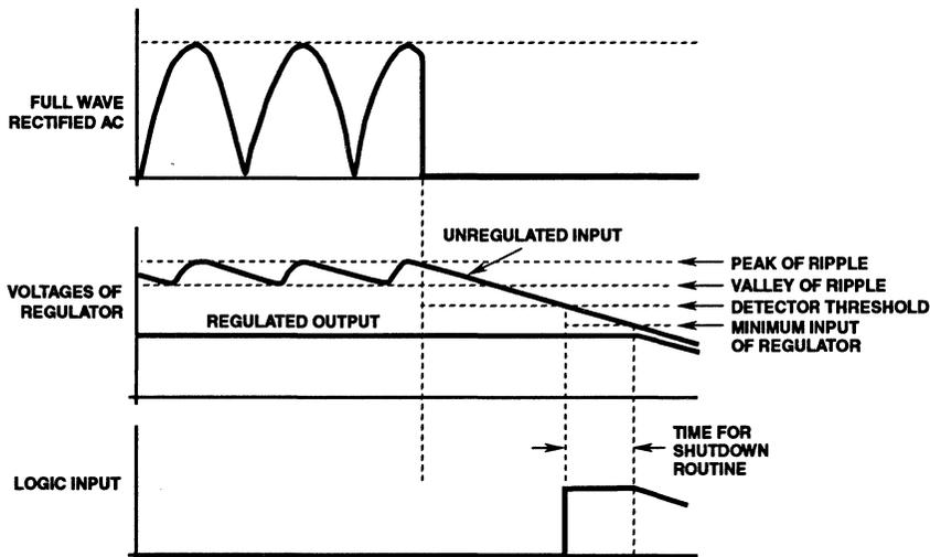
FIGURE 22. SIMPLE POWER FAIL SYSTEM WAVEFORMS
