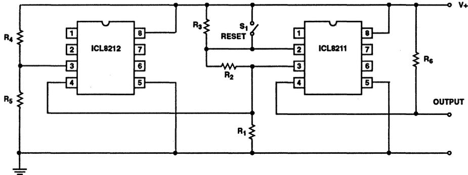
FIGURE 30. NON-VOLATILE POWER SUPPLY MALFUNCTION RECORDER
