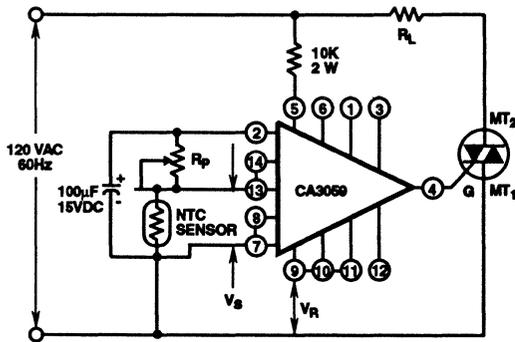
FIGURE 29. CA3059 ON/OFF TEMP. CONTROLLER
