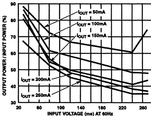
FIGURE 15. EFFICIENCY OF HV-2405E HIGH CURRENT CIRCUIT 24V
