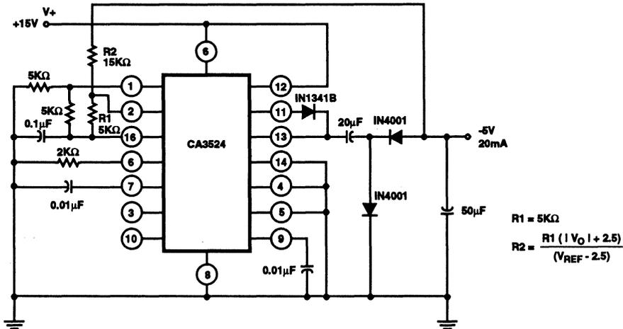
FIGURE 35. CAPACITOR DIODE OUTPUT CIRCUIT
