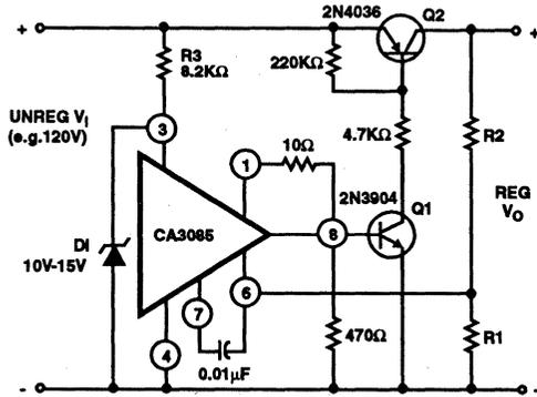
FIGURE 9. HIGH VOLTAGE REGULATOR
