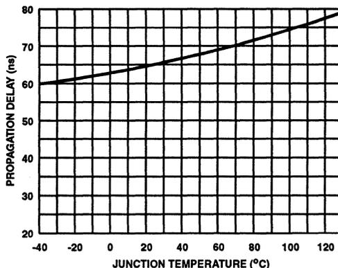
FIGURE 17. UPPER TURN-ON PROPAGATION DELAY  $T_{HPLH}$  vs TEMPERATURE
