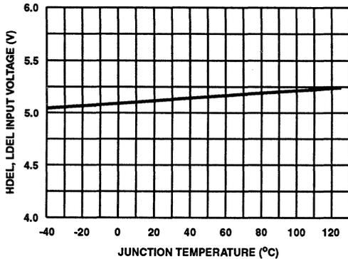
FIGURE 24.  $V_{LDEL}$ ,  $V_{HDEL}$  VOLTAGE vs TEMPERATURE
