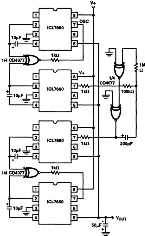
FIGURE 15. SYNCHRONIZING A QUAD
