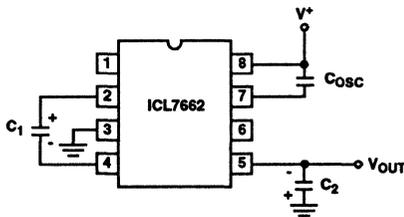
FIGURE 21. LOWERING OSCILLATOR FREQUENCY
