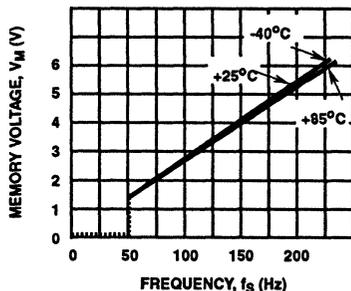
FIGURE 4. TYPICAL D/A MEMORY VOLTAGE,  $V_M$  vs FREQUENCY
