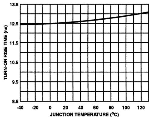
FIGURE 21. GATE DRIVE RISE TIME  $T_R$  vs TEMPERATURE
