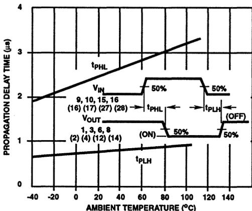
FIGURE 4C. TYPICAL PROPAGATION DELAY TIME CHARACTERISTICS
