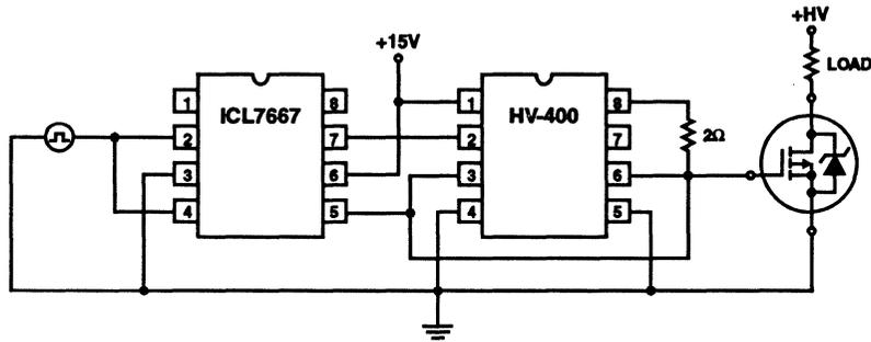
FIGURE 2. LOGIC LEVEL CIRCUIT
