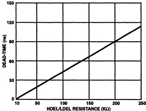
FIGURE 5. MINIMUM DEAD-TIME vs DEL RESISTANCE
