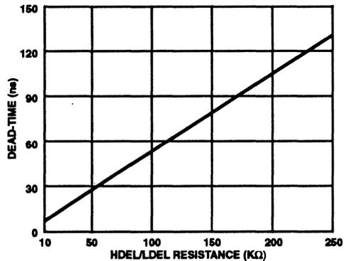
FIGURE 3. MINIMUM DEAD-TIME vs DEL RESISTANCE
