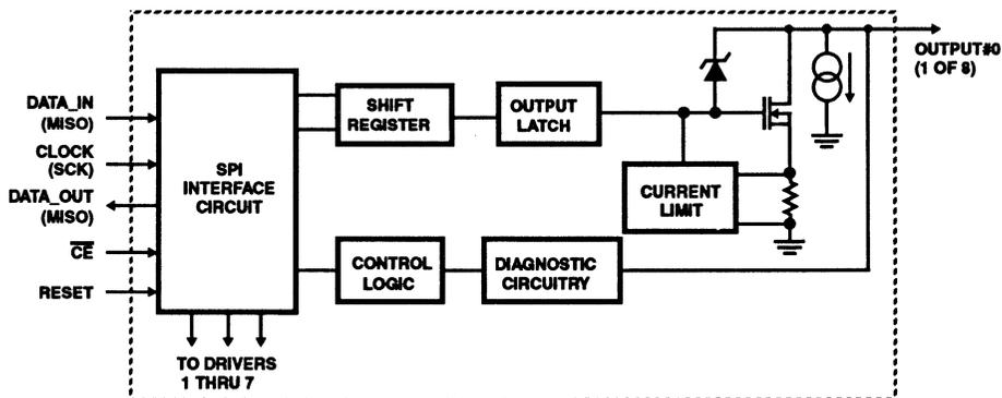
FIGURE 7. CA3282 BLOCK DIAGRAM FOR ONE OF EIGHT DRIVER STAGES
