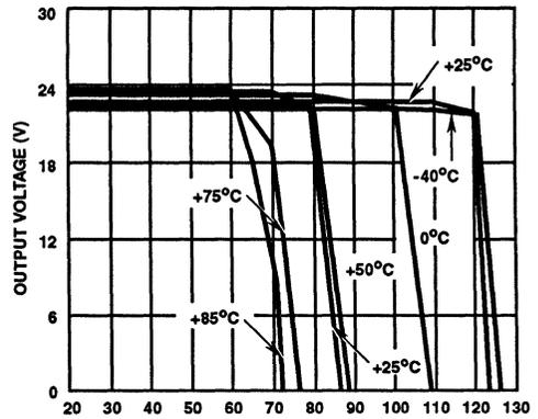
FIGURE 24. OUTPUT CURRENT LIMIT (24V<sub>OUT</sub>) 50Hz
