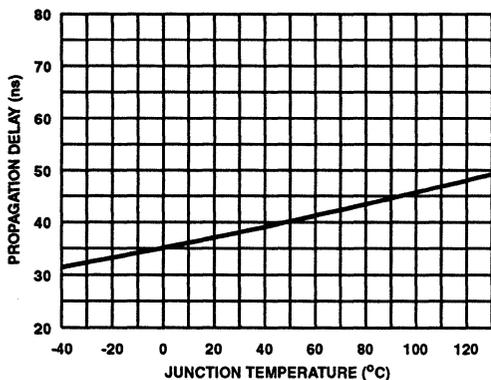
FIGURE 16. UPPER TURN-OFF PROPAGATION DELAY  $T_{HPHL}$  vs TEMPERATURE
