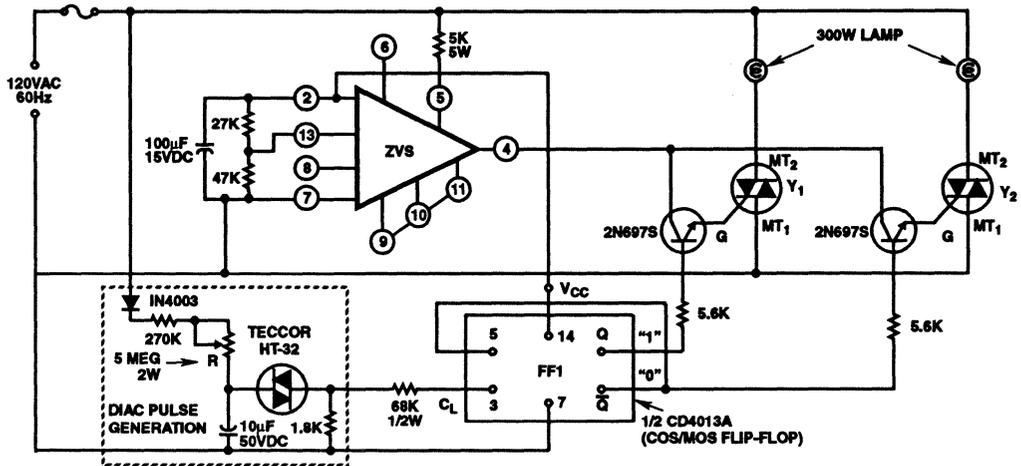
**FIGURE 49. SYNCHRONOUS SWITCHING TRAFFIC FLASHER**
