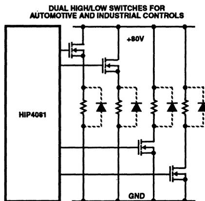
FIGURE 2. HIP4081 AS LAMP SWITCH DRIVER
