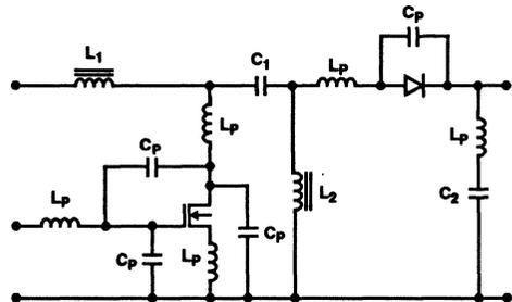
FIGURE 5. TYPICAL PARASITIC COMPONENTS
