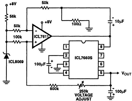
FIGURE 23. REGULATING THE OUTPUT VOLTAGE
