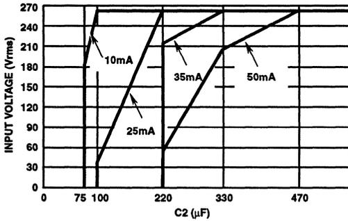
FIGURE 19. MINIMUM C2 VALUE vs INPUT VOLTAGE 50Hz
