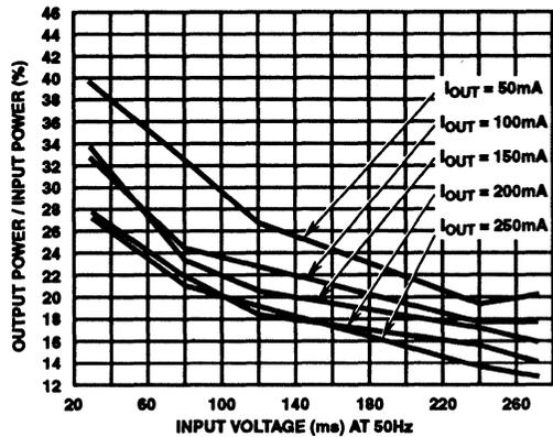
FIGURE 14. EFFICIENCY OF HV-2405E HIGH CURRENT CIRCUIT 5V
