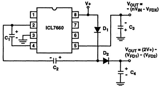
FIGURE 20. COMBINED NEGATIVE VOLTAGE CONVERTER AND POSITIVE DOUBLER
