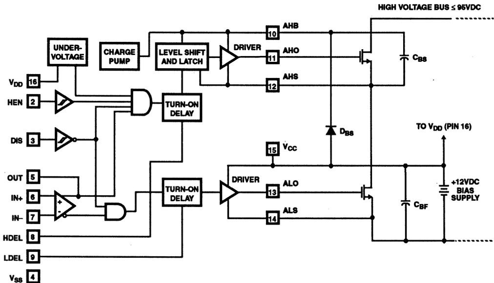
FIGURE 4. HIP4080A BLOCK DIAGRAM
