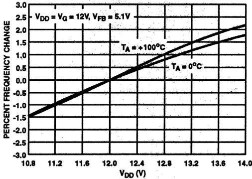
FIGURE 21. TYPICAL CLOCK FREQUENCY PERCENT CHANGE vs SUPPLY VOLTAGE V<sub>DD</sub> AT 0°C AND +100°C
