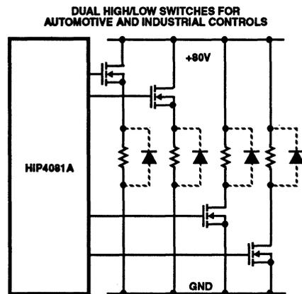
FIGURE 2. HIP4081A AS LAMP SWITCH DRIVER
