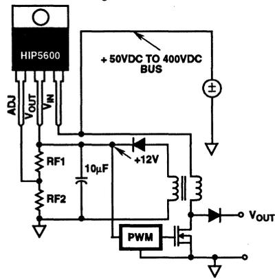
FIGURE 14. START UP CIRCUIT
