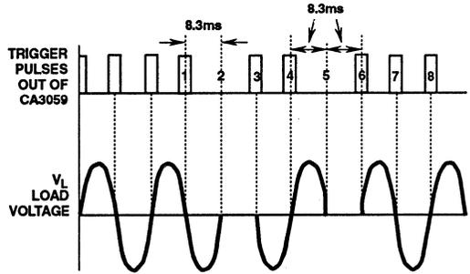
**FIGURE 10. HALF CYCLING PHENOMENON IN THE ZERO-VOLTAGE SWITCH**
