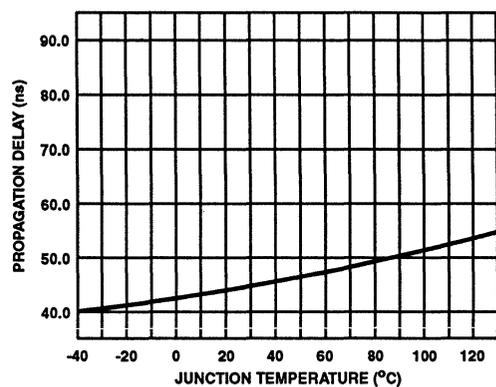
FIGURE 21. LOWER TURN-ON PROPAGATION DELAY  $T_{LPLH}$  vs TEMPERATURE
