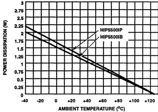
FIGURE 21. MAXIMUM POWER DISSIPATION vs TEMPERATURE
