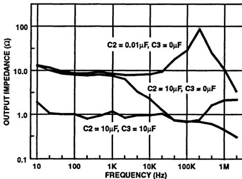
FIGURE 27. OUTPUT IMPEDANCE
