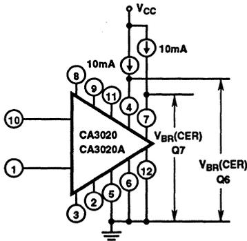
FIGURE 1A. COLLECTOR-TO-EMITTER BREAKDOWN VOLTAGE (Q6 AND Q7) CIRCUIT
