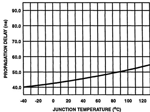
FIGURE 21. LOWER TURN-ON PROPAGATION DELAY  $T_{LPLH}$  vs TEMPERATURE
