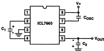
FIGURE 18. LOWERING OSCILLATOR FREQUENCY
