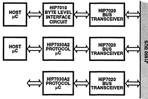
FIGURE 4. TYPICAL J1850 SYSTEM CONFIGURATIONS
