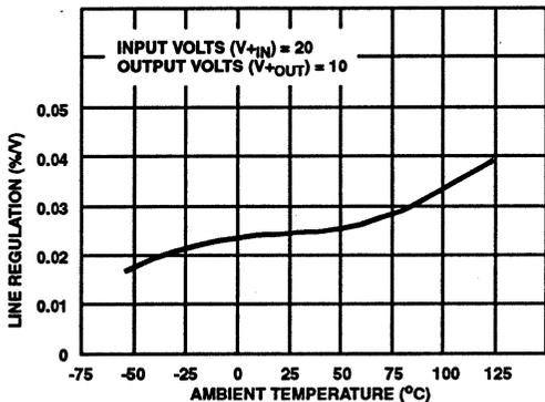
FIGURE 9. LINE REGULATION TEMPERATURE CHARACTERISTICS
