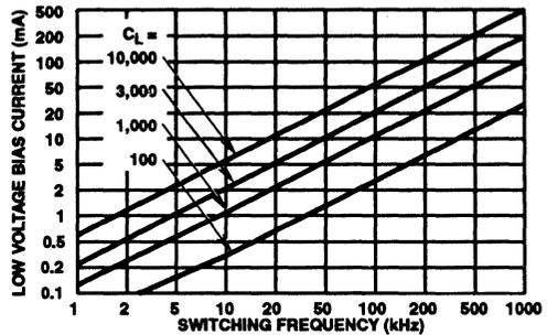
FIGURE 9. LOW VOLTAGE BIAS CURRENT vs FREQUENCY AND LOAD CAPACITANCE
