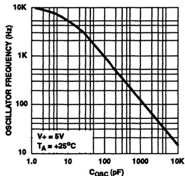
FIGURE 11. FREQUENCY VARIATION WITH OSCILLATOR CAPACITANCE
