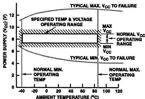
FIGURE 21.  $V_{CC}$  OPERATING RANGE OF THE CA3228E
