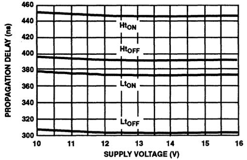
FIGURE 14. PROPAGATION DELAY vs SUPPLY VOLTAGE
