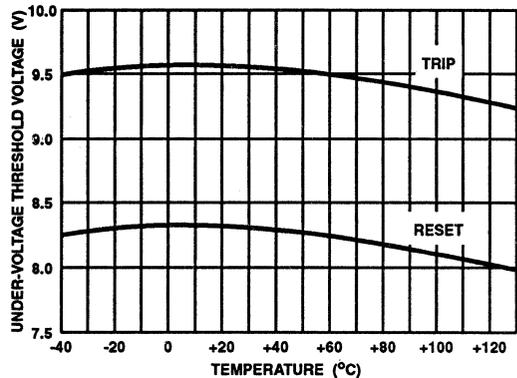
FIGURE 15. HIGH-SIDE UNDERVOLTAGE THRESHOLD VOLTAGE (TRIP/RESET) vs TEMPERATURE
