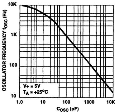
FIGURE 5. FREQUENCY OF OSCILLATION AS A FUNCTION OF EXTERNAL OSC. CAPACITANCE
