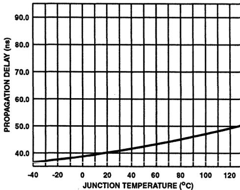
FIGURE 20. LOWER TURN-OFF PROPAGATION DELAY  $T_{LPHL}$  vs TEMPERATURE
