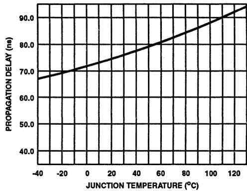
FIGURE 19. UPPER TURN-ON PROPAGATION DELAY  $T_{HPLH}$  vs TEMPERATURE
