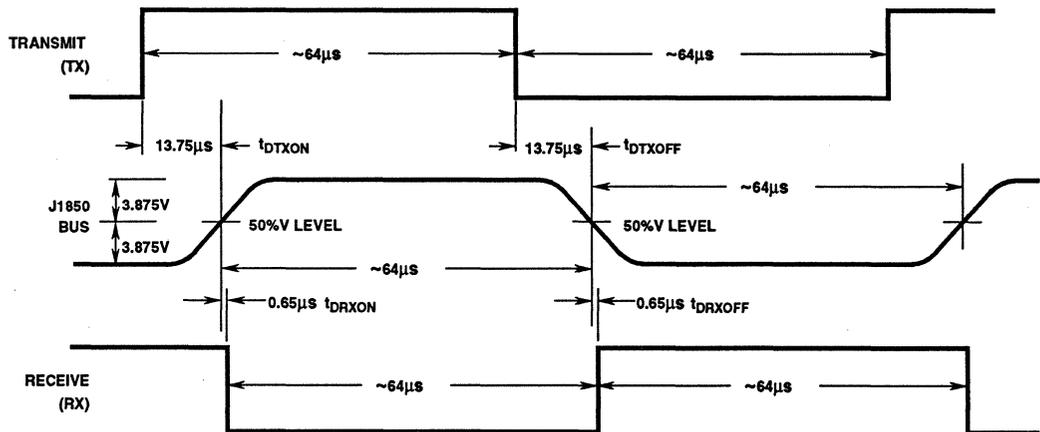
FIGURE 2. PROPAGATION TIME DELAYS
