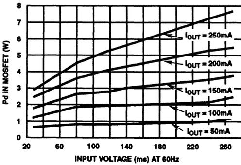
FIGURE 11. MOSFET POWER DISSIPATION 24V
