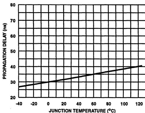
FIGURE 18. LOWER TURN-OFF PROPAGATION DELAY  $T_{LPHL}$  vs TEMPERATURE
