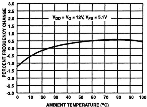
FIGURE 20. TYPICAL CLOCK FREQUENCY PERCENT CHANGE vs TEMPERATURE
