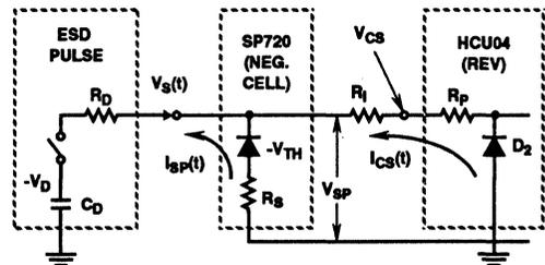
FIGURE 13A. NEGATIVE ESD DISCHARGE MODEL
