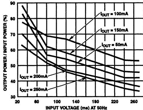
FIGURE 16. EFFICIENCY OF HV-2405E HIGH CURRENT CIRCUIT 24V
