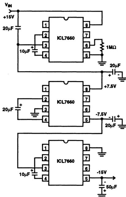
FIGURE 21. +15V TO -15V IN THREE EASY STAGES
