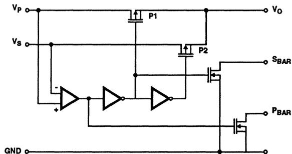
$V_p > V_s$ , P1 SWITCH ON AND P<sub>BAR</sub> SWITCH ON
