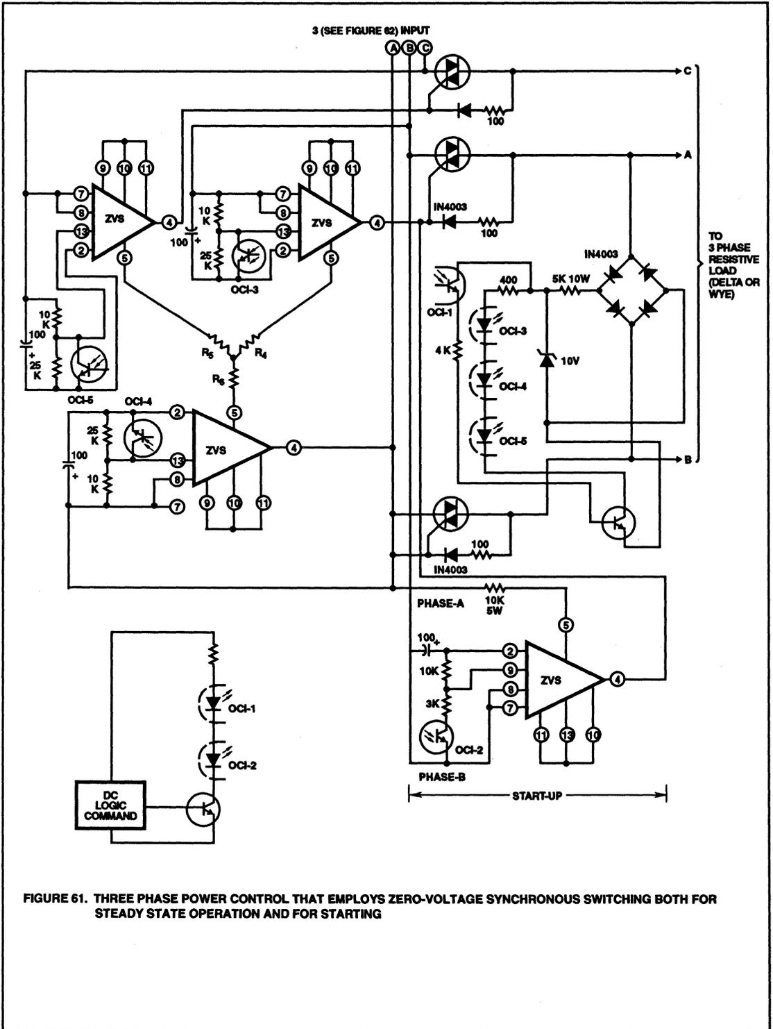
FIGURE 61. THREE PHASE POWER CONTROL THAT EMPLOYS ZERO-VOLTAGE SYNCHRONOUS SWITCHING BOTH FOR STEADY STATE OPERATION AND FOR STARTING
