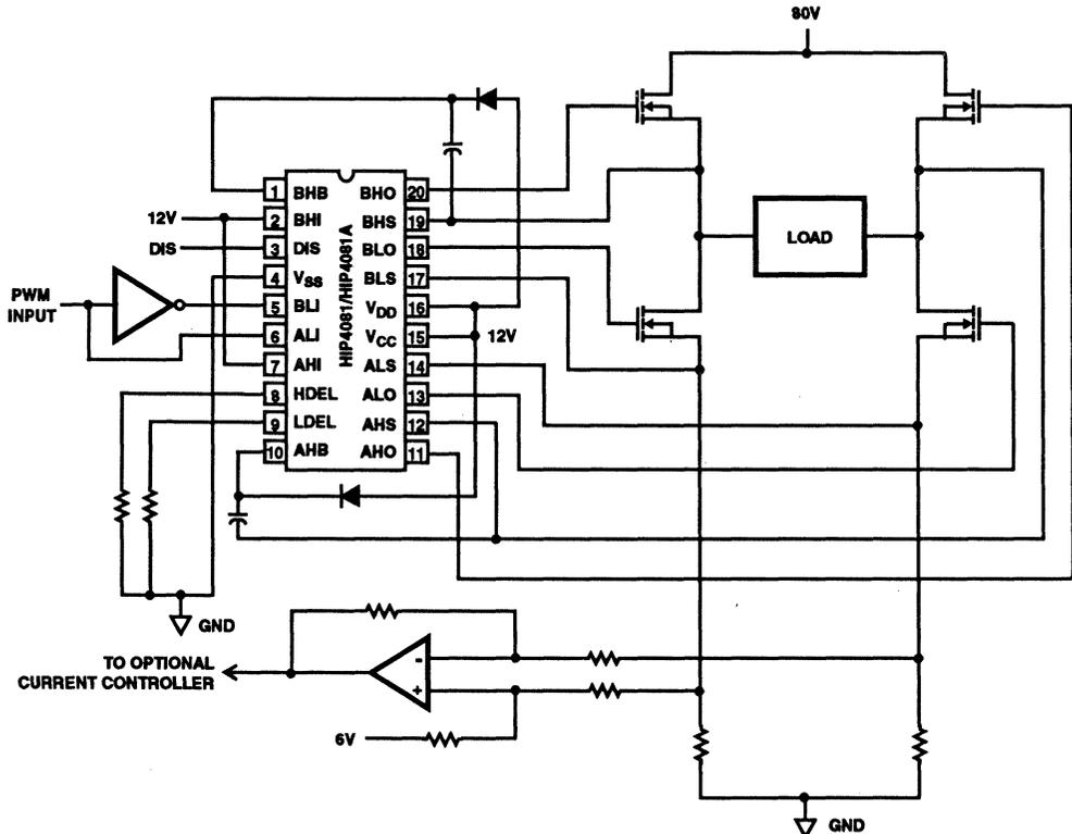
FIGURE 5. TYPICAL APPLICATION (PWM MODE SWITCHING)
