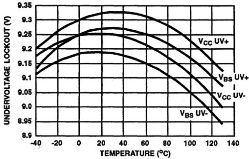
FIGURE 7. UNDERVOLTAGE LOCKOUT vs TEMPERATURE
