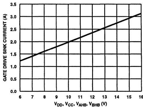
FIGURE 27. PEAK PULLDOWN CURRENT  $I_O$  vs BIAS SUPPLY VOLTAGE
