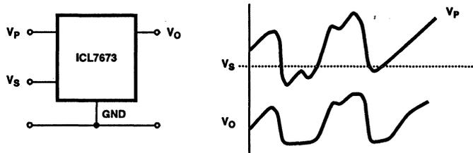
FIGURE 14. CLIPPING CIRCUITS
