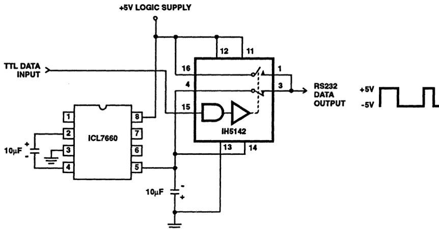
FIGURE 23. RS232 LEVELS FROM A SINGLE 5V SUPPLY
