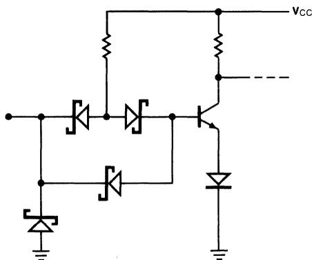
Fig. 2-8 Diode Cluster Input
