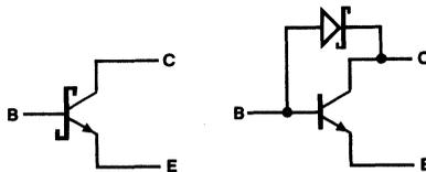
**Fig. 2-1 Schottky Transistor**
