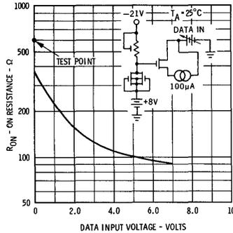
ON RESISTANCE VERSUS DATA INPUT VOLTAGE (37002FC ONLY)
