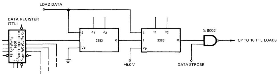
Fig. 3 SHIFT REGISTER INTERFACE
