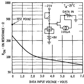
ON RESISTANCE VERSUS DATA INPUT VOLTAGE (37002FM ONLY)
