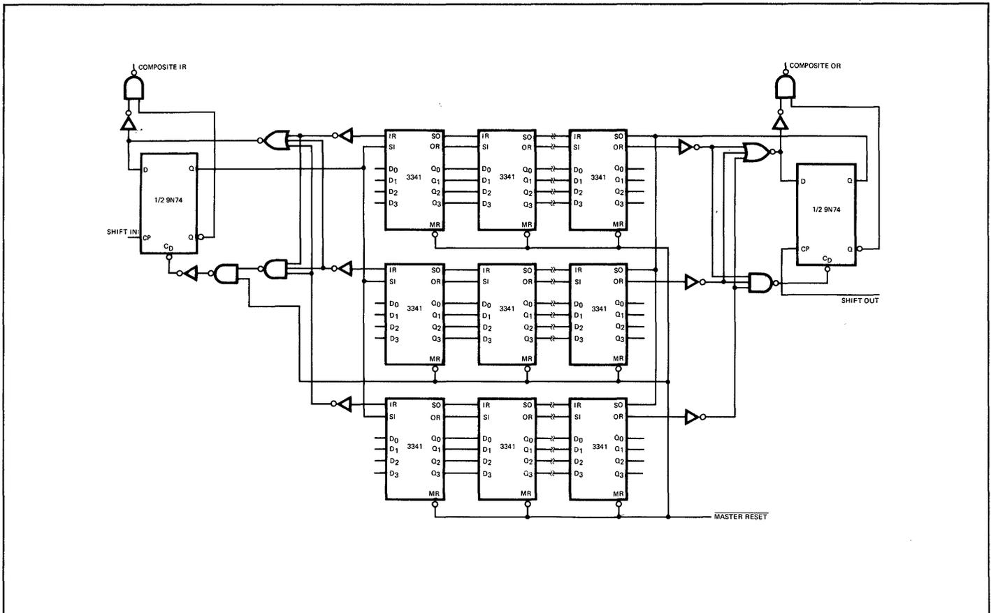
Figure 9. Positive Edge Triggering
