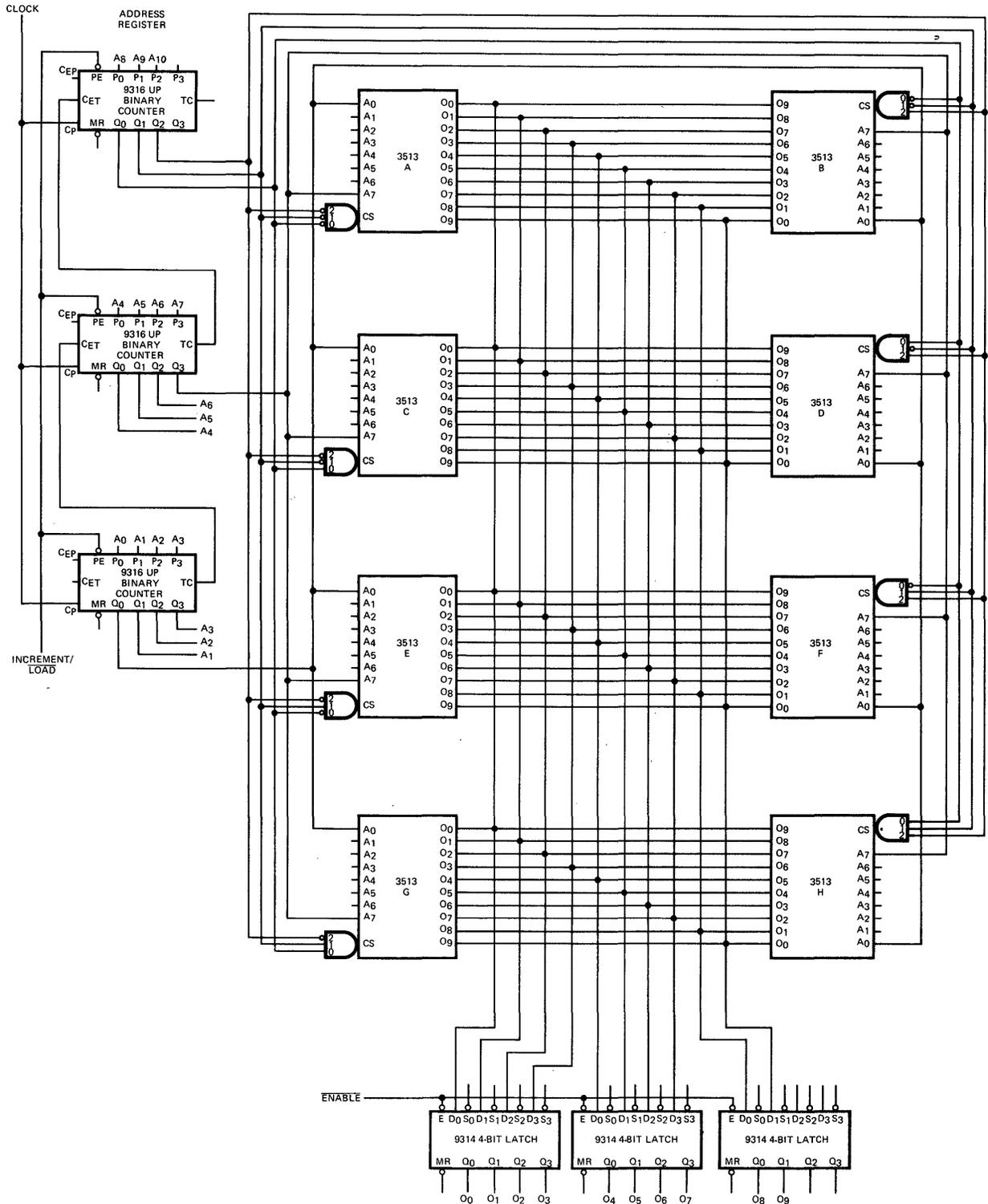
Fig. 10. 2K BY 10-BIT READ ONLY MEMORY SYSTEM
