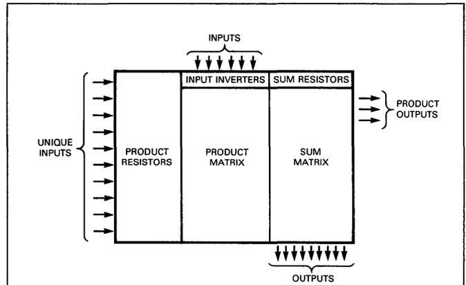
Fig. D-6. CLM Block Diagram
