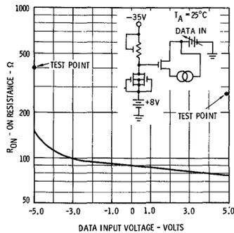
ON RESISTANCE VERSUS DATA INPUT VOLTAGE (37003FC ONLY)
