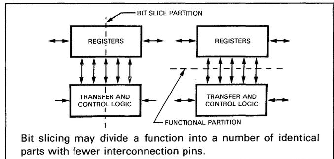
Fig. D-3. Bit Slicing
