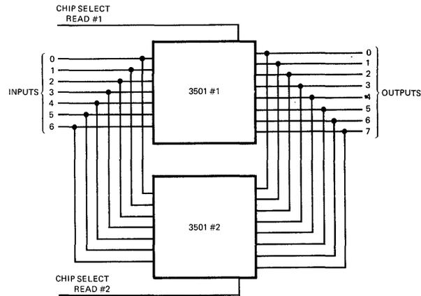
Fig. 2 — TYPICAL EXPANDED MEMORY
