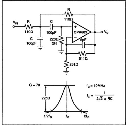
FIGURE 10. Bandpass Filter — 10MHz.
