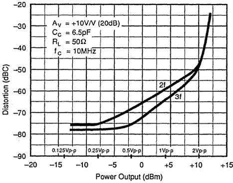
20MHz HARMONIC DISTORTION vs POWER OUTPUT
