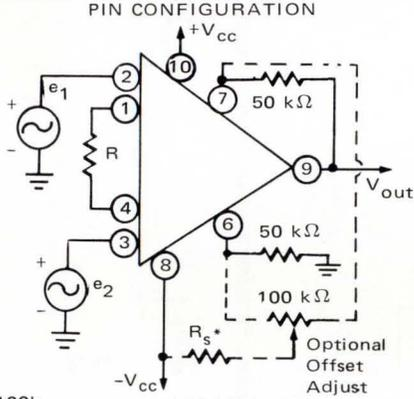
$$V_{out} = \frac{100k}{R} (e_2 - e_1) \quad *50\text{ k}\Omega\ 3660K, S \quad 0\ \Omega\ 3660J, 3670J, K, S$$
